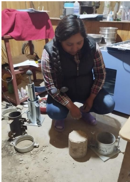
Figura 17. Muestra con dosificación con cal y zeolita compactada
