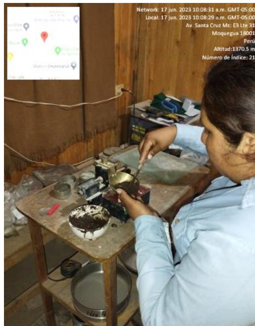
Figura 12. Colocación de la muestra en la Copa de Casagrande
