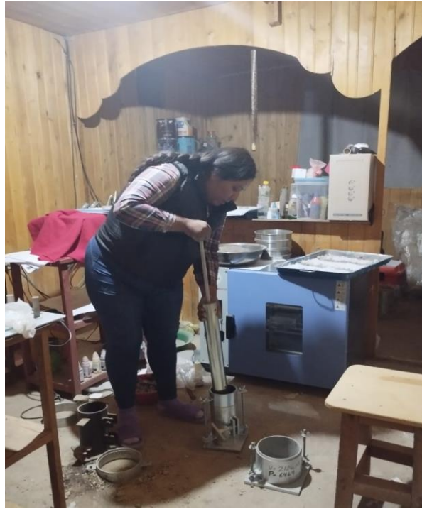
Figura 16. Compactado con el pisón
