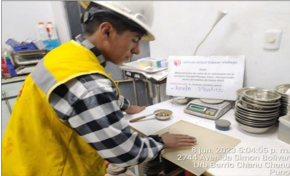
**Figura 21.** Ensayo de limite plástico
