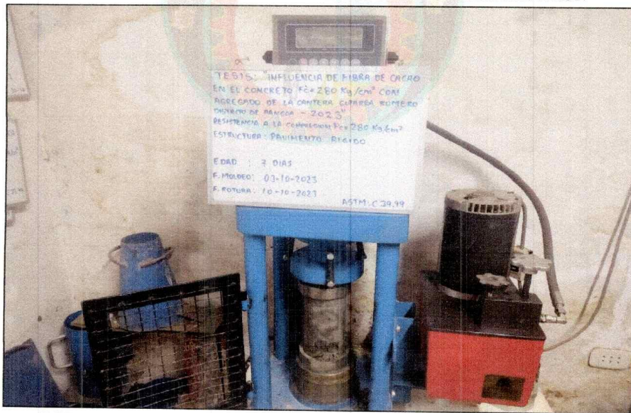
ROTURA DE LA PROBETA 001 DE LA ESTRUCTURA: MUESTRA PATRON, RESISTENCIA A LA COMPRESION F'C=280 KG/CM2
