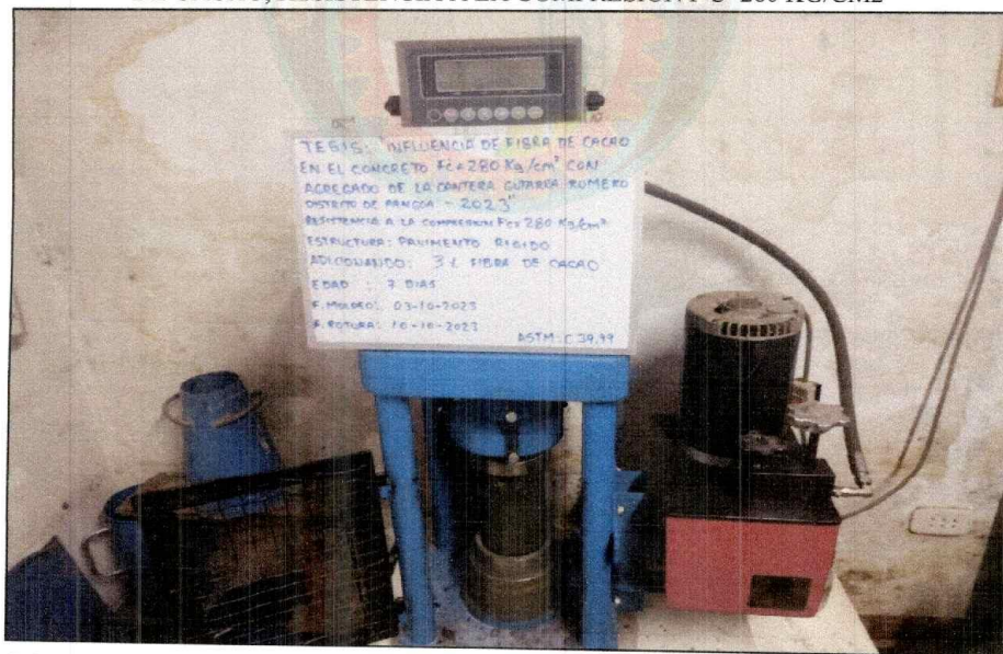
ROTURA DE LA PROBETA 001 DE LA ESTRUCTURA: ADICIONANDO 3% DE FIBRA DE CACAO, RESISTENCIA A LA COMPRESION F'C=280 KG/CM2
