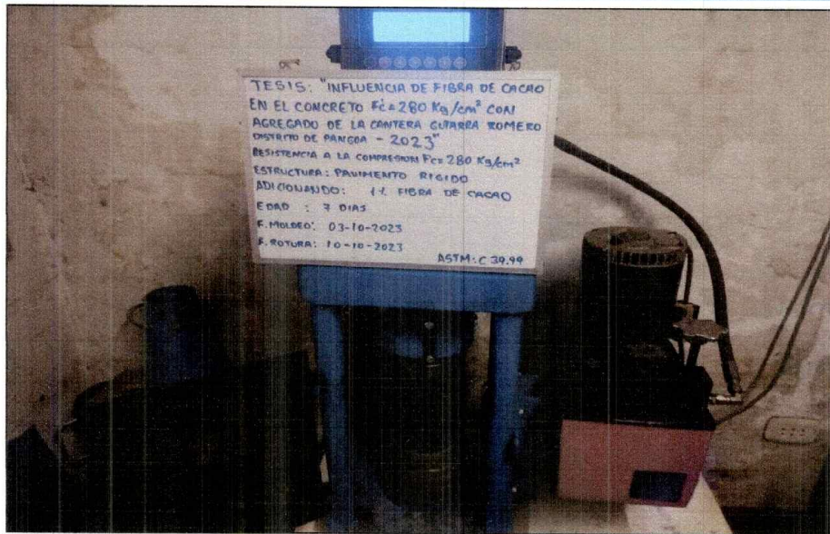
ROTURA DE LA PROBETA 001 DE LA ESTRUCTURA: ADICIONANDO 1% DE FIBRA DE CACAO, RESISTENCIA A LA COMPRESION F'C=280 KG/CM2
