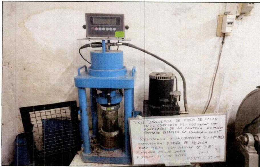
ROTURA DE LA PROBETA 004 DE LA ESTRUCTURA: ADICIONANDO 3% DE FIBRA DE CACAO, RESISTENCIA A LA COMPRESION F'C=280 KG/CM 2
