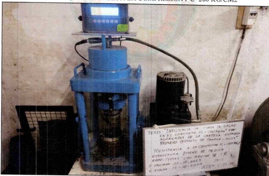
ROTURA DE LA PROBETA 005 DE LA ESTRUCTURA: ADICIONANDO 1% DE FIBRA DE CACAO, RESISTENCIA A LA COMPRESION F'C=280 KG/CM2
