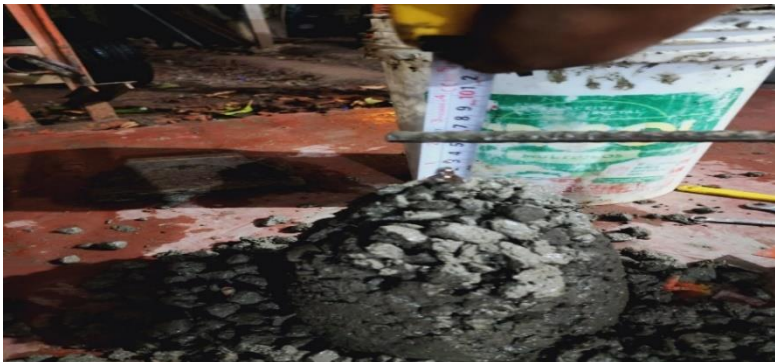
Figura 9. Ensayo de Slump
