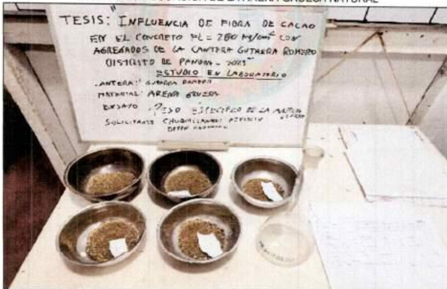
ENSAYO DE PESO ESPECIFICO DE LA ARENA GRUESA NATURAL
