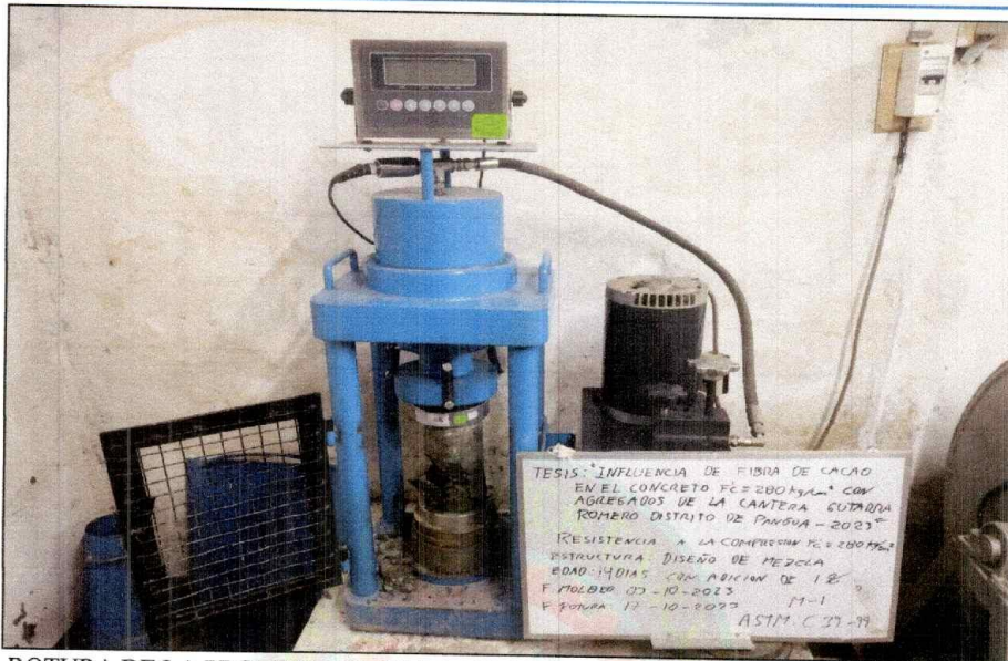
ROTURA DE LA PROBETA 004 DE LA ESTRUCTURA: ADICIONANDO 1% DE FIBRA DE CACAO, RESISTENCIA A LA COMPRESION F'C=280 KG/CM2
