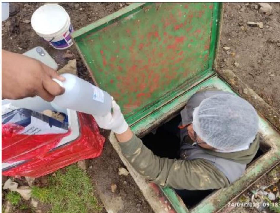
**Fotografía 4.** Muestreo para ensayos físico químico y bacteriológico del agua
