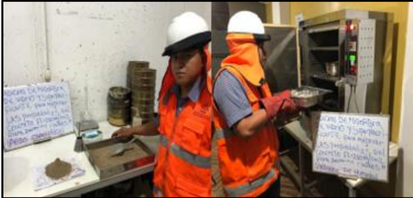
Fotografía 4. Absorción del agregado fino y grueso
