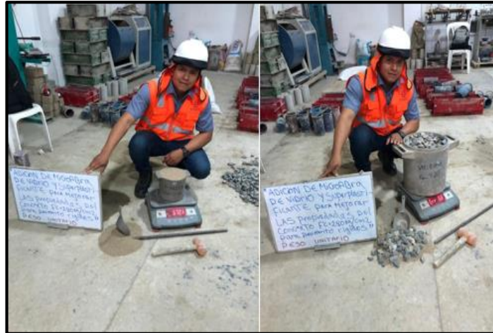
Figura 9. Peso unitario compactado de los materiales
