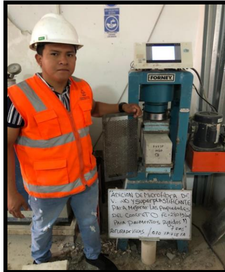
Figura 17. Prueba de resistencia a flexión
