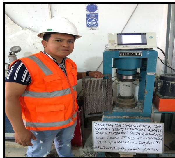
Figura 16. Ensayo de resistencia a la compresión
