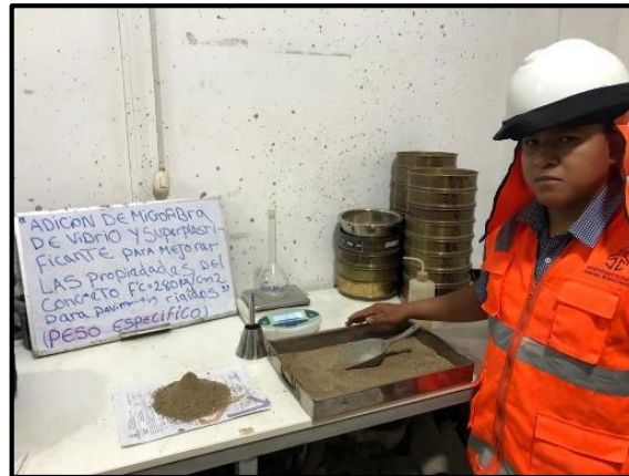
Figura 11. Absorción y peso específico del agregado fino
