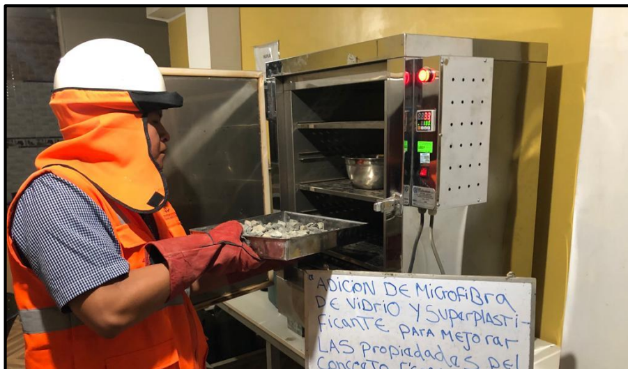
Figura 10. Absorción y peso específico del agregado grueso
