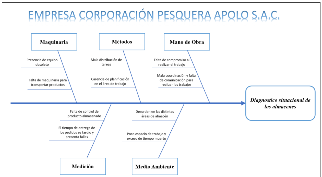
Figura 1 Diagrama de Ishikawa sobre el diagnóstico situacional de los almacenes de productos terminados
