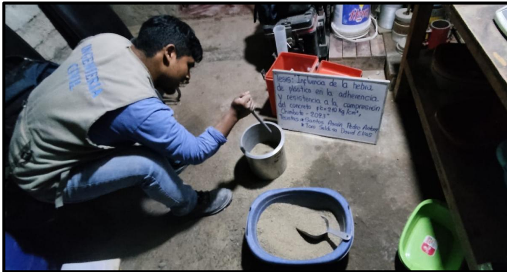
FOTO N°6: PESO UNITARIO SUELTO Y COMPACTADO DEL AGREGADO FINO
