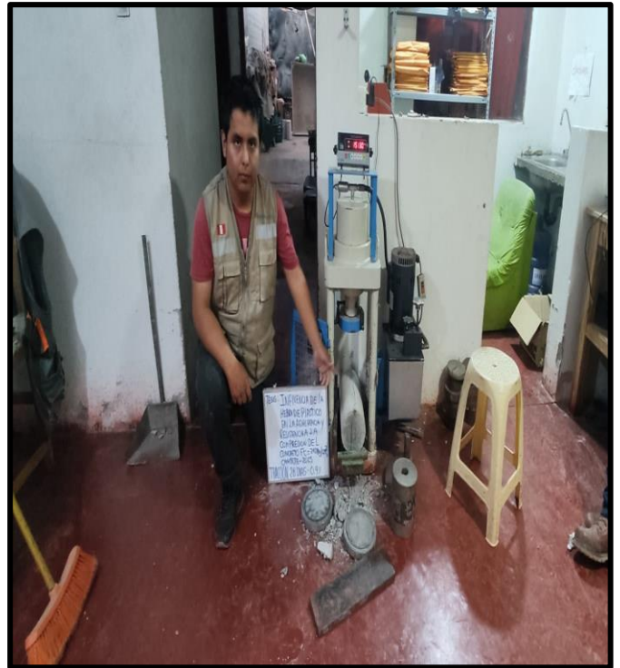
FOTO N°1: ROTURA DE PROBETAS DE ENSAYO A TRACCIÓN DIRECTA A LOS 28 DÍAS DE CURADO DEL CONCRETO PATRÓN Y CON ADICIÓN DEL 0.9%, 1.5% Y 2.5%
