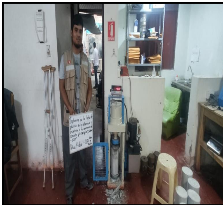
FOTO N°13: ROTURA DE PROBETAS DE ENSAYO A COMPRESIÓN A LOS 14 DIAS DE CURADO DEL CONCRETO PATRÓN Y CON ADICIÓN DEL 0.9%, 1.5% Y 2.5%
