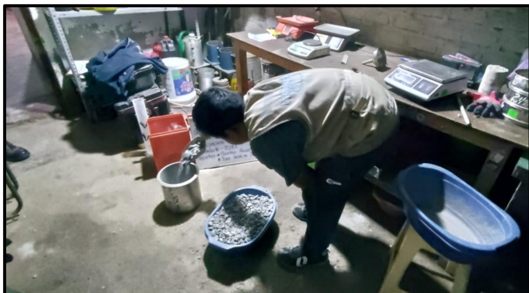
FOTO N°7: PESO UNITARIO SUELTO Y COMPACTADO DEL AGREGADO GRUESO
