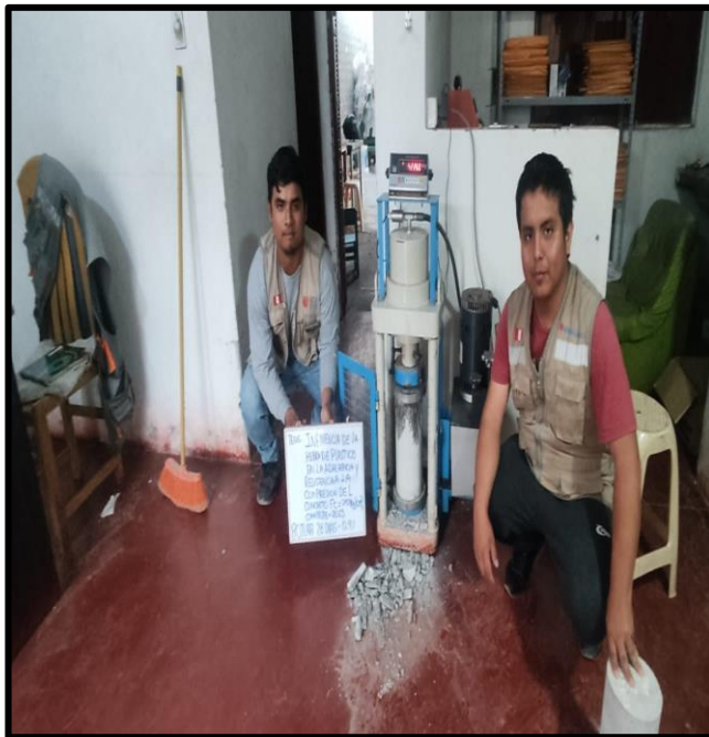
FOTO N°14: ROTURA DE PROBETAS DE ENSAYO A COMPRESIÓN A LOS 28 DIAS DE CURADO DEL CONCRETO PATRÓN Y CON ADICIÓN DEL 0.9%, 1.5% Y 2.5%
