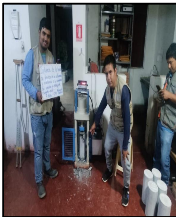
FOTO N°12: ROTURA DE PROBETAS DE ENSAYO A COMPRESIÓN A LOS 7 DÍAS DE CURADO DEL CONCRETO PATRÓN Y CON ADICIÓN DEL 0.9%, 1.5% Y 2.5%
