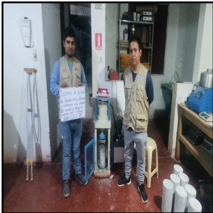
FOTO N°12: ROTURA DE PROBETAS DE ENSAYO A COMPRESIÓN A LOS 7 DÍAS DE CURADO DEL CONCRETO PATRÓN Y CON ADICIÓN DEL 0.9%, 1.5% Y 2.5%
