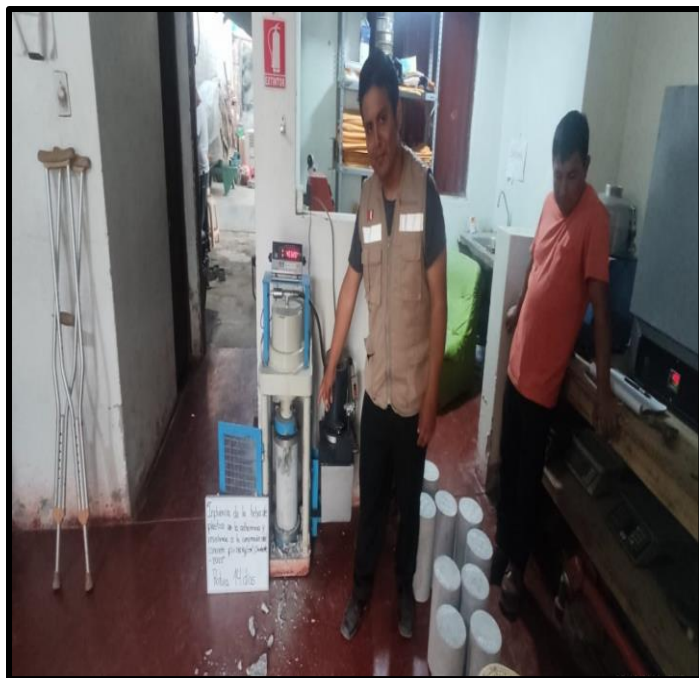
FOTO N°13: ROTURA DE PROBETAS DE ENSAYO A COMPRESIÓN A LOS 14 DIAS DE CURADO DEL CONCRETO PATRÓN Y CON ADICIÓN DEL 0.9%, 1.5% Y 2.5%
