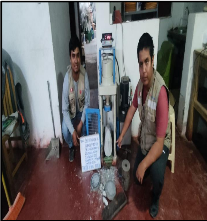
FOTO N°1: ROTURA DE PROBETAS DE ENSAYO A TRACCIÓN DIRECTA A LOS 28 DÍAS DE CURADO DEL CONCRETO PATRÓN Y CON ADICIÓN DEL 0.9%, 1.5% Y 2.5%
