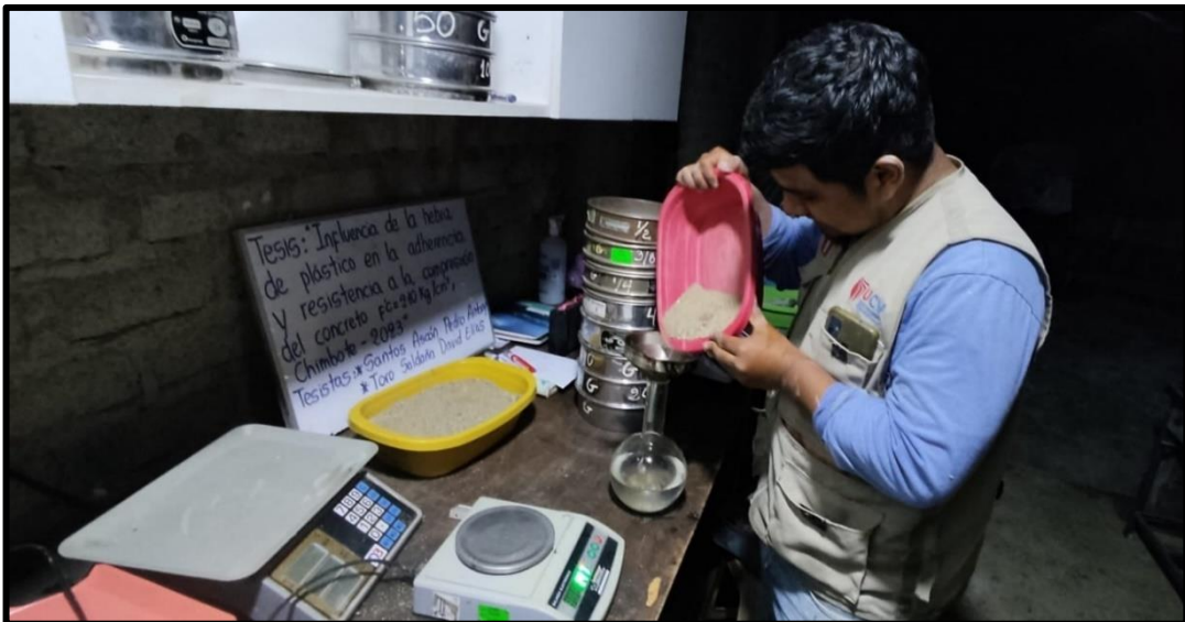
FOTO N°8: ENSAYO DEL PESO ESPECIFICO DEL AGREGADO FINO CON LA FIOLA
