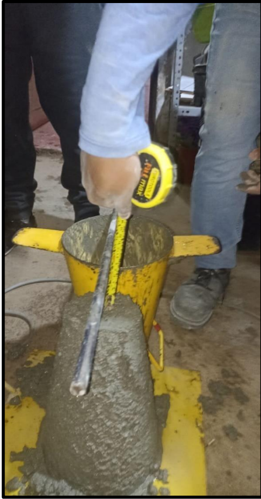
FOTO N°10: ENSAYO DE SLUMP
