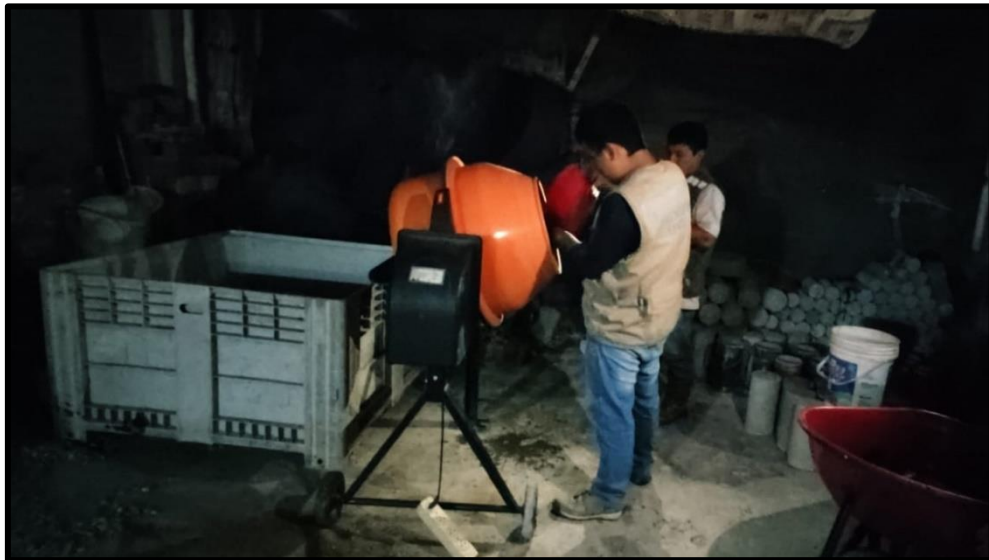
FOTO N°9: ELABORACIÓN DE PROBETAS DE CONCRETO PATRON Y CON ADICIÓN DEL 0.9%, 1.5% Y 2.5% DE HEBRA DE PLÁSTICO
