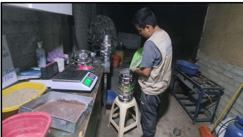
FOTO N°5: ANÁLISIS GRANULOMÉTRICO DEL AGREGADO GRUESO
