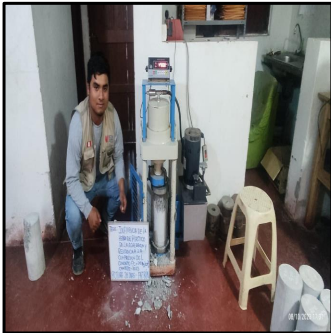
FOTO N°14: ROTURA DE PROBETAS DE ENSAYO A COMPRESIÓN A LOS 28 DIAS DE CURADO DEL CONCRETO PATRÓN Y CON ADICIÓN DEL 0.9%, 1.5% Y 2.5%
