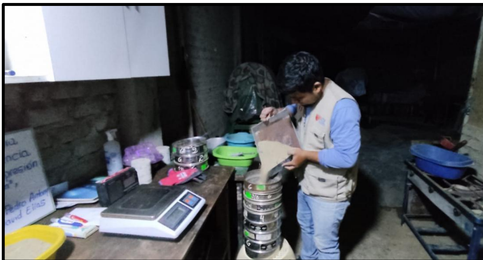
FOTO N°4: ANÁLISIS GRANULOMÉTRICO DEL AGREGADO FINO
