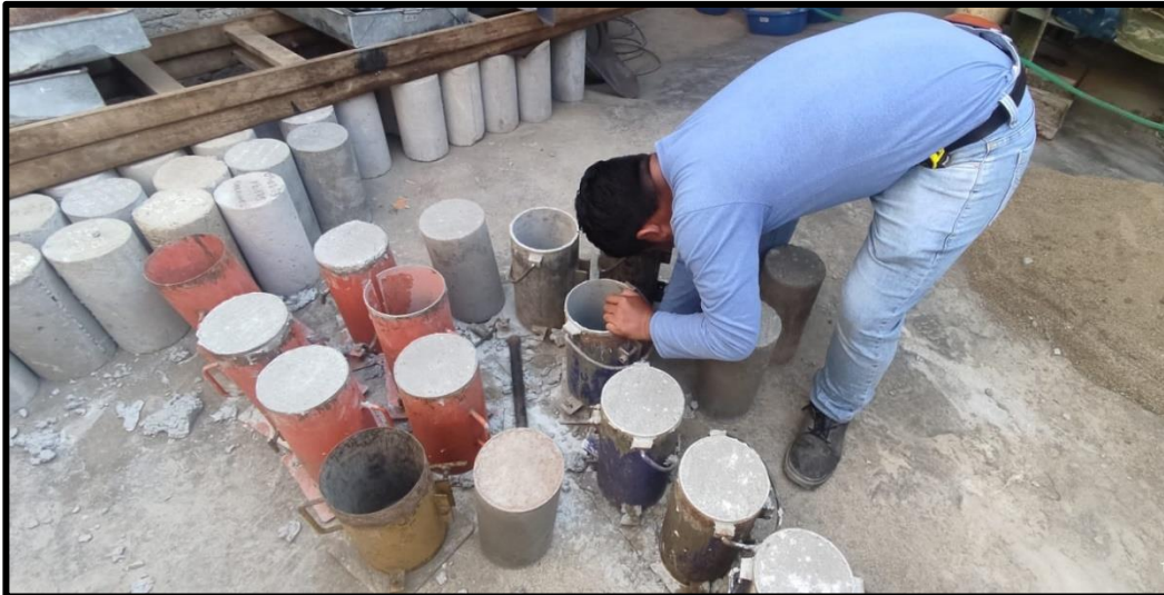
FOTO N°11: CURADO DE LAS PROBETAS
