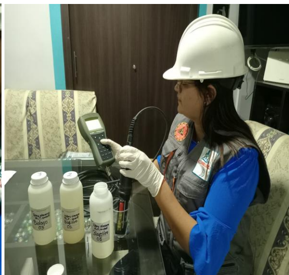
Anexo 28: Medición de los indicadores como temperatura, pH y CE del tratamiento con ozono.
