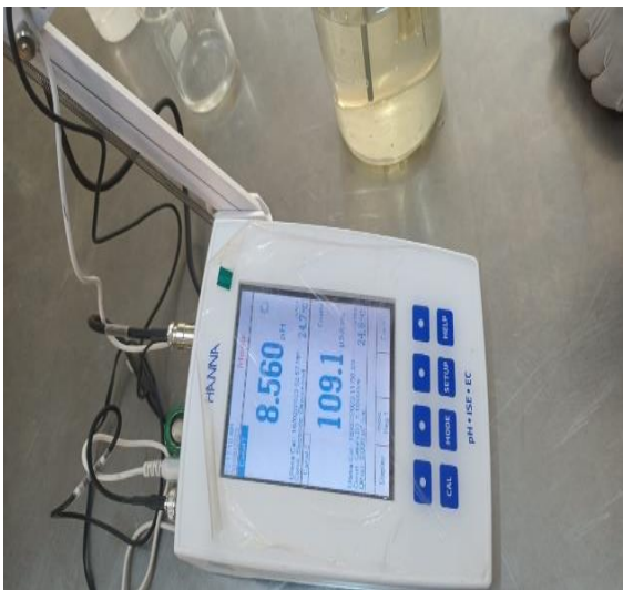
Anexo 28: Medición de los indicadores como temperatura, pH y CE del tratamiento con ozono.
