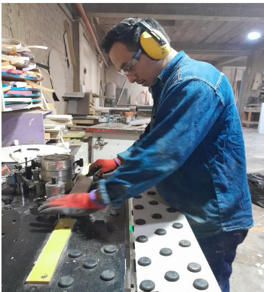
Operario realizando el canteado.
