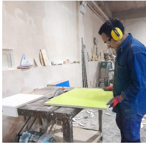
Operario realizando el boleado a la pieza de melamina.
