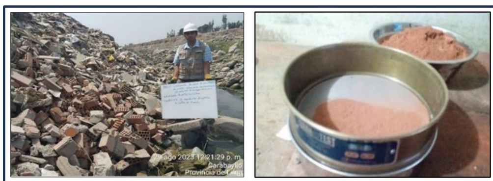
Figura 5. Recolección y tamizado de polvo de ladrillo Fuente: Autoría propia
