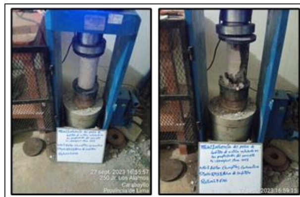
Figura 13. Ensayo de Resistencia a compresión Fuente: Autoría propia
