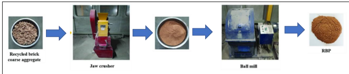
Figura 2. Proceso de trituración del ladrillo reciclado Fuente: Chao Liu (2021, p4) 29
