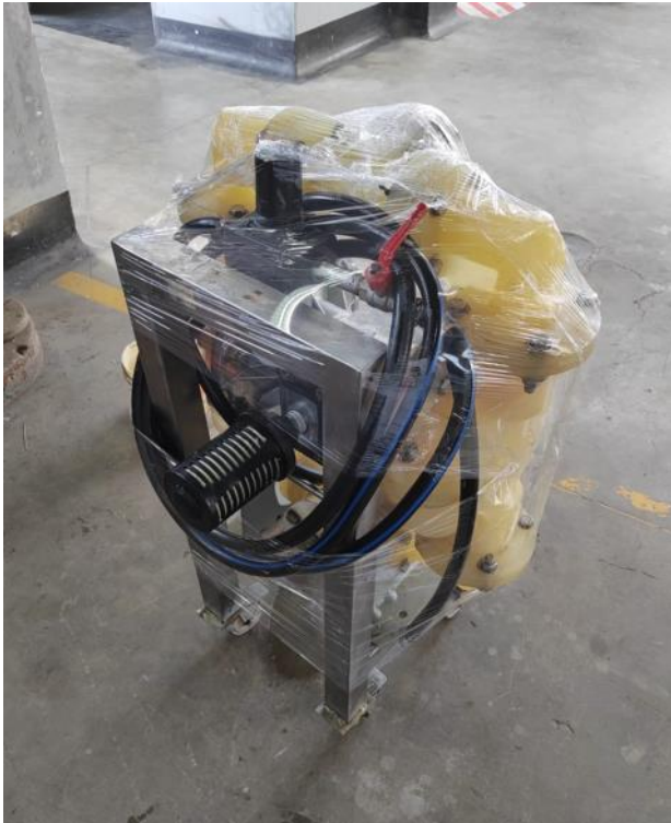
Bomba de trasiego refaccionada
