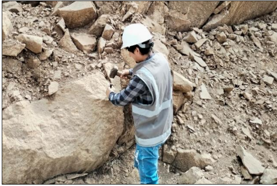
Figura 7. Extracción de muestras de roca del talud 3
