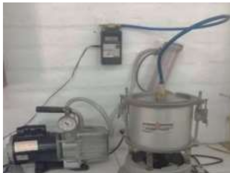
Figura 28. Ensayo para hallar el porcentaje de vacíos con aire.
