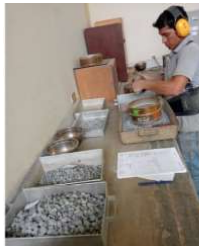
Fotografía 16: Proceso de tamizados de los agregados finos y gruesos
