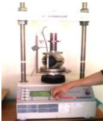
Figura 24. Ensayo de Marshall.
