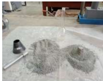
Fotografía 20: Proceso de compactación con el martillo Humboldt.
