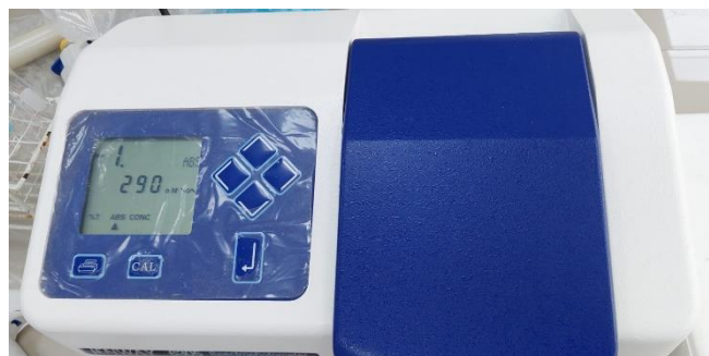
Realizando las lecturas por Espectrofotometría UV-Vis a 290 nm.
