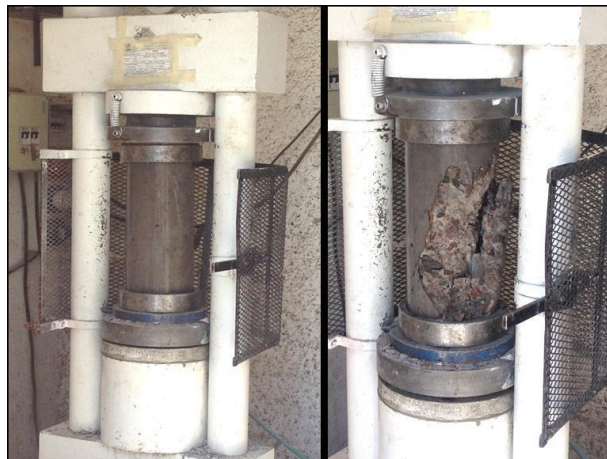
Figura 5. Resistencia a la compresión
