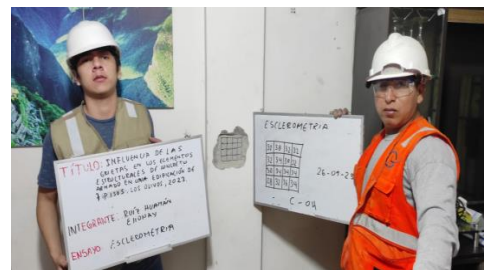
Figura 28. Valores obtenidos de los rebotes en la columna-04
