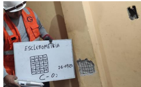
Figura 26. Valores obtenidos de los rebotes en la columna-02
