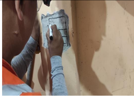
Figura 22. Detallando los puntos de rebotes
