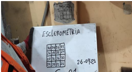
Figura 25. Valores obtenidos de los rebotes en la columna-01
