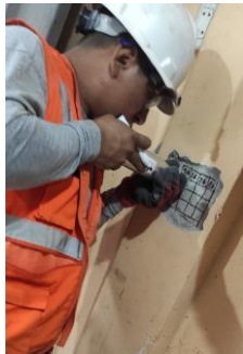
Figura 23. Realizando los rebotes con el equipo
