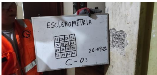
Figura 27. Valores obtenidos de los rebotes en la columna-03
