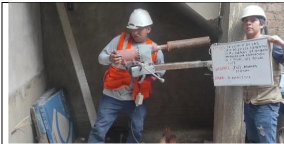
Figura 14. Preparación del equipo para empezar con el ensayo de diamantina
