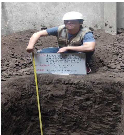
Figura 32. Terminación de la excavación de la calicata, luego se llevó la muestra de 30kg de tierra a laboratorio para realizar los estudios requeridos para saber el tipo de suelo.
