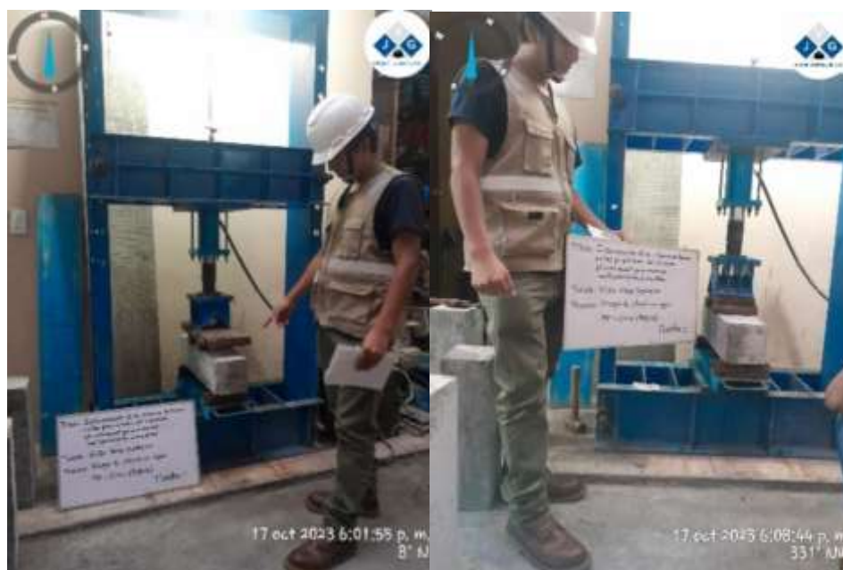
Figura 22. Ensayo de flexión en vigas
