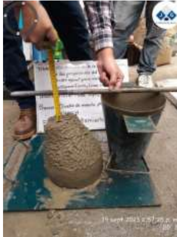
Figura 17. Ensayo de asentamiento (Slump)
