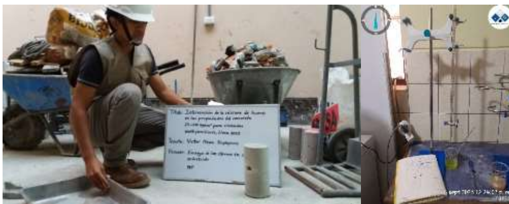
Figura 24. Ensayo de determinación de ion cloruro en concreto endurecido
