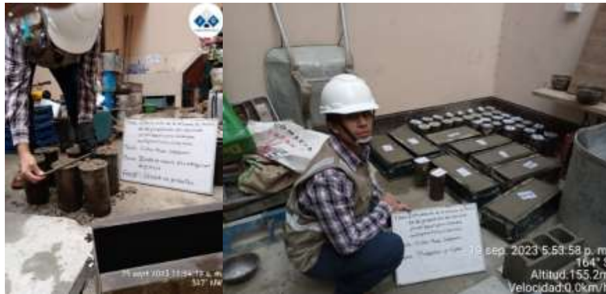
Figura 18. Llenado de probetas y vigas en moldes
