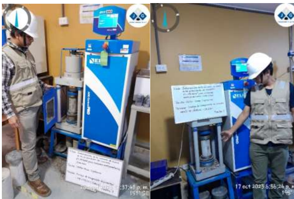
Figura 20. Ensayo de compresión de probetas
