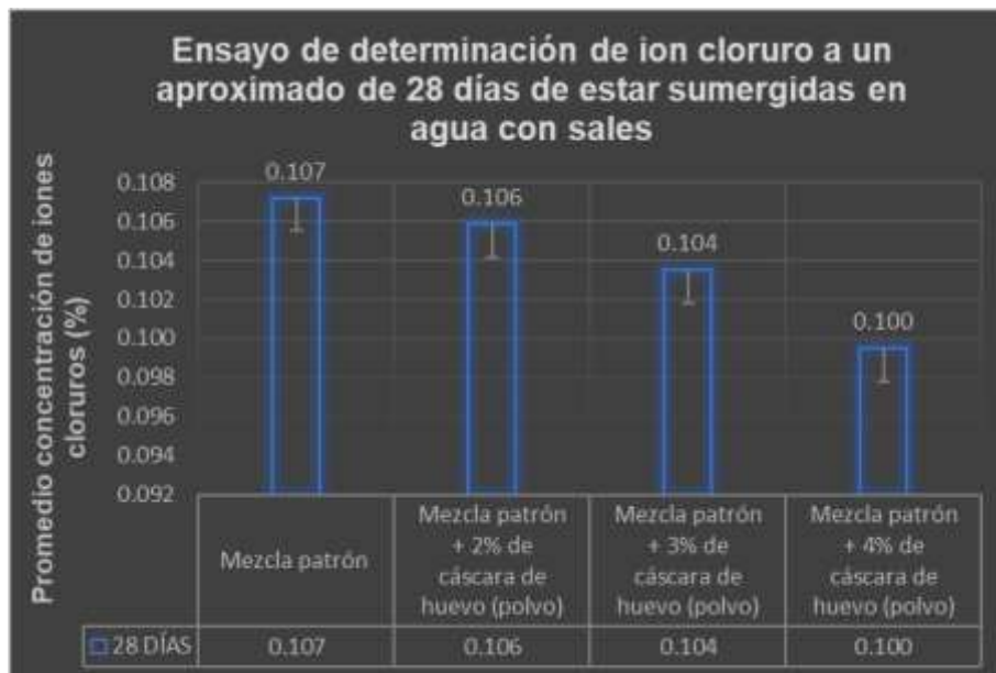
Figura 26. Ensayo de determinación de ion cloruro a un aproximado de 28 días de estar sumergidas en agua con sales (Gráfico)
