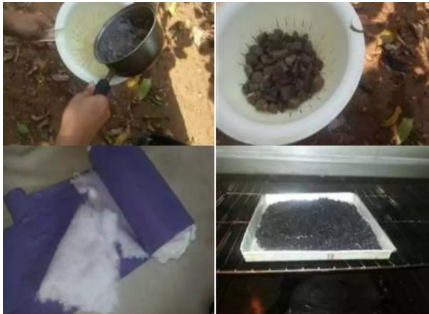
Figura 11. Lavado y secado del carbón activado
