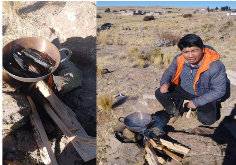
Figura 10. Proceso de elaboración del carbón activado
