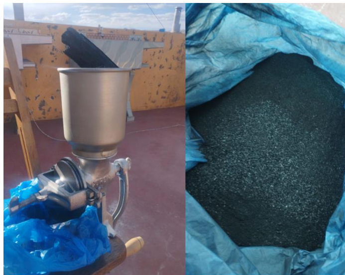
Figura 12. Proceso de trituración del carbón activado
