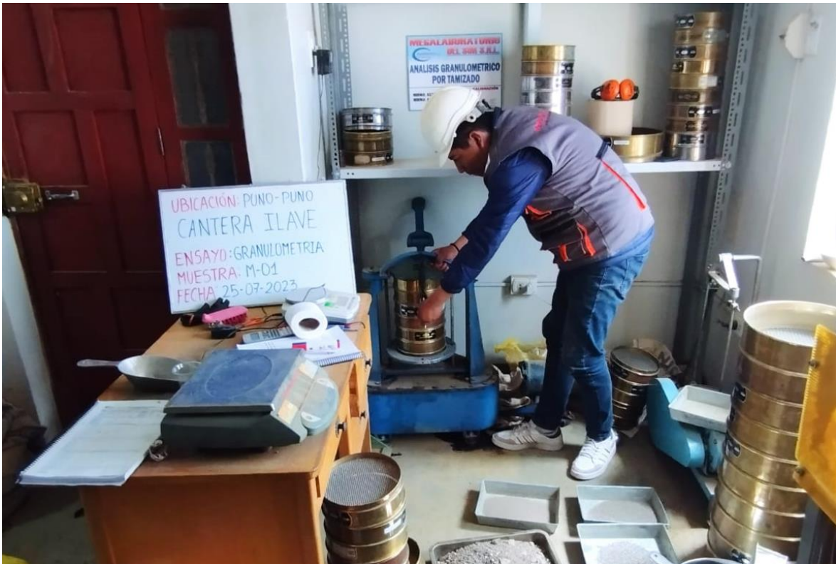
Figura 15. Evaluación de los agregados
