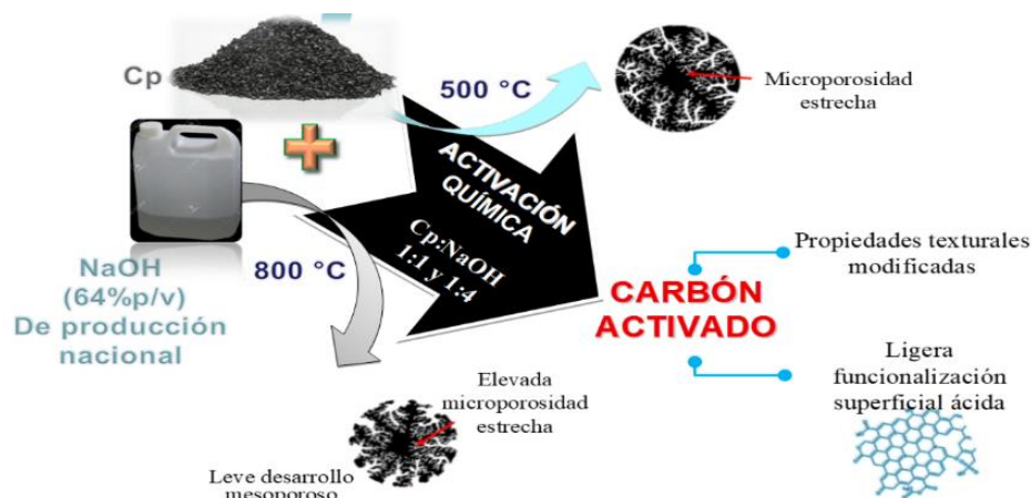
Figura 13. Fases del carbón activado
