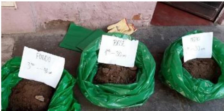
Figura 14. Recolección muestra calicata C-2.
