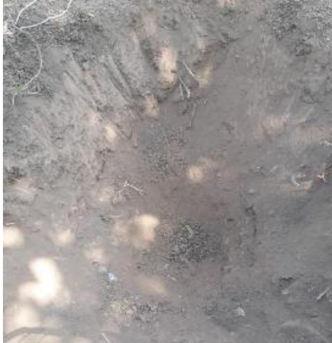
Figura 9. Extracción de suelo calicata C-1.
