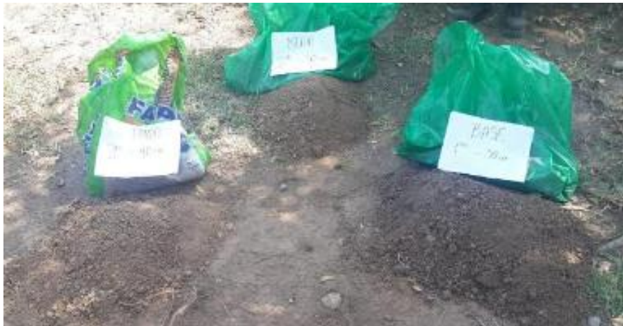
Figura 10. Recolección muestra de calicata C-1.
