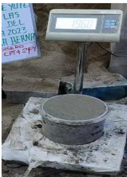
Figura 20. Procedimiento de ensayo de peso unitario. Fuente: elaboración propia Los datos determinados de peso unitario se señalan en la tabla 13.
