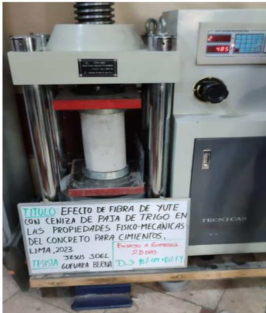
Figura 27. Ensayo de resistencia a compresión a los 28 días. Fuente: elaboración propia
