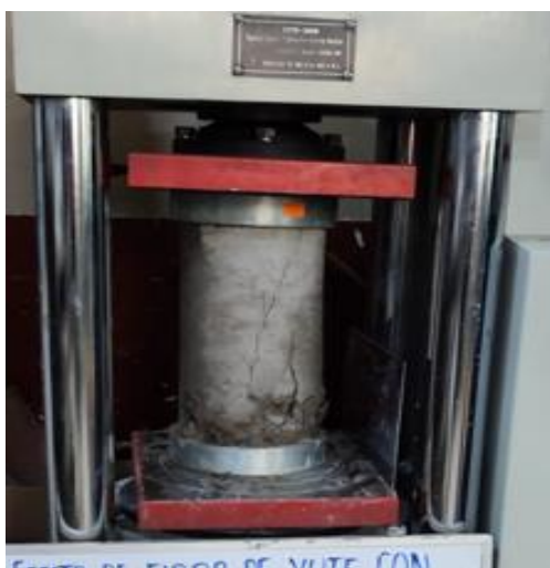
Figura 25. Ensayo de resistencia a compresión - 7 días. Fuente: elaboración propia
