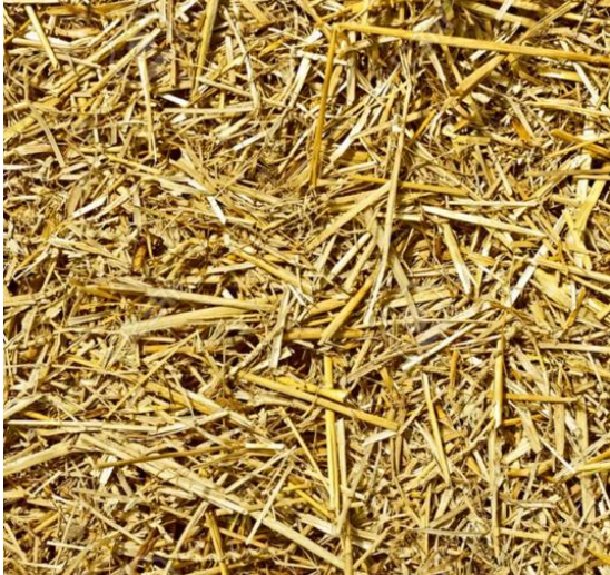
Figura 11. Corte de paja de trigo a 10mm. Fuente: elaboración propia
