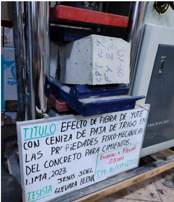
Figura 31. Ensayo de resistencia a flexión a los 28 días. Fuente: elaboración propia
