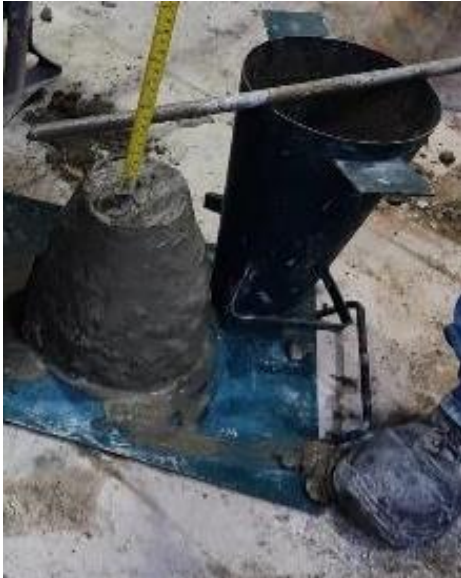
Figura 18. Procedimiento de ensayo de consistencia. Fuente: elaboración propia
