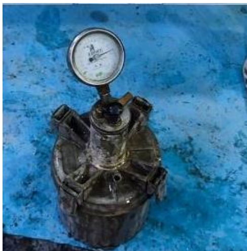
Figura 22. Procedimiento de ensayo contenido de aire. Fuente: elaboración propia.
