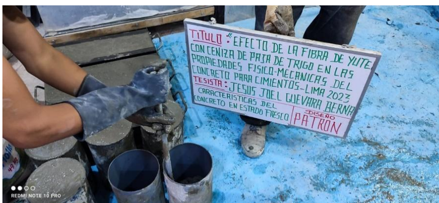
Figura 24. Elaboración de testigos del concreto patrón. Fuente: elaboración propia
