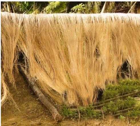
Figura 2. Fibra de yute el proceso de secado. Fuente: elaboración propia.
