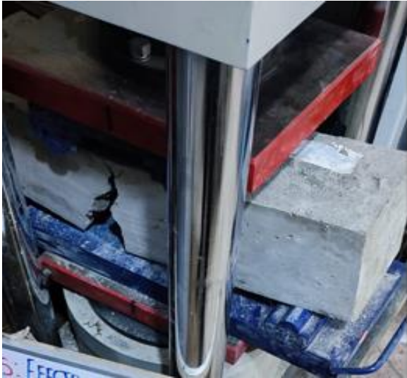
Figura 29. Ensayo de resistencia a flexión a los 7 días. Fuente: elaboración propia
