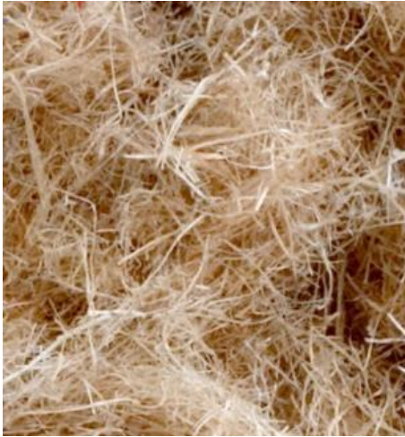
Figura 9. Corte de fibra de yute. Fuente: elaboración propia
