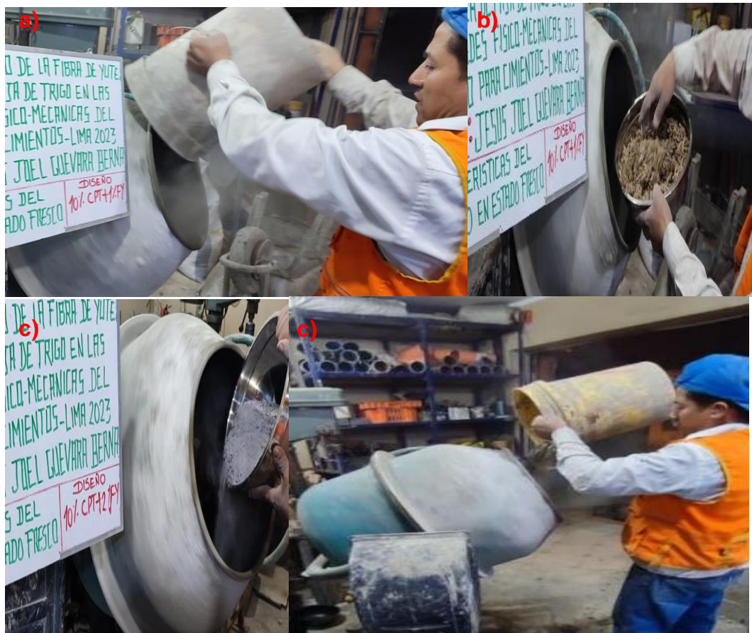
Figura 17. Mezclado de los materiales para la realización de las muestras. Fuente: elaboración propia
