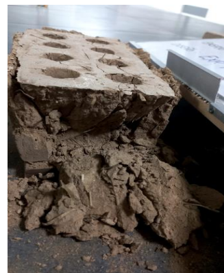
Fotografía 4. Muestra de ladrillo ejercido a compresión.
