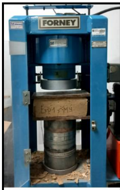
Fotografía 3. Ensayo a compresión de ladrillo.
