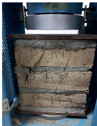
Fotografía 5. Rotura de ladrillo a pila.
