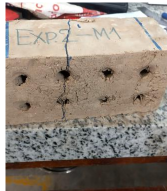
Fotografía 2. Muestra del ladrillo ejercido a carga puntual.
