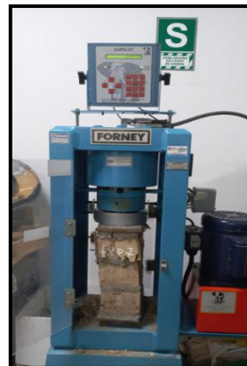
Fotografía 4. Rotura de ladrillos a pila.
