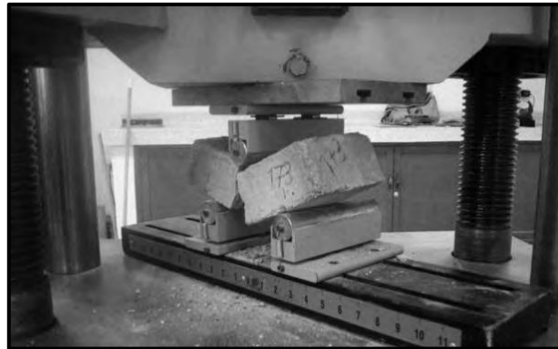
Figura 5. Ensayo de resistencia a flexión Fuente: https://bit.ly/412UCyy
