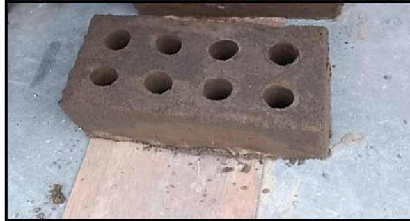
Figura 44. Ladrillo en crudo con adición de fibra de totora, coco y caolín.
