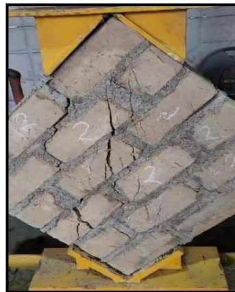
Fotografía 4. Rotura a flexión Exp 2.
