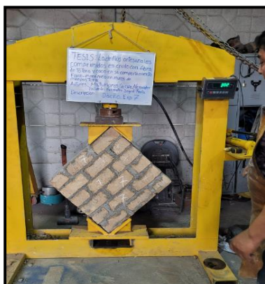
Fotografía 5. Ensayo flexión Exp. 7
