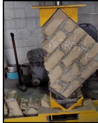
Fotografía 2. Rotura a flexión patrón.
