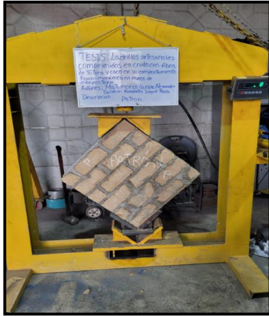
Fotografía 1. Ensayo flexión de Patrón
