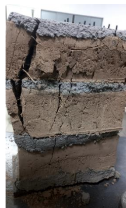
Fotografía 6. Pila de ladrillo ejercido a compresión
