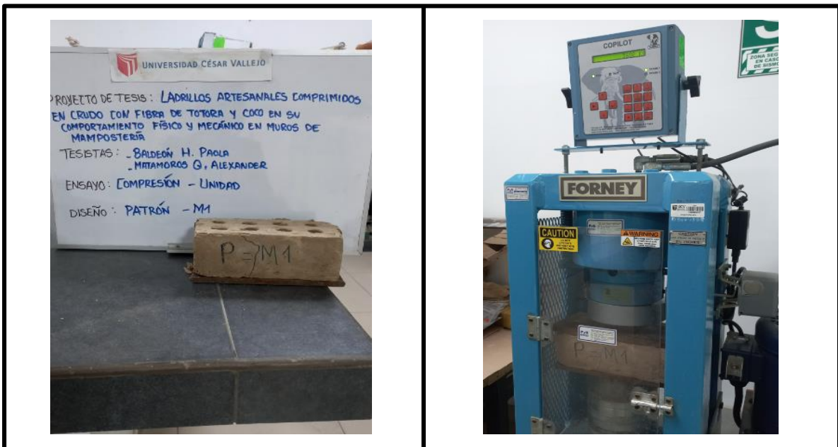
Figura 46. Rotura de resistencia a compresión
