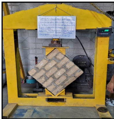
Fotografía 3. Ensayo flexión Exp. 2
