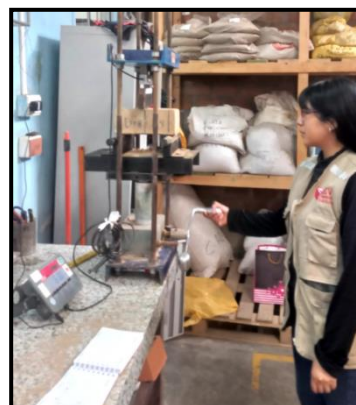
Fotografía 6. Ensayo a flexión de ladrillo
