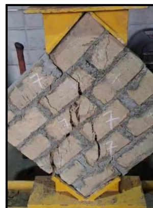
Fotografía 6. Rotura a flexión Exp 7
