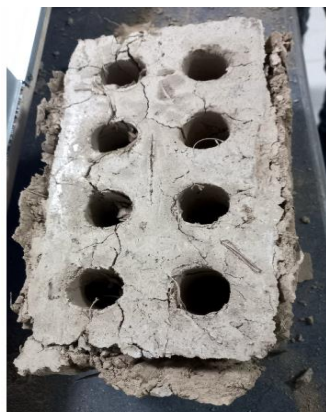
Fotografía 3. Muestra de ladrillo ejercido a compresión.
