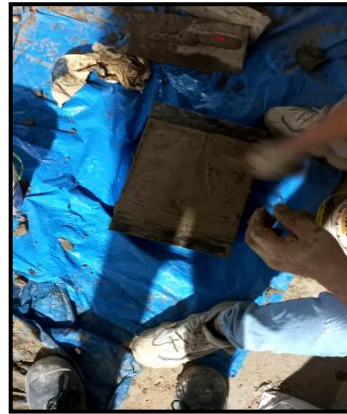
Fotografía 2. Molde con material para ladrillos.
