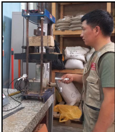
Fotografía 5. Ensayo a flexión de ladrillo.
