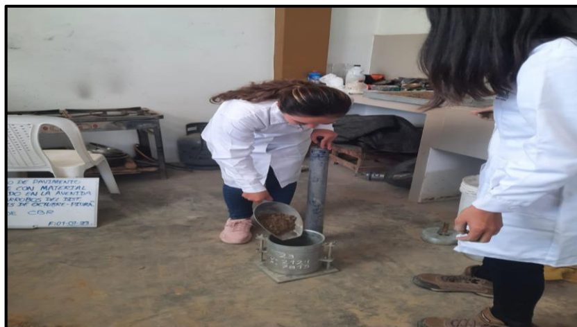
Figura N° 51. Realización de 25 golpes en las cinco capas de la muestra.
