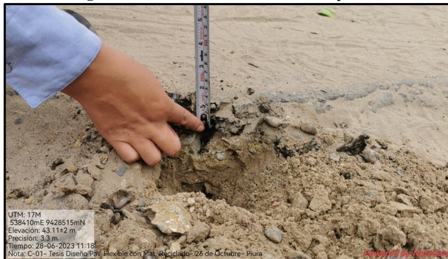
Figura N° 41. Medidas del asfalto de la pavimentación
