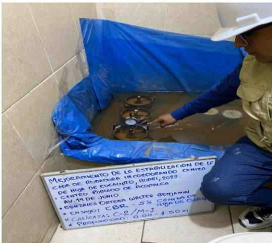
Figura 21. Ensayo de penetración, expansión, CBR con la incorporación de ceniza en porcentajes de 2.5, 5, 7.5 %.
