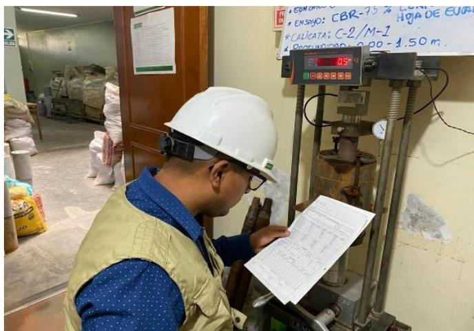
Figura 16: Ensayo CBR del suelo Patrón.
