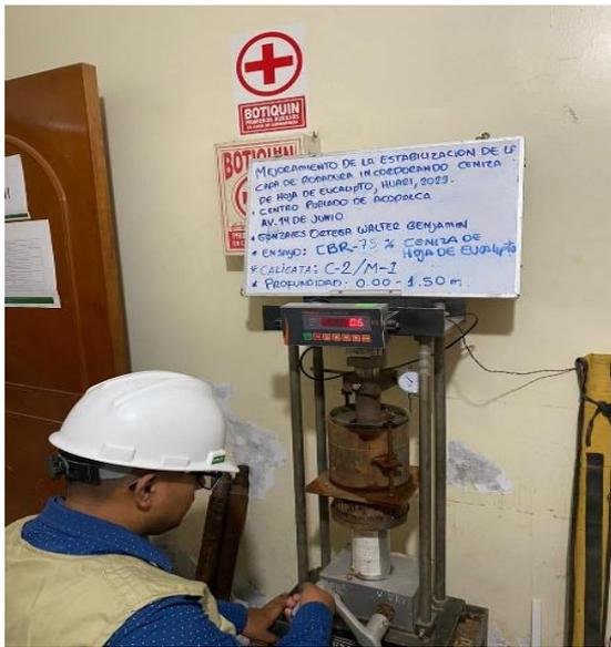
Figura 23. Ensayo de penetración en la máquina de compactación, CBR con la incorporación de ceniza en porcentajes de 2.5, 5, 7.5 %.
