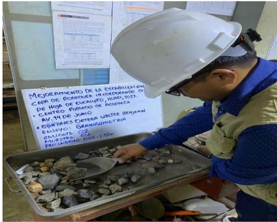
Figura 13. Ensayo de granulometría para ver el tipo de suelo.
