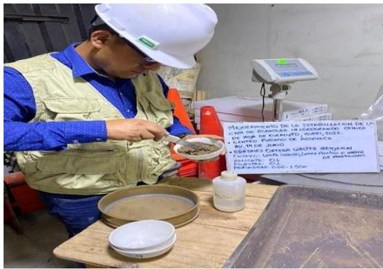
Figura 15. Elaboración de ensayo de limite líquido.
