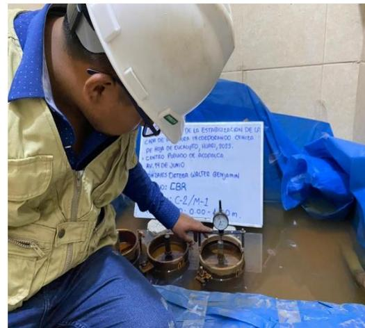
Figura 22. Ensayo de penetración, expansión, CBR con la incorporación de ceniza en porcentajes de 2.5, 5, 7.5 %.
