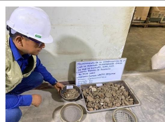
Figura 12. Ensayo de clasificación de suelo.
