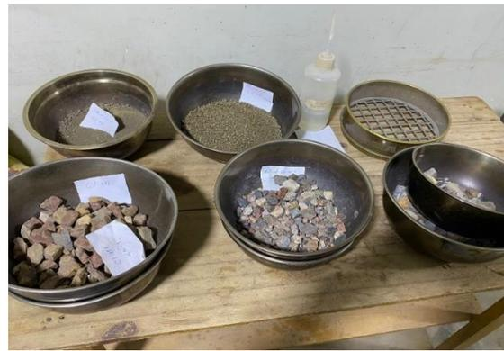
Figura 16. Ensayo de clasificación de suelo.
