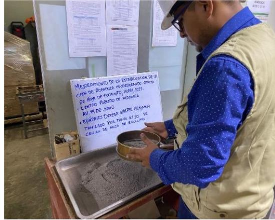
Figura 8. Limpieza por el tamiz n°10 de ceniza de hoja de eucalipto.
