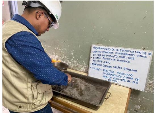
Figura 10. Mezcla del suelo patrón y la ceniza de hoja de eucalipto.
