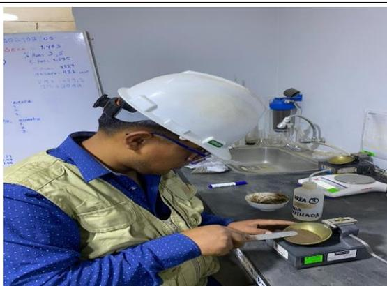
Figura 17. Ensayo de limite líquido del suelo patrón.
