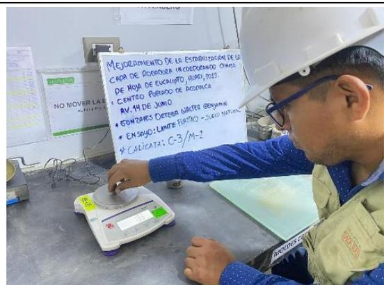
Figura 18. Ensayo de limite plástico del suelo patrón.
