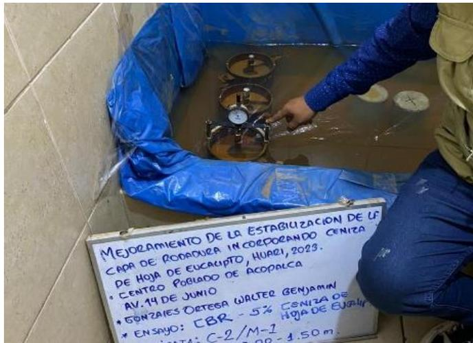
Figura 15: Ensayo inmersión del suelo Patrón.
