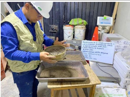
Figura 11. Ensayo de granulometría para ver el tipo de suelo.
