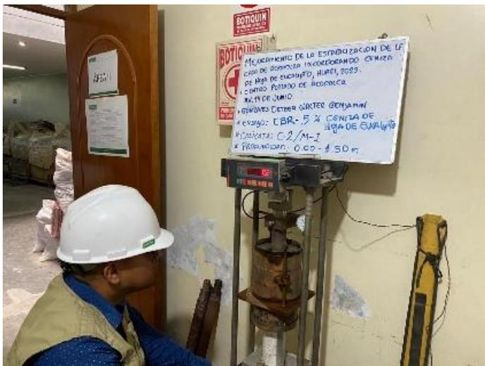
Figura 10: Ensayo CBR del suelo Patrón.
