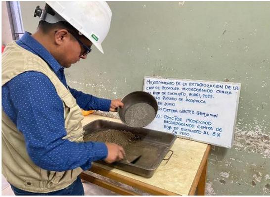
Figura 9. Dosificación de ceniza de hoja de eucalipto en el suelo patrón.
