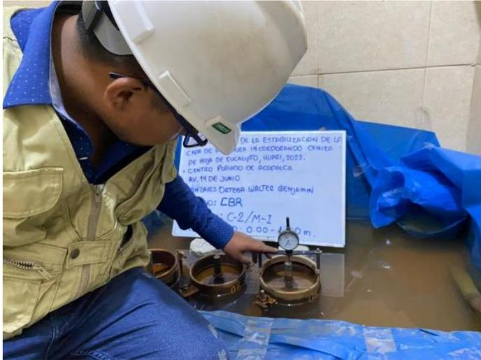
Figura 9: Ensayo inmersión del suelo Patrón.
