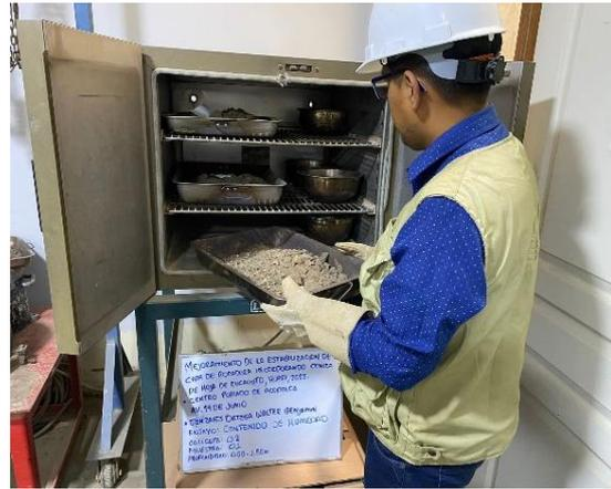
Figura 14. Ensayo de contenido de humedad.
