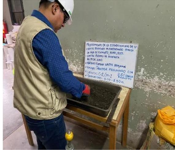
Figura 20. Ensayo de compactación, Proctor modificado.
