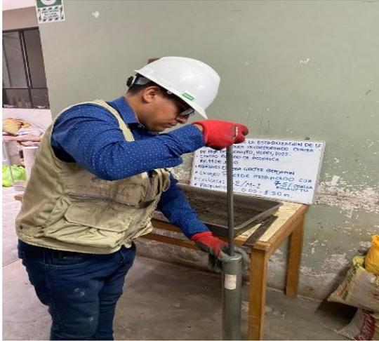
Figura 19. Ensayo de compactación, Proctor modificado.
