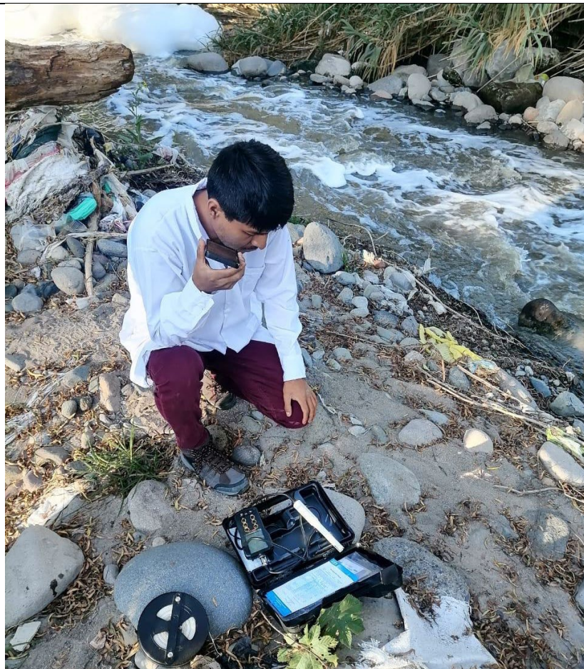
Foto N° 04. Preparación para la medición de parámetros in-situ del río Alameda haciendo uso de multiparámetro
