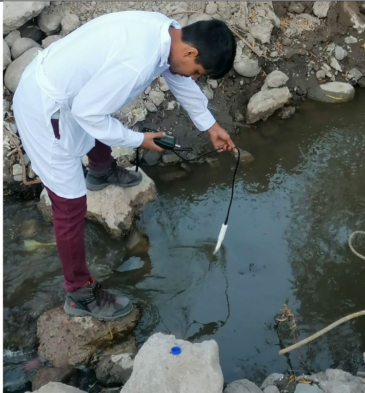
Foto N° 05. Medición in situ con multiparámetro del río Alameda
