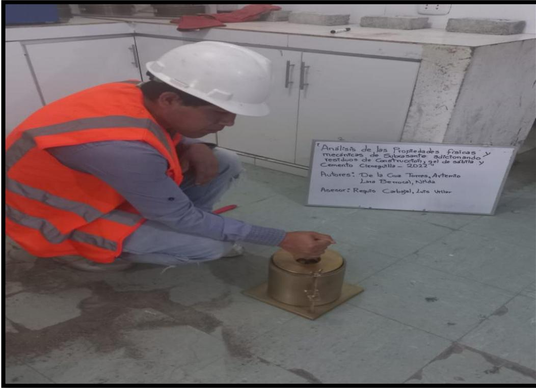
Figura 21. Colocación de papel y espaciador en el molde
