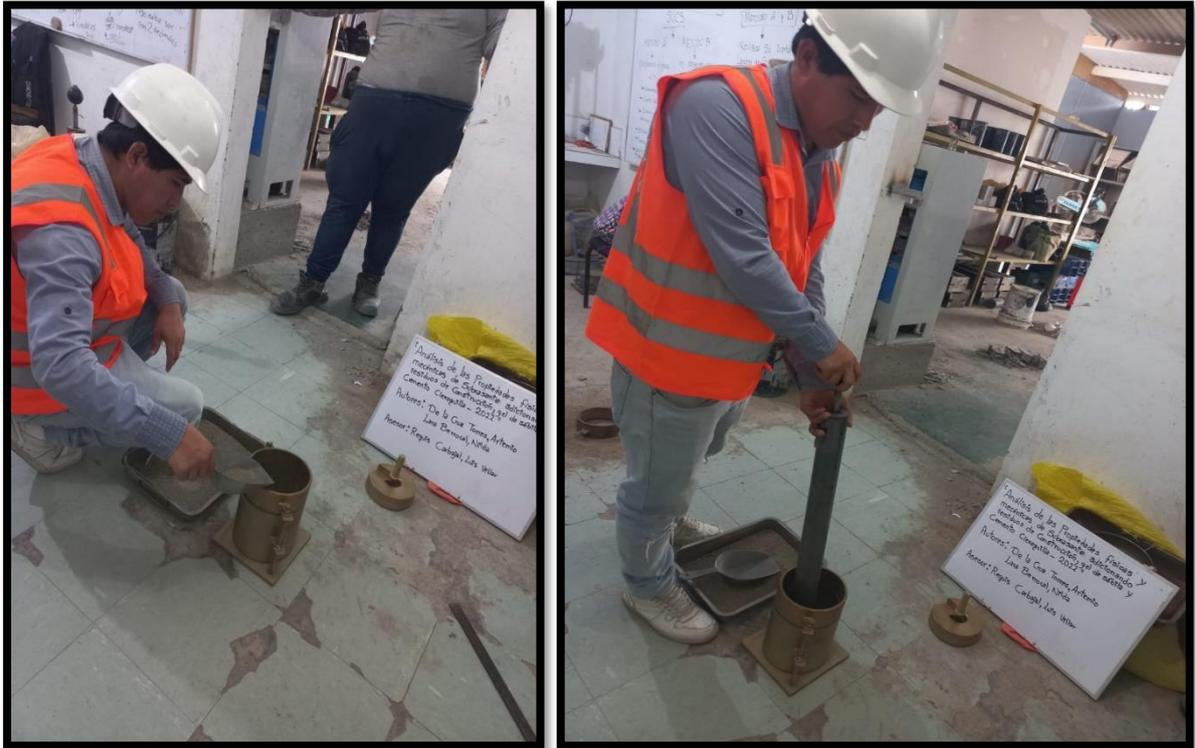
**Figura 19.** Llenado del suelo por capas para la compactación y se realizó la compactación.
