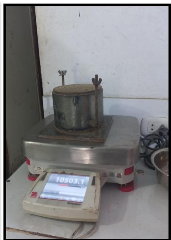
**Figura 16.** Peso del material junto con el molde
