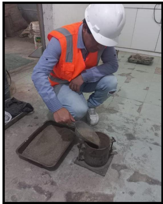
**Figura 12.** Colocación de la muestra en el molde por capas.
