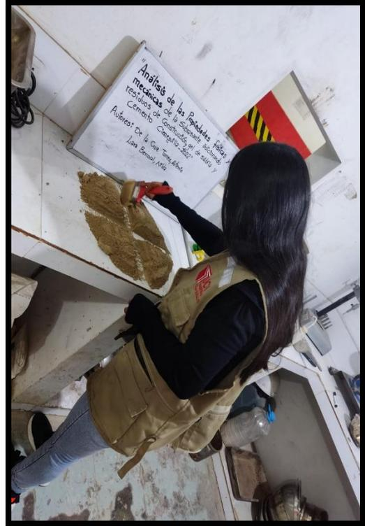
Figura 7. Separación de la muestra en 4 partes iguales con la ayuda de una regla y limpieza de los espacios con una brocha.
