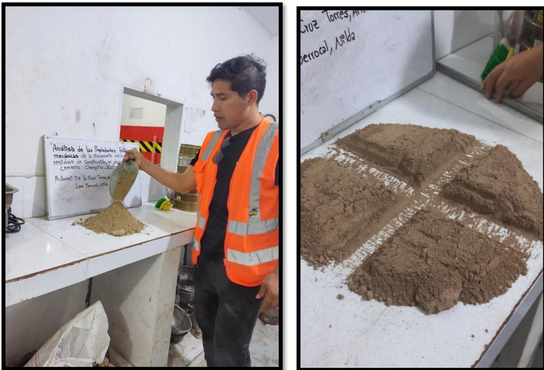
**Figura 6.** Vertido de la muestra en forma de cono de arena y separación de la muestra en 4 partes iguales (método del cuarteo) para el análisis granulométrico.
