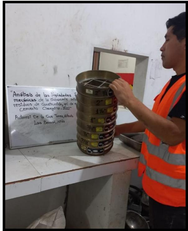
**Figura 9.** Tamizado de la muestra
