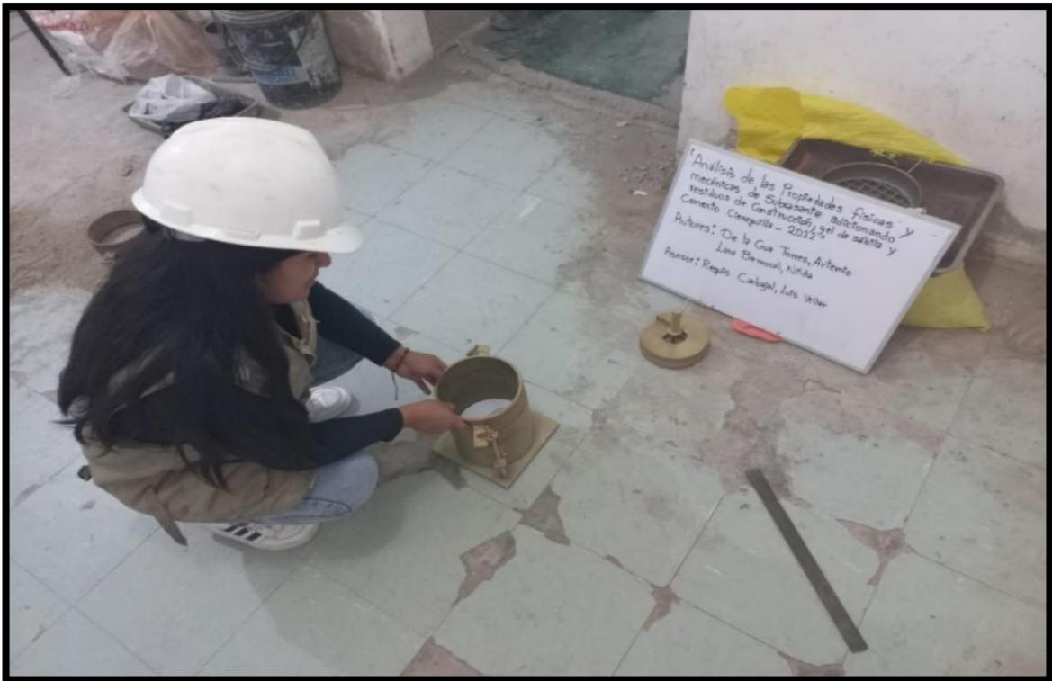
**Figura 18.** Armado del molde cilíndrico
