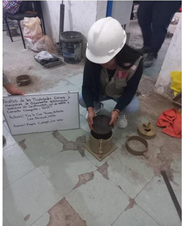
**Figura 17.** Peso del molde y colocación del separador
