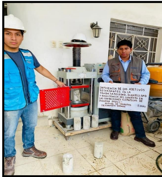
Figura 22. Rotura de probetas 7 días (patrón, 0.5%)
