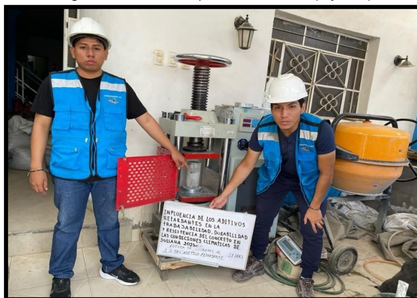
Figura 27. Rotura de probetas 21 días (1 y 2 %)
