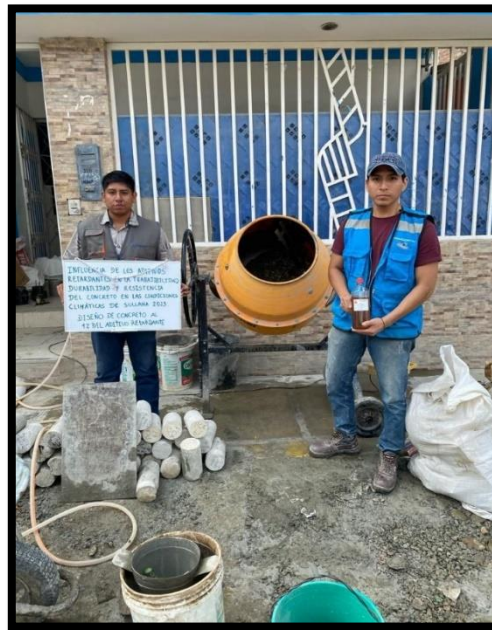
Figura 17. Elaboración de testigos con adición de AR al 1.0%
