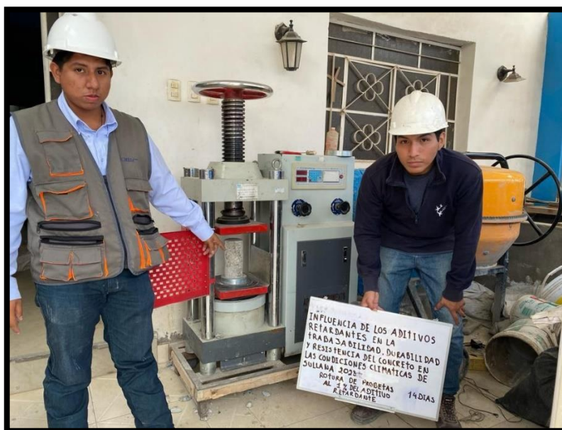
Figura 25. Rotura de probetas 14 días (1 y 2 %)
