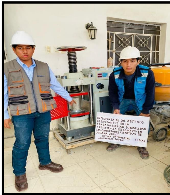
Figura 24. Rotura de probetas 14 días (patrón, 0.5)
