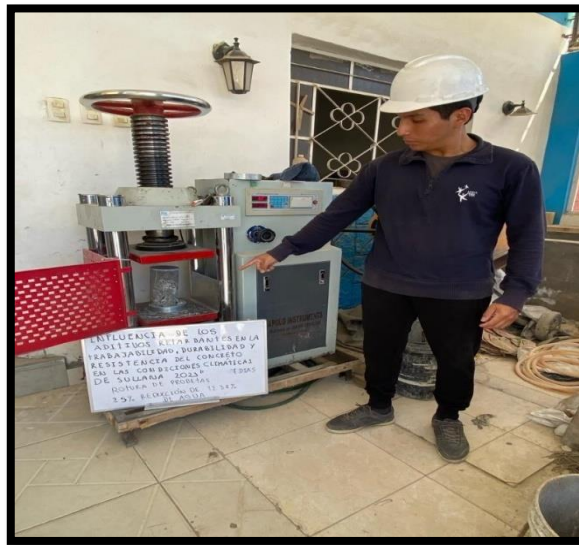
Figura 28. Rotura de probetas 7 días - reducción de agua
