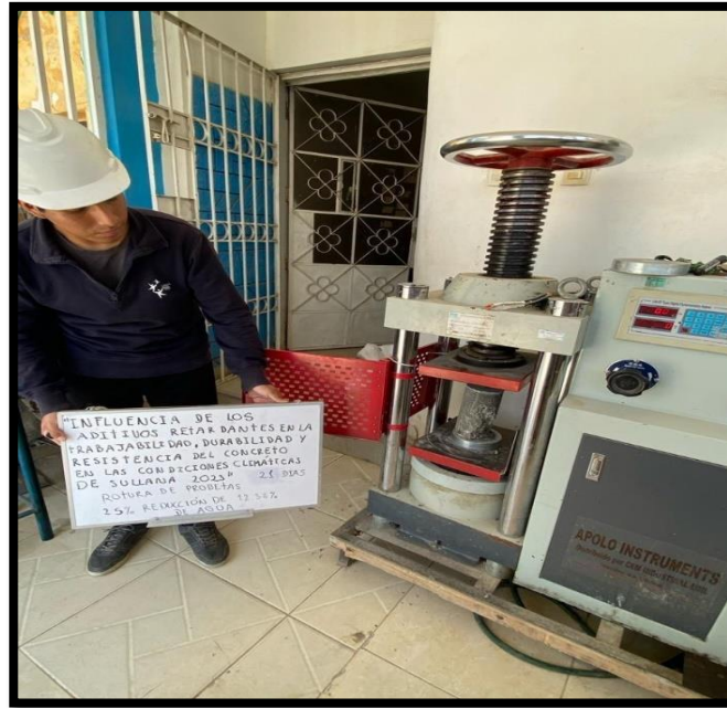
Figura 30. Rotura de probetas 21 días con reducción de agua
