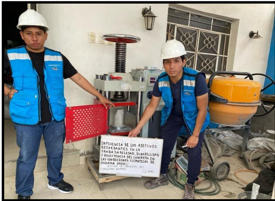
Figura 26. Rotura de probetas 21 días (patrón, 0.5)
