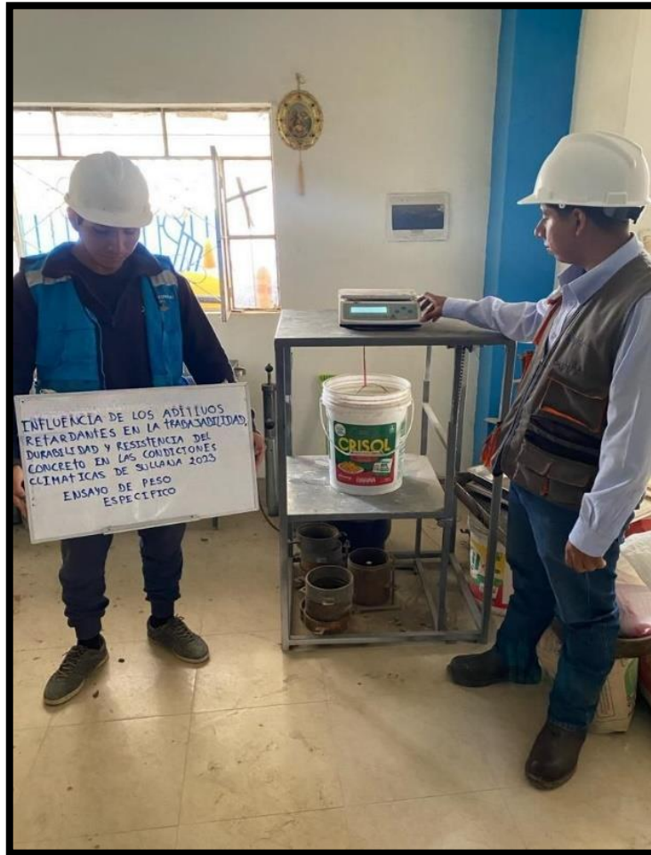
Figura 14. Ensayo de peso específico y absorción de agregados
