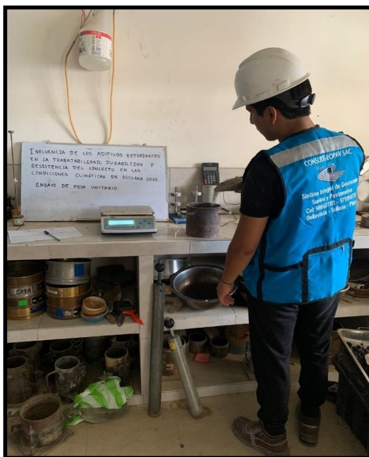
Figura 13. Ensayo de peso unitario
