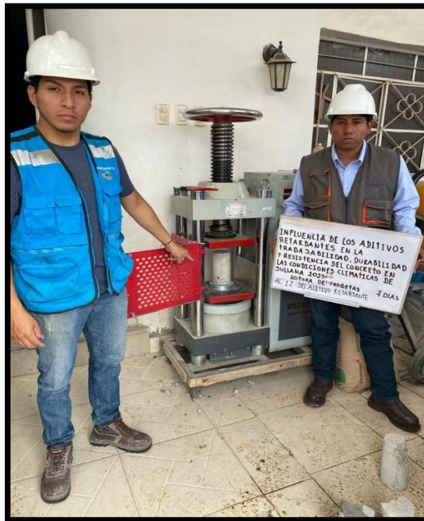
Figura 23. Rotura de probetas 7 días (1 y 2 %)
