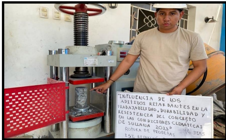
Figura 29. Rotura De Probetas 14 Días - Reducción de agua
