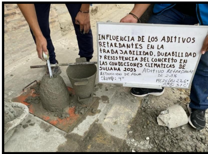
Figura 20. Elaboración de testigos con adición de AR al 2.5 aditivo y reducción de agua (de 21.90%)
