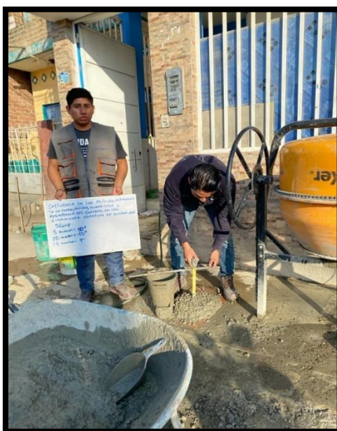
Figura 18. Elaboración de testigos con adición de AR al 2.0
