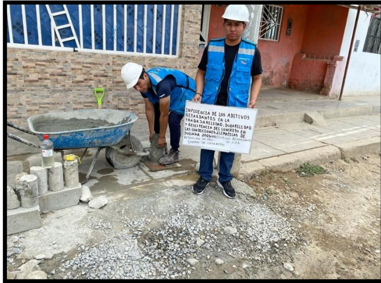
Figura 19. Elaboración de testigos con adición de AR al 2.5 aditivo y reducción de agua (12.38%)
