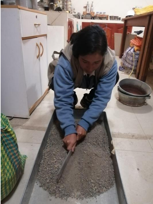
Cuarteando el agregado fino para la ejecucion del ensayo granulometrico.
