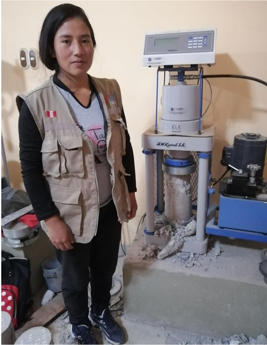
Probeta rota con la prueba hecha para el ensayo de compresión a los 21 días.
