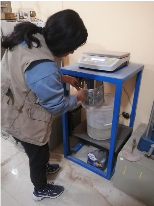
Colocando la muestra en la canastilla para obtener el peso específico.
