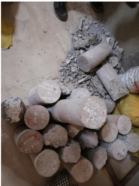
Ensayo de rotura de probetas.
