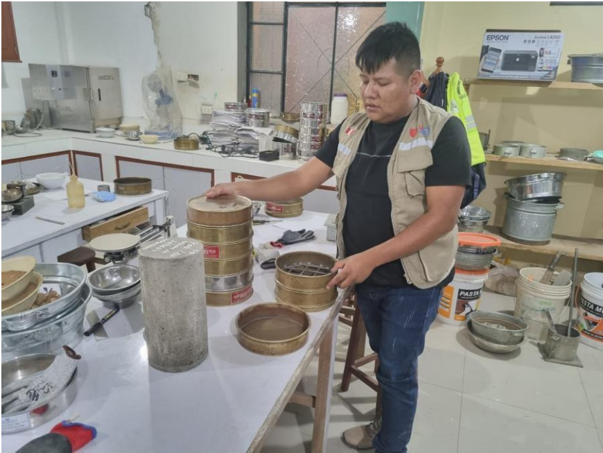
Seleccionando los tamizes que se van a usar en el ensayo granulometrico de material grueso y fino
