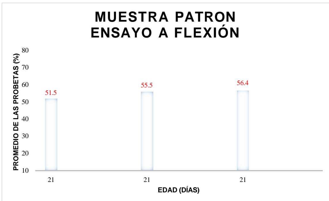
Figura 12. Resultado del ensayo a flexión según la NTP 339.078 (muestra patrón)
