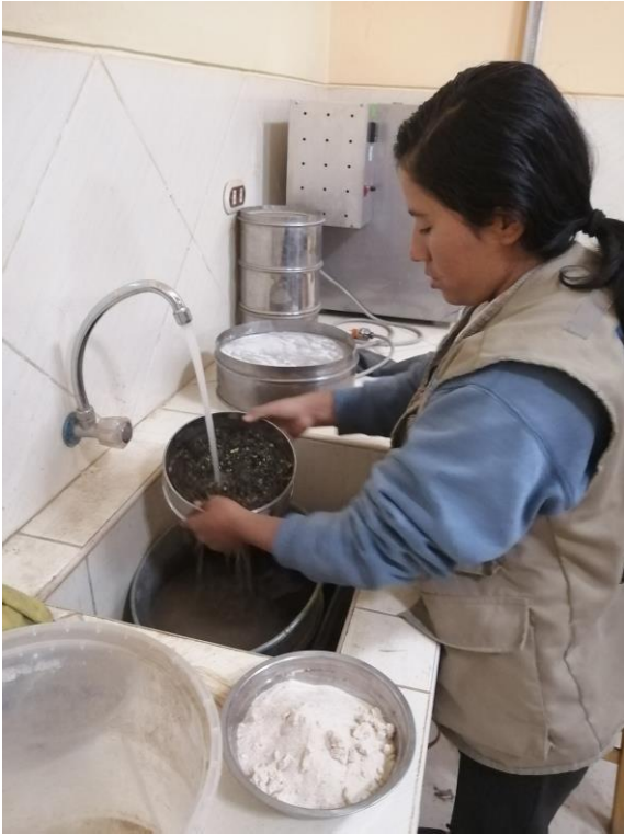
Labando el material para poder hacer el peso específico de la piedra.
