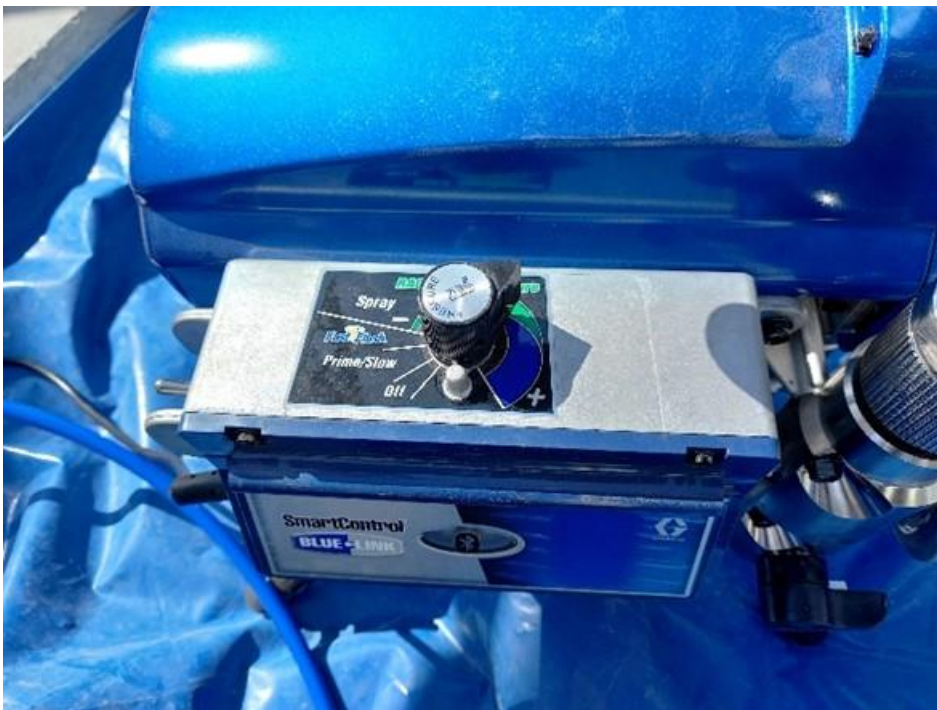
Figura 44 Compresor usado para recubrir el con goma RTV al IN-5162 Fuente: Área de mantenimiento de equipos de patio de llaves.
