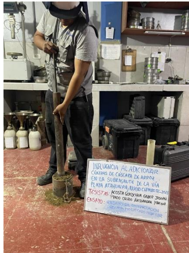
Figura 10. Compactación con pistón para C-2 en Proctor Modificado
