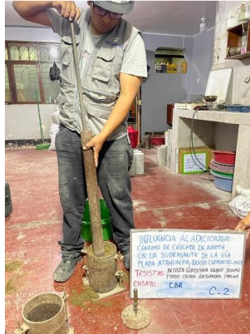
Figura 11. Compactación con pistón para C-2 en CBR
