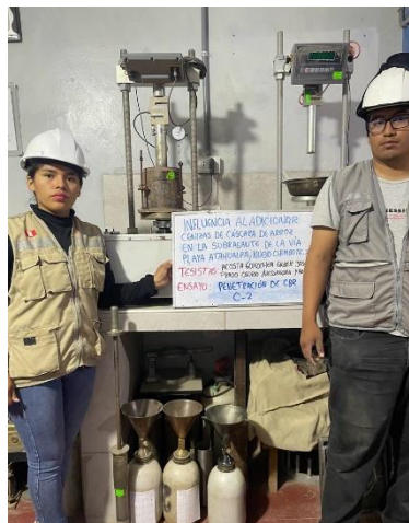
Figura 12. Penetración de CBR de C-2
