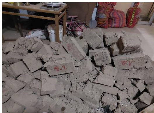
Fotografía 14 Muestras destruidas parte de los ensayos
