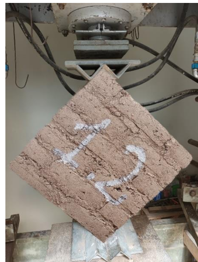
Fotografía 12. Ensayo a la compresión diagonal
