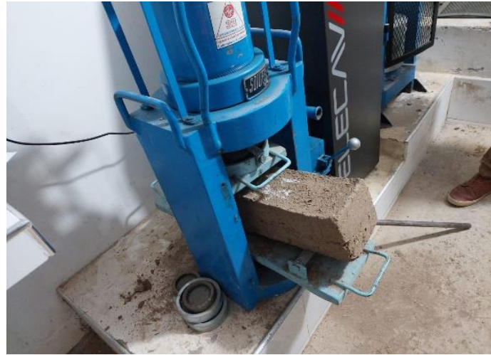
Fotografía 11. Ensayo de resistencia a la flexión
