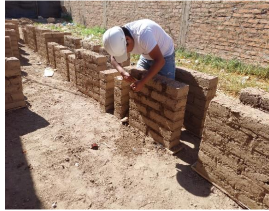
Fotografía 4. Fabricación de los muretes y vigas
