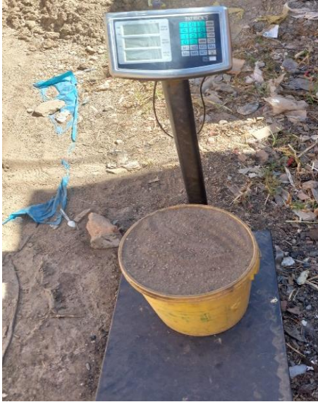
Fotografía 1. Dosificación en relación al peso del suelo y la fibra de L.M
