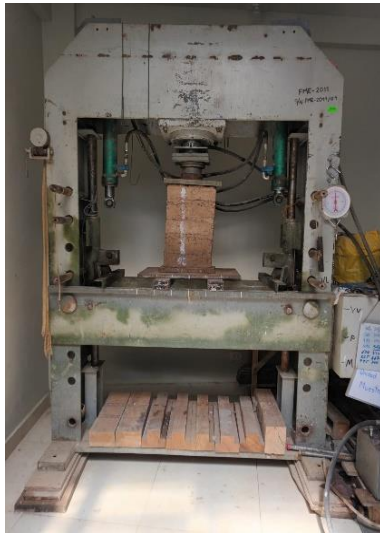
Fotografía 13. Ensayo a la compresión axial
