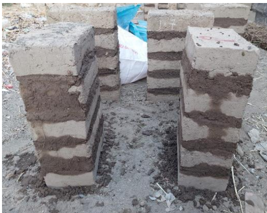
Fotografía 5. Elaboración de las pilas de adobe
