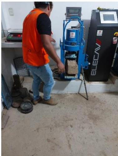
Fotografía 11. Ensayo de resistencia a la flexión
