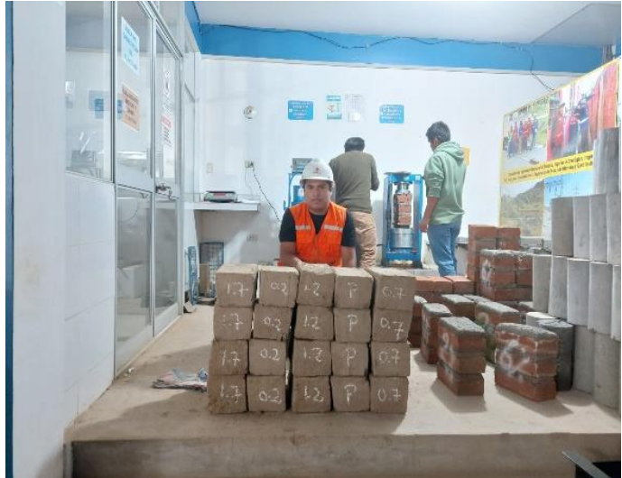
Fotografía 10. Señalización del Punto medio para el ensayo a la flexión
