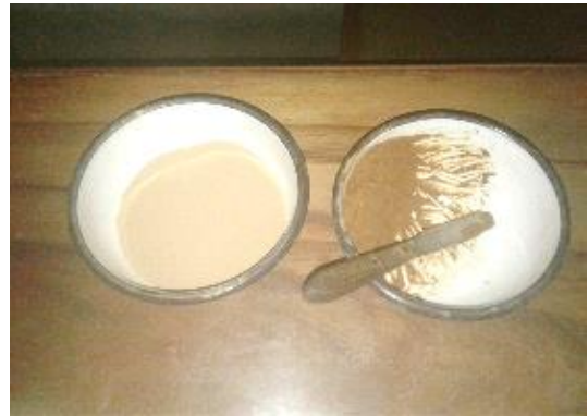
Fotografía 7. Ensayo de límites de consistencia
