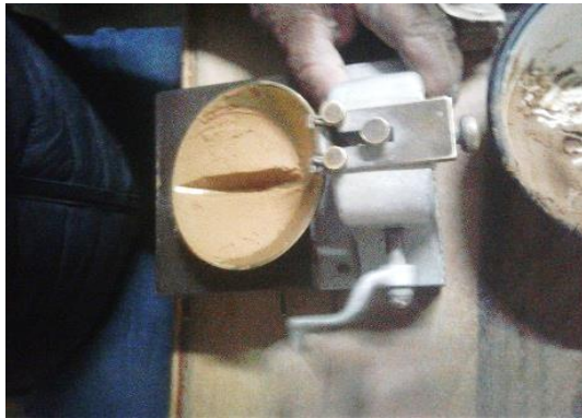
Fotografía 7. Ensayo de límites de consistencia
