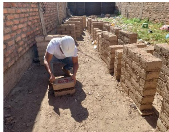
Fotografía 5. Elaboración de las pilas de adobe
