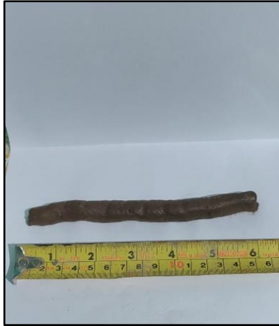
Figura 11. Prueba de cinta de barro
