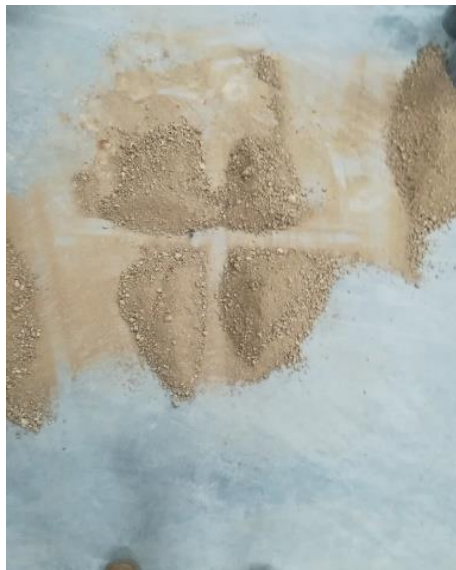
Fotografía 6. Ensayo de granulometría
