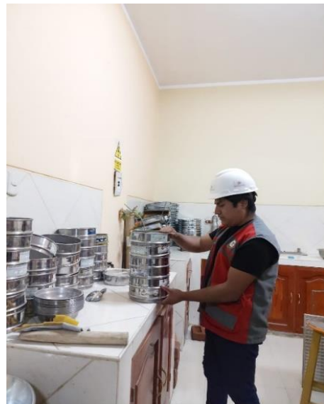
Fotografía 6. Ensayo de granulometría
