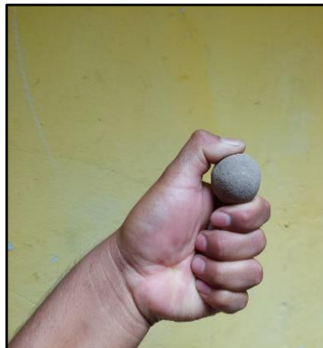
Figura 12. Prueba para determinar la presencia de Arcilla
