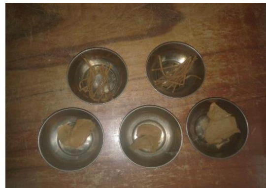
Fotografía 9. Muestra seca y húmeda para los límites
