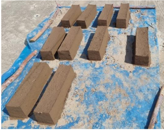
Fotografía 4. Fabricación de los muretes y vigas
