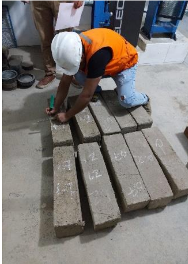
Fotografía 10. Señalización del Punto medio para el ensayo a la flexión
