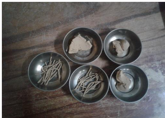
Fotografía 9. Muestra seca y húmeda para los límites
