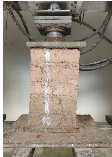
Fotografía 13. Ensayo a la compresión axial
