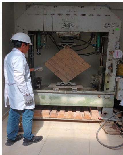
Fotografía 12. Ensayo a la compresión diagonal
