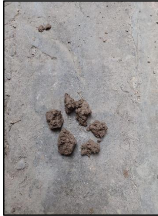
Figura 13. Prueba Contenido de Humedad
