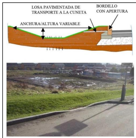
Figura N° 04: Cuneta Tradicional – Estructura
