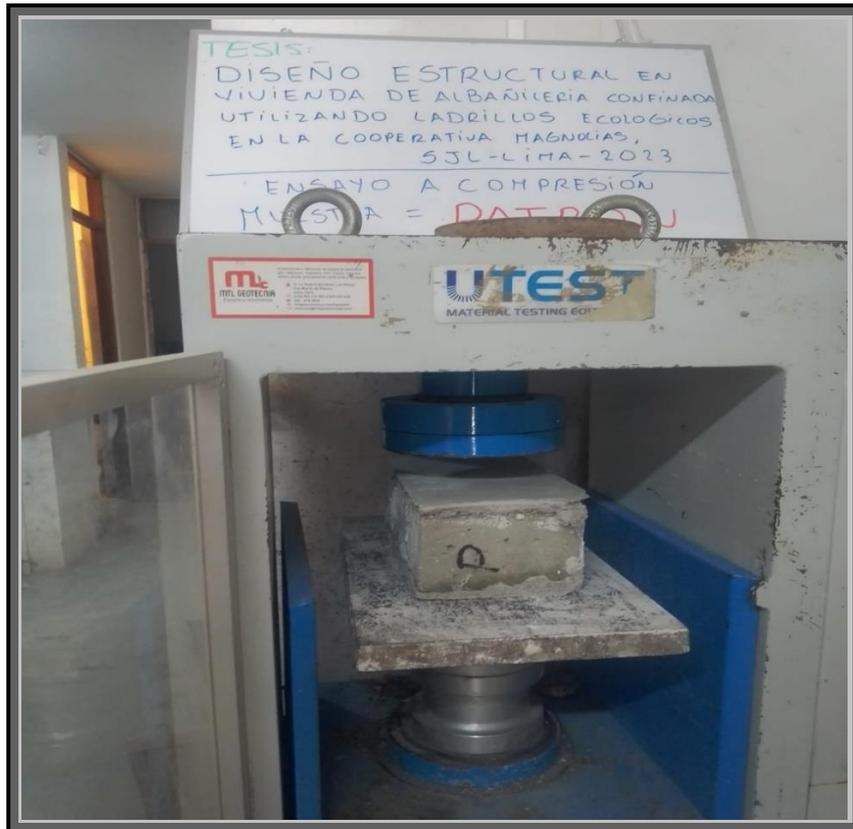
Foto22: Ensayo Ladrillo ecológico Patrón
