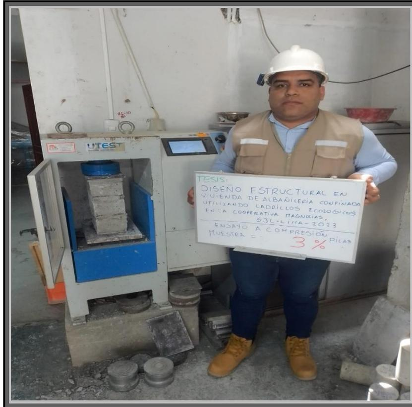
Foto40: Ensayo a compresión de Pilas Ladrillo 3%
