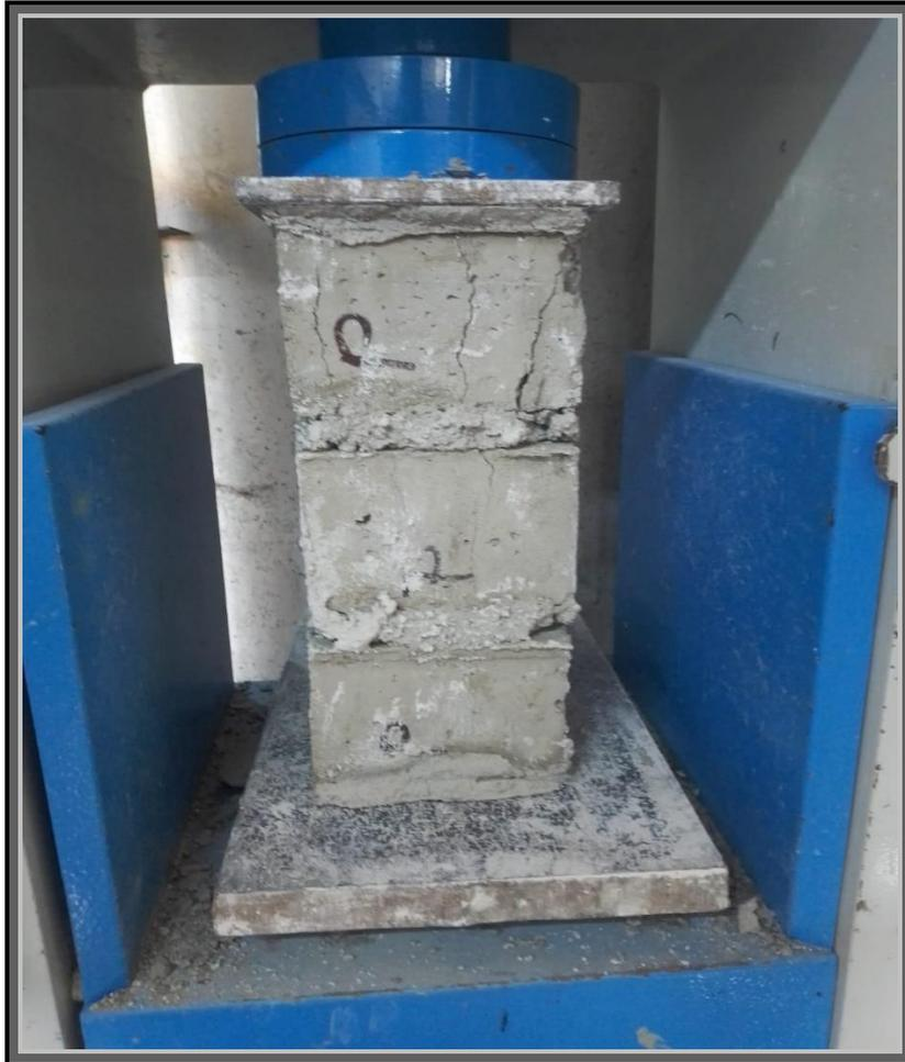
Foto38: Ensayo a compresión de Pilas Ladrillo Patrón
