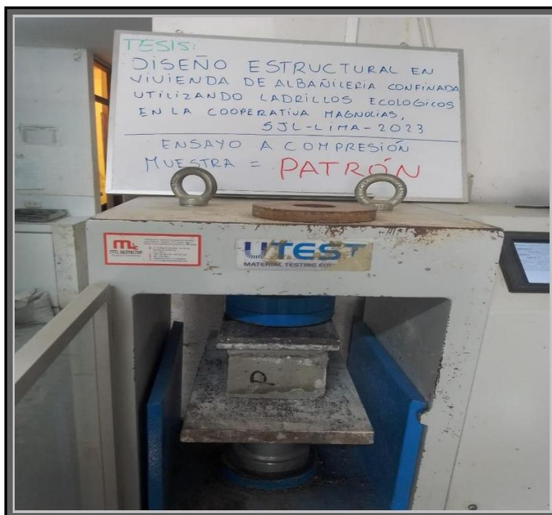
**Figura 27:** Ensayo a compresión del ladrillo ecológico
