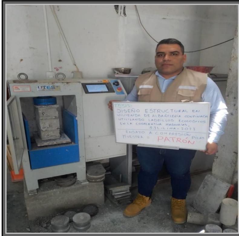
Foto37: Ensayo a compresión de Pilas Ladrillo Patrón
