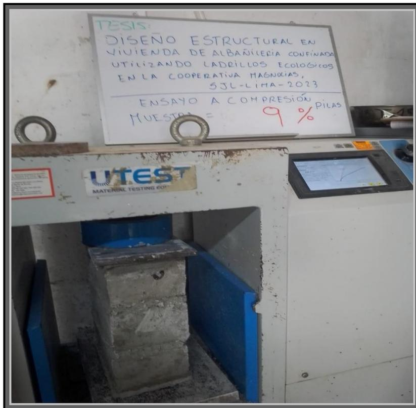
Foto49: Ensayo de compresión de pilas 9%
