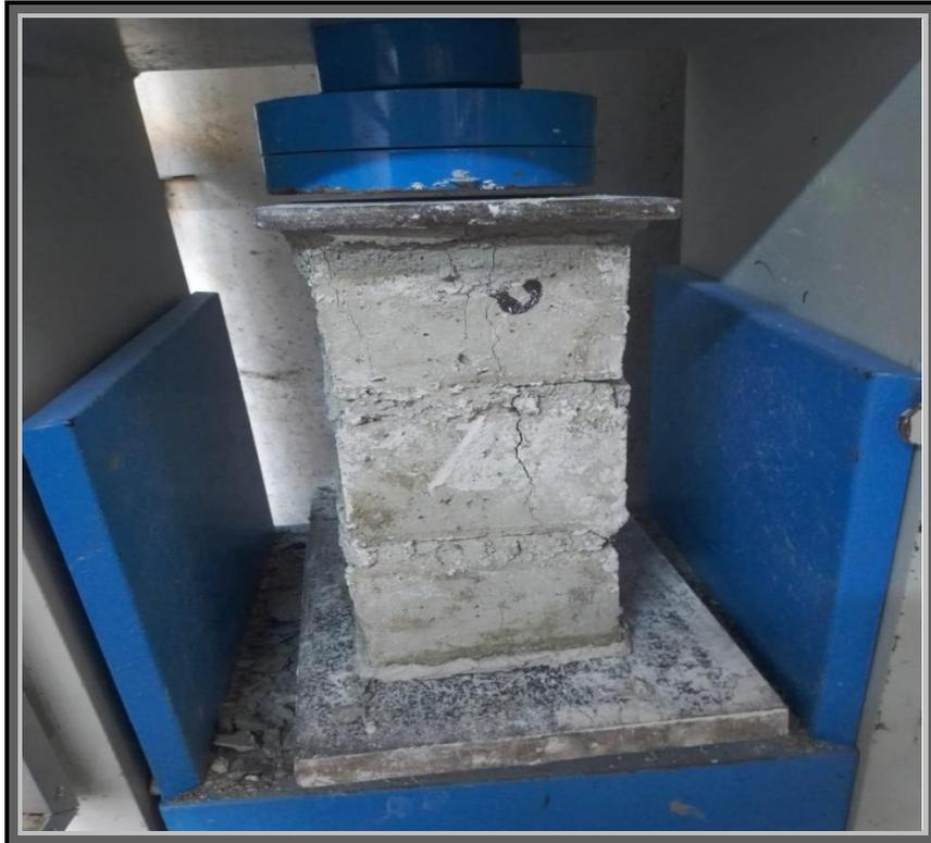
Foto50: Ensayo de compresión de pilas 9%
