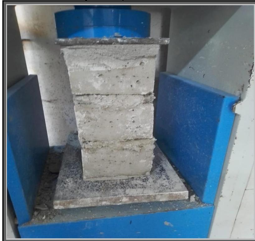
Foto41: Ensayo a compresión de Pilas Ladrillo 3%
