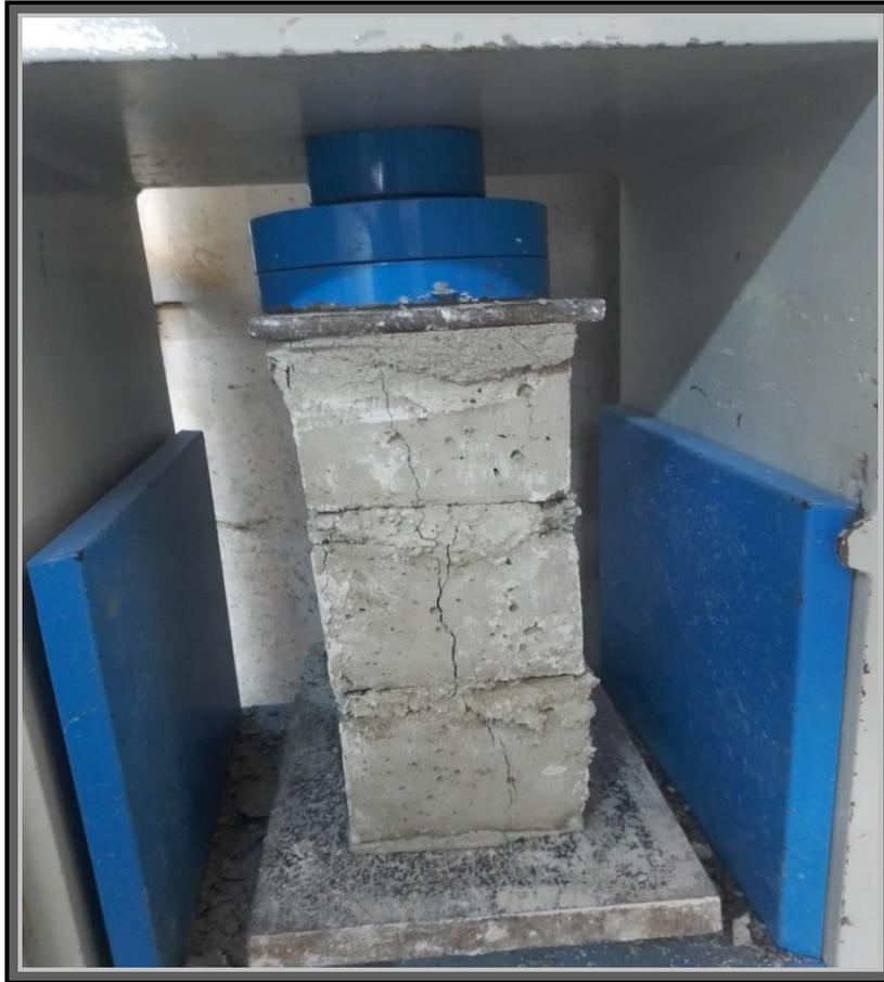
Foto42: Ensayo a compresión de Pilas Ladrillo 3%
