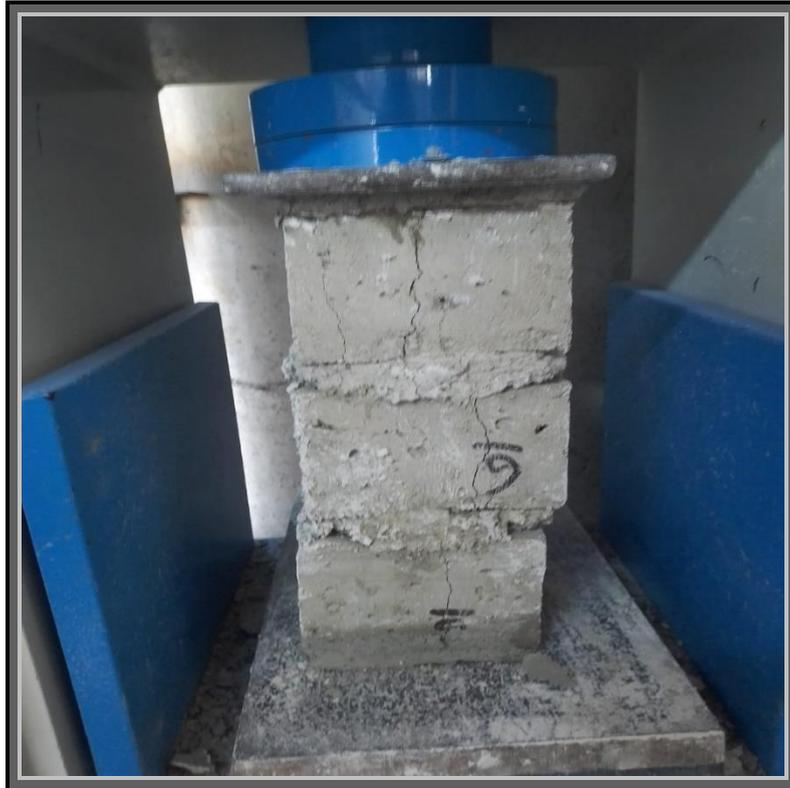
Foto46: Ensayo a compresión de Pilas Ladrillo 6%
