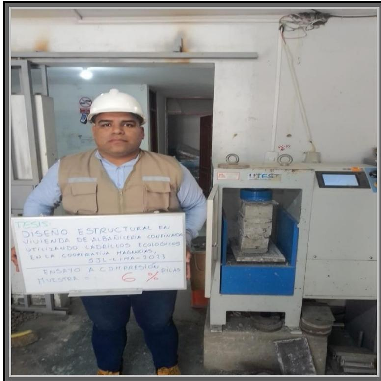
**Foto44:** Ensayo a compresión de Pilas Ladrillo 6%
