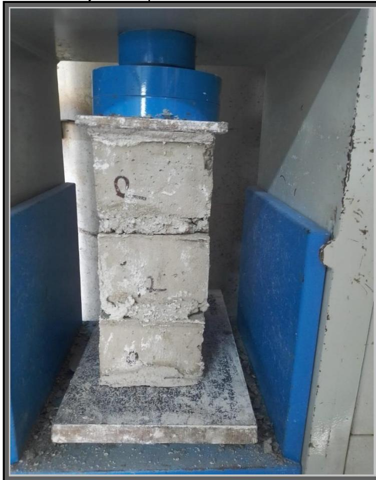
Foto38: Ensayo a compresión de Pilas Ladrillo Patrón
