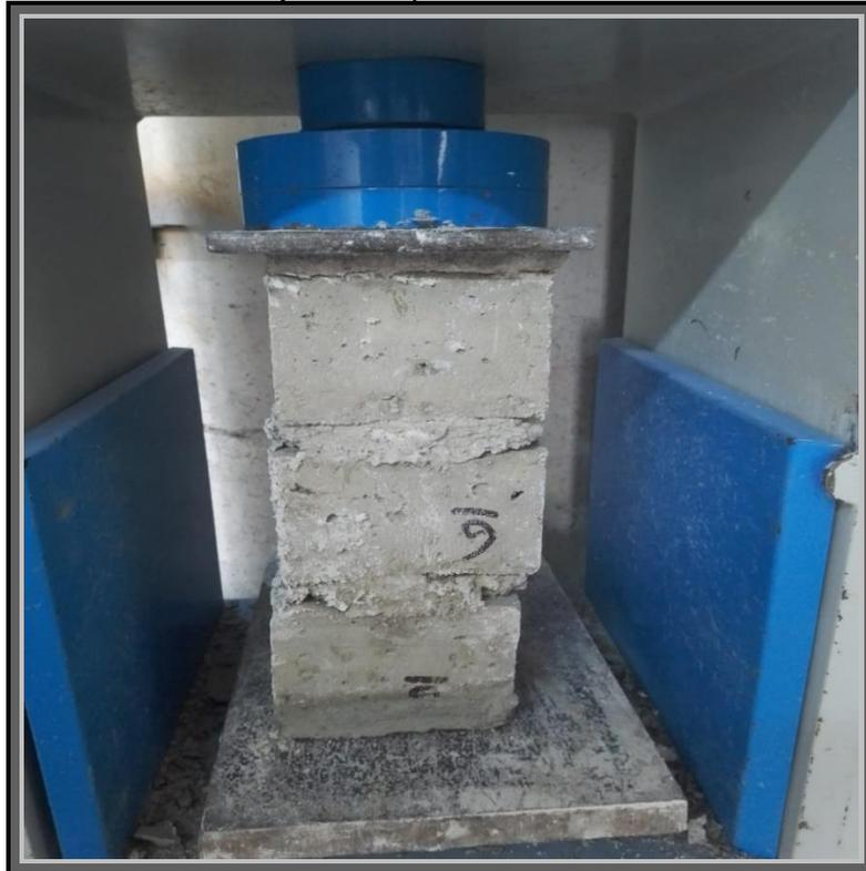
**Foto45:** Ensayo a compresión de Pilas Ladrillo 6%
