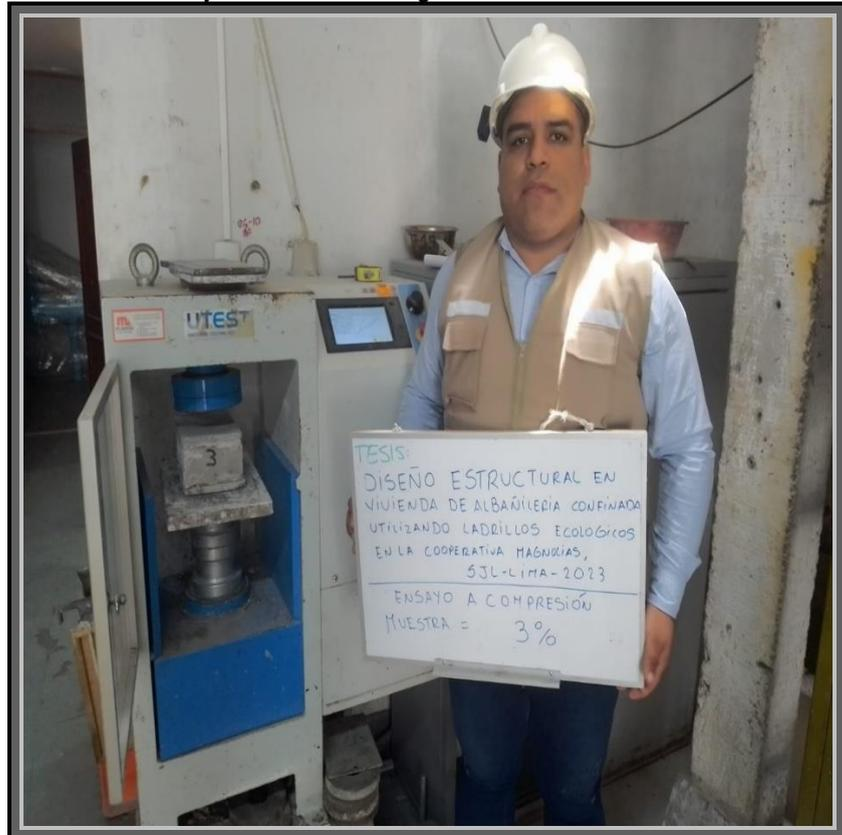
Foto27: Ensayo Ladrillo ecológico Patrón
