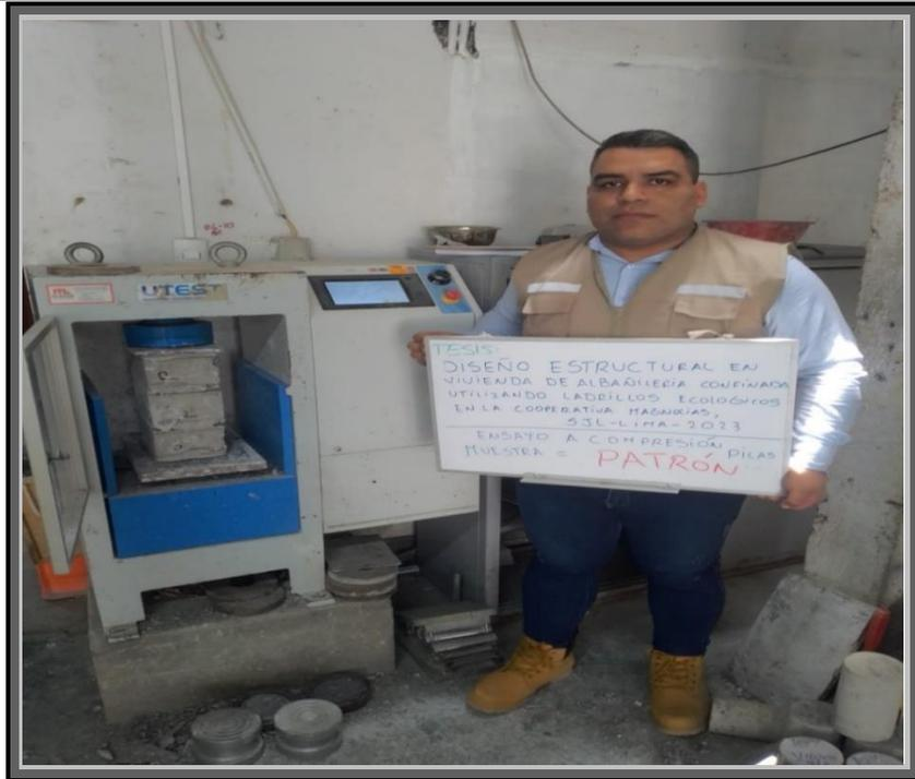
**Figura 28:** Ensayo a compresión de Pilas de ladrillo ecológico
