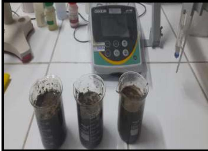
**Fig.39.** Muestra de abono, pasta para determinación del pH.
