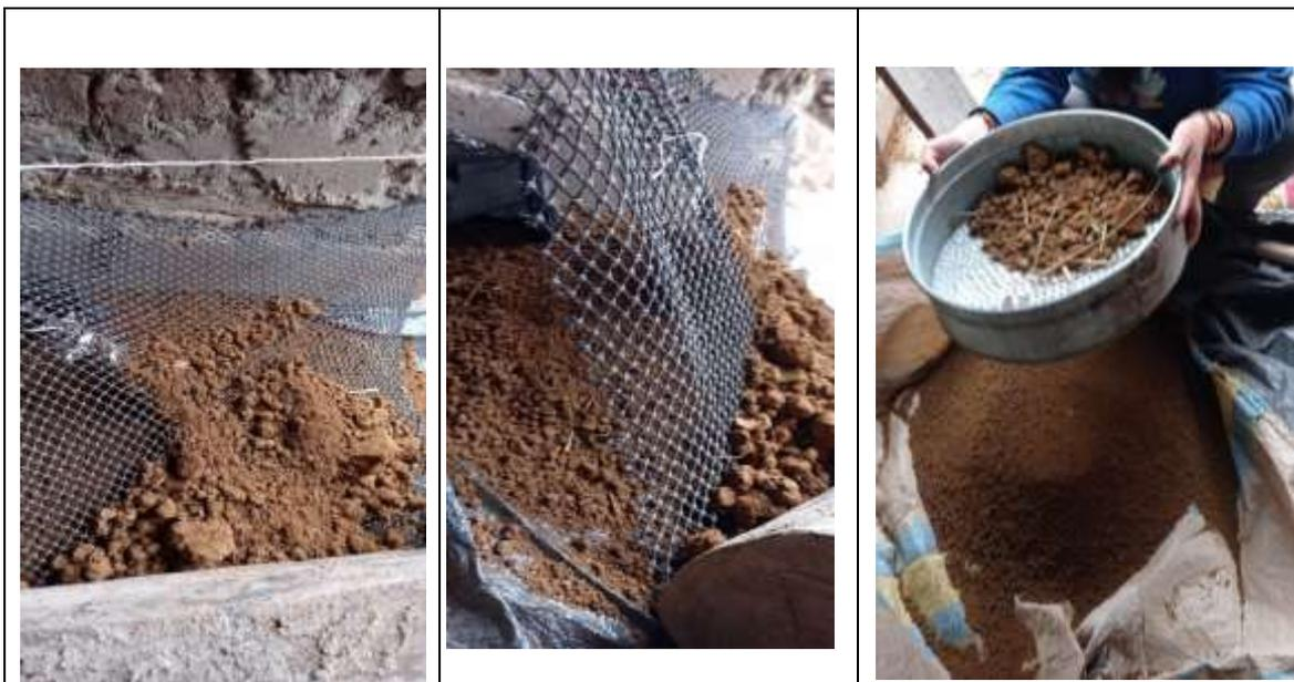
**Fig.25.** Tamizado del suelo-testigo.
