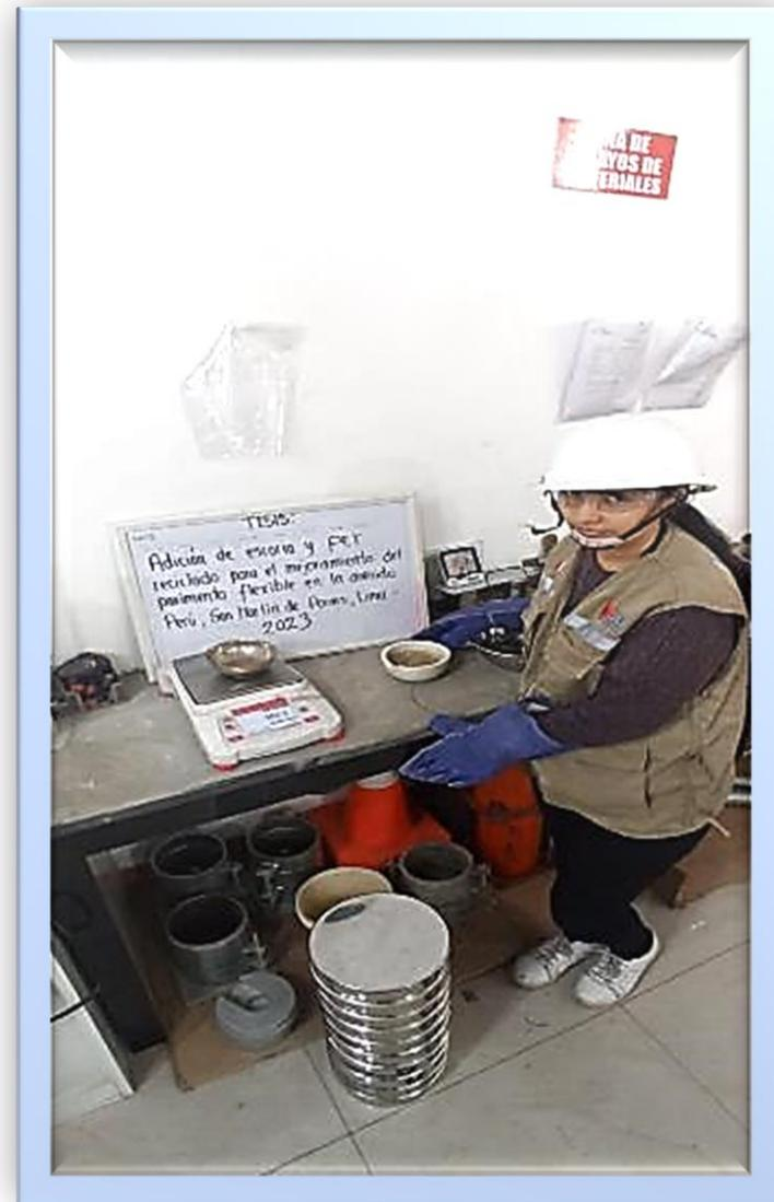
Figura 41 Ensayo de granulometría
