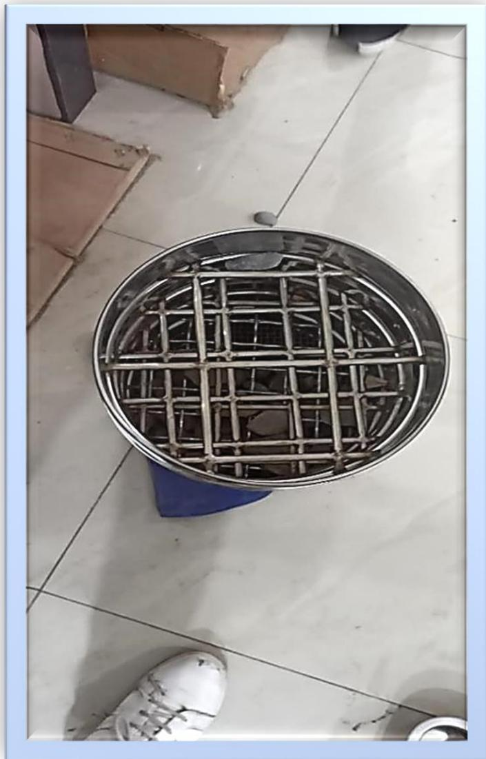
Figura 40 Tamiz granulométrico
