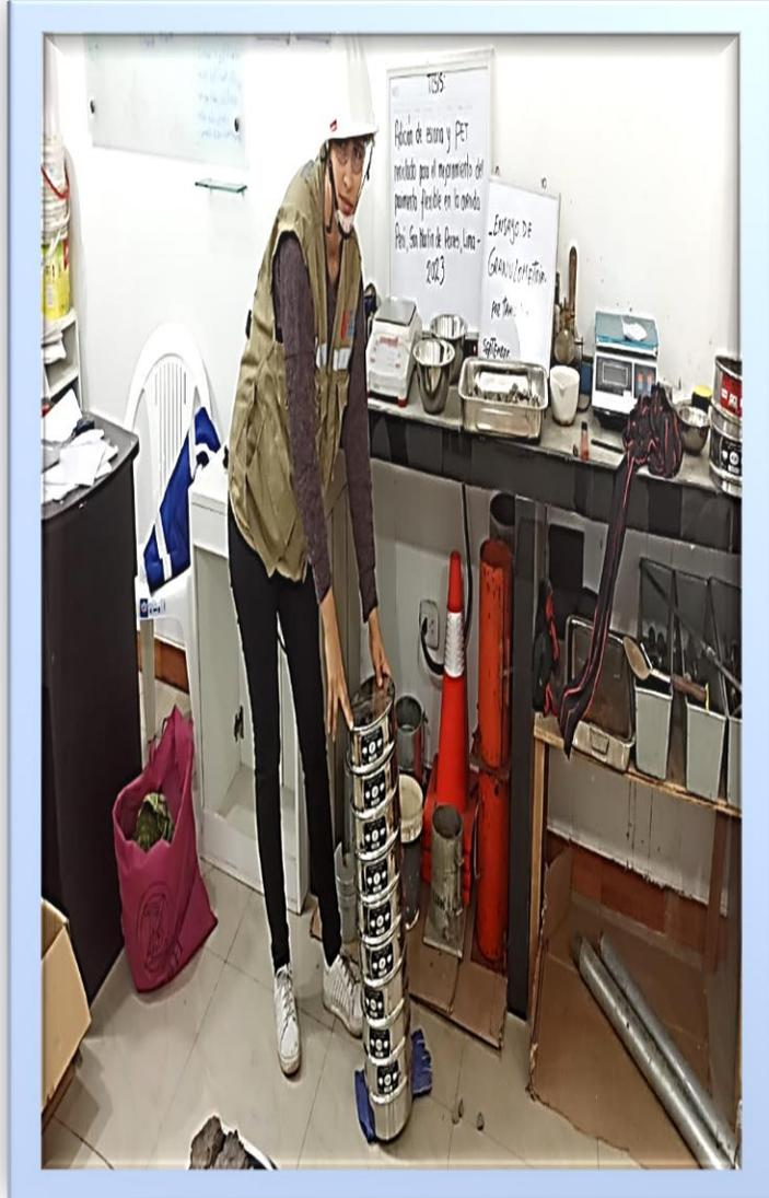
**Figura 42**                      **Ensayo de granulometría**
