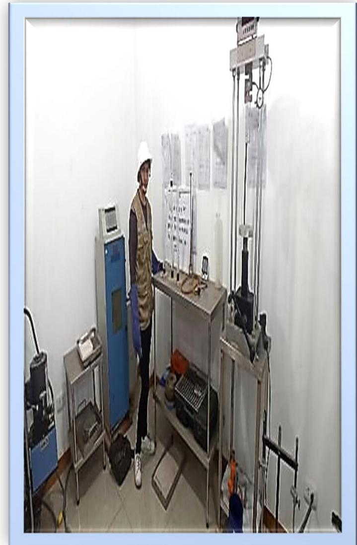
**Figura 53** Ensayo de equivalente de arena.
