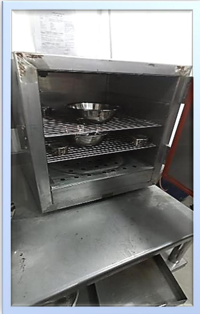
**Figura 44** Muestras de agregado fino en horno eléctrico.
