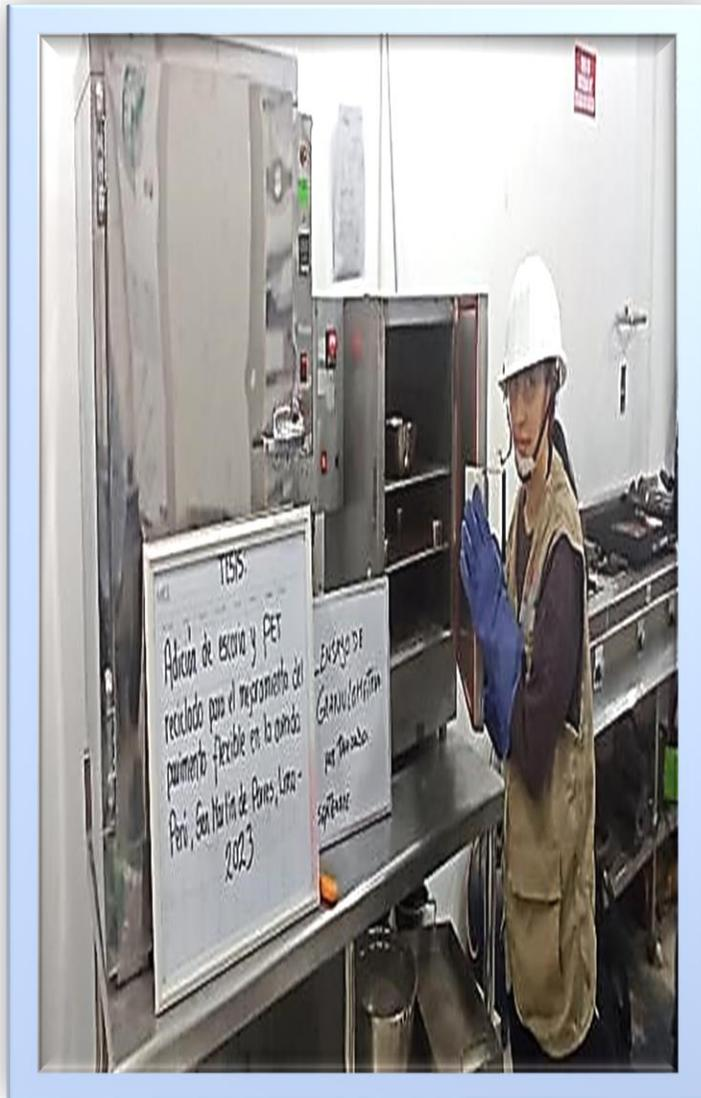
**Figura 46** Ensayo para determinar contenido de humedad mediante el ingreso de material al horno eléctrico.
