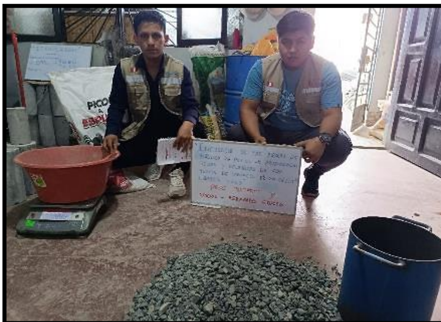
Foto 19: Ensayo de Peso Unitario y Vacíos – Agregado Gueso
