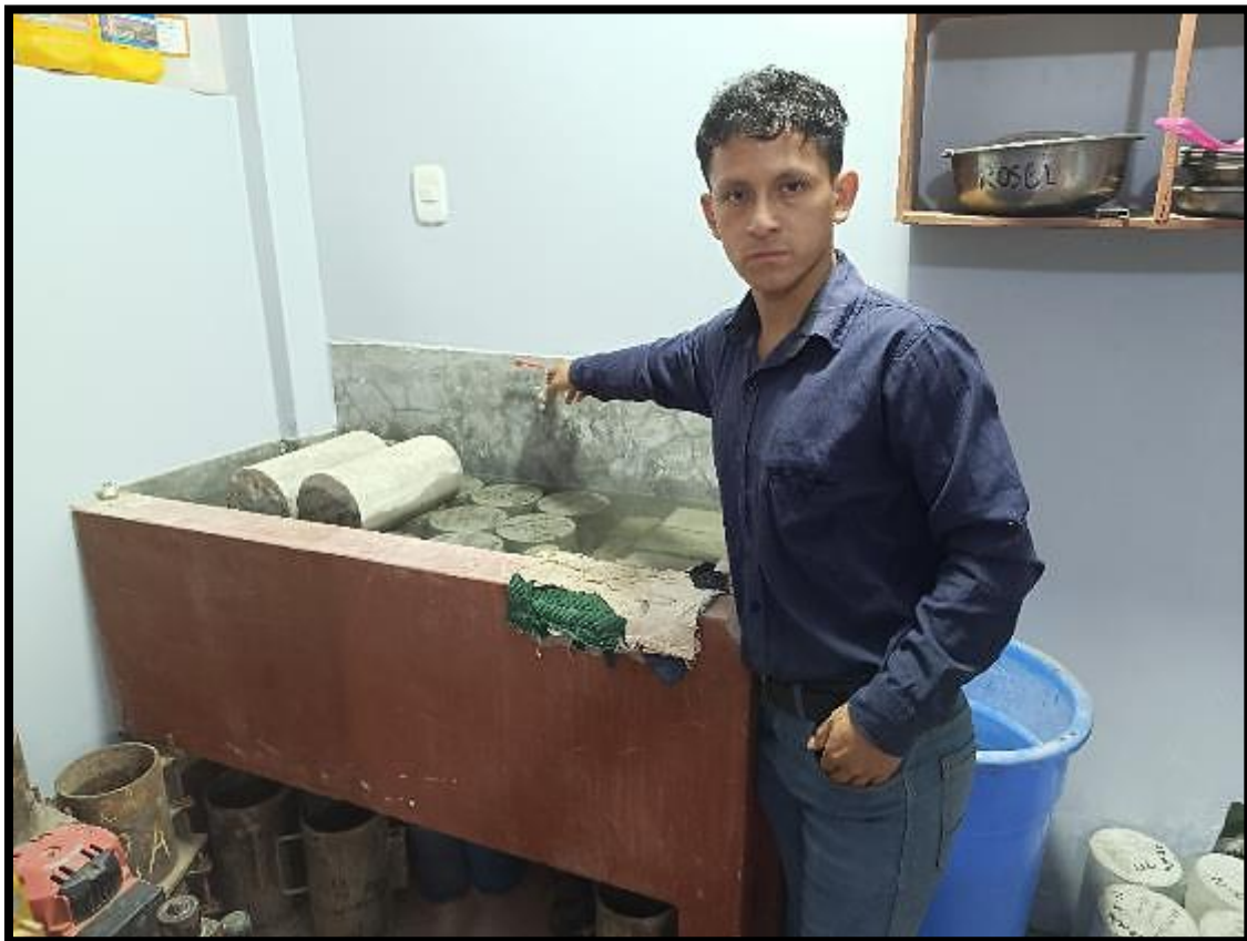
Foto 29: Curado de las muestras de concreto
