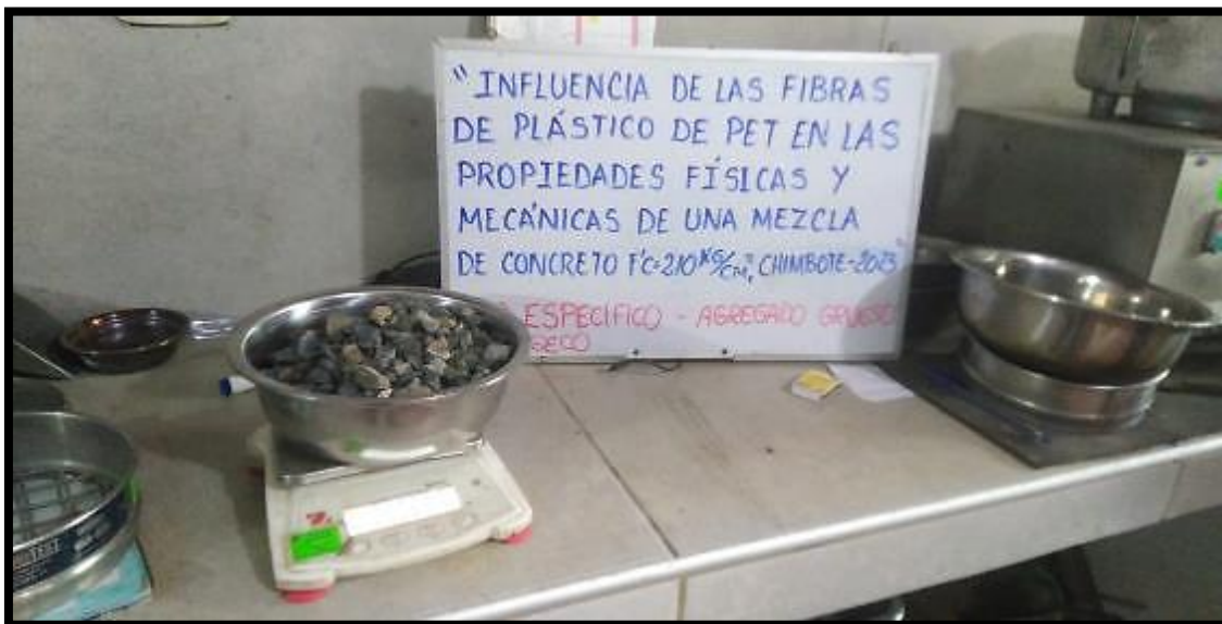
Foto 15 y 16: Ensayo Peso Específico y Absorción del Agregado Grueso
