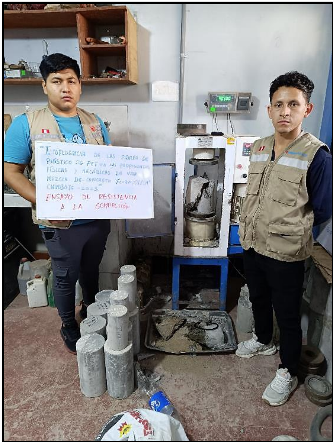
Foto 30: Ensayo de Resistencia a la Compresión
