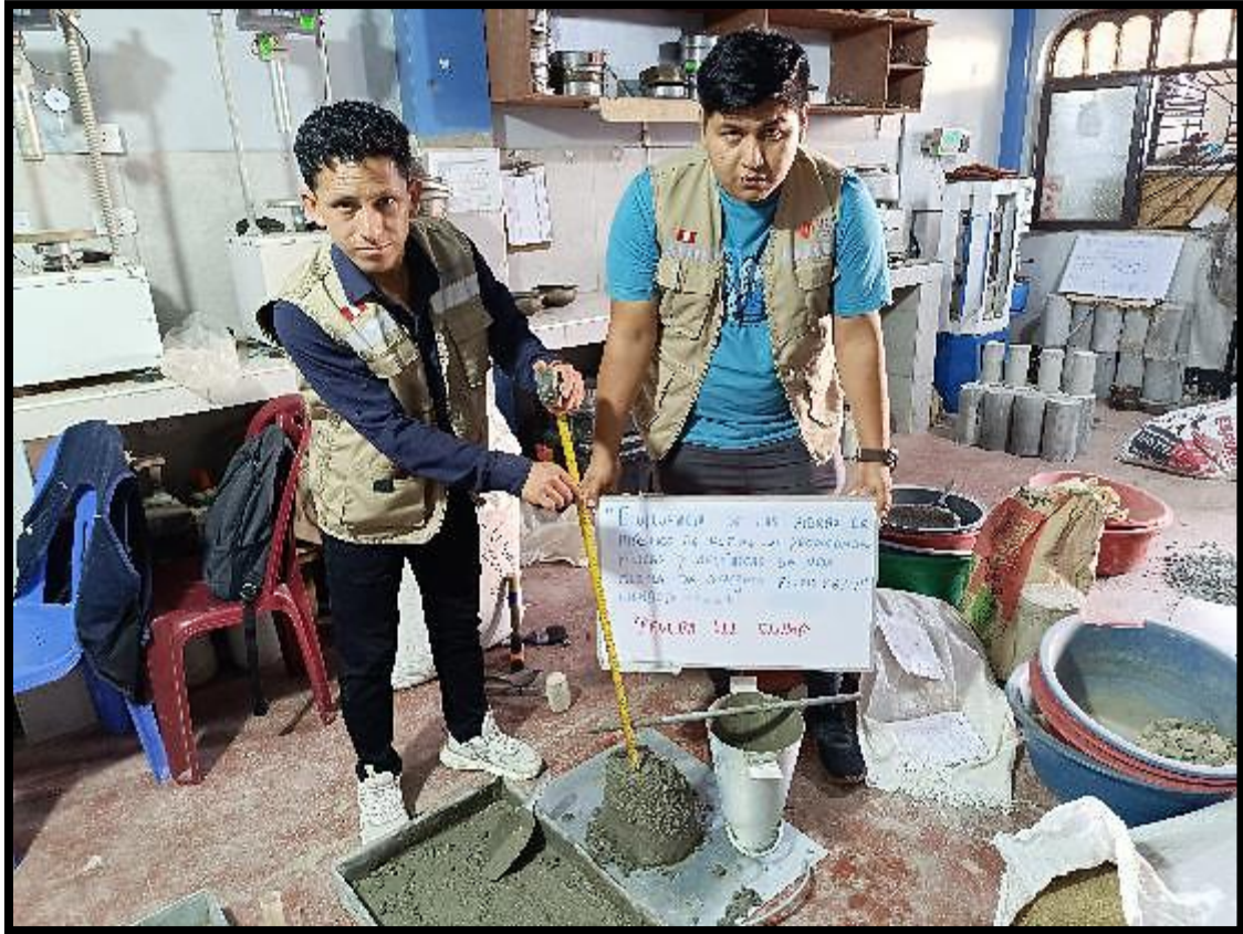
Foto 25: Prueba de Slump
