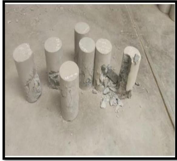
**ENSAYO DE AGREGADO DE CONCRETO CON TECNOLOGÍA DE CAPTURA DE CO2**
