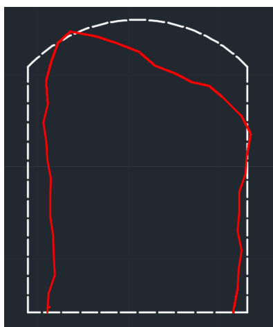
Figura 33. Contorno de la primera voladura del diseño de perforación anterior 1.
