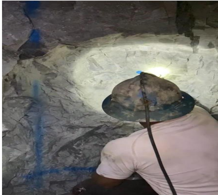
Figura 10. Marcado del punto de referencia del arranque Fuente: Elaboración propia
