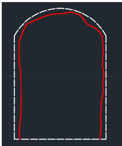
Figura 36. Contorno de la segunda voladura del diseño de perforación propuesto 2. Fuente: elaboración propia.
