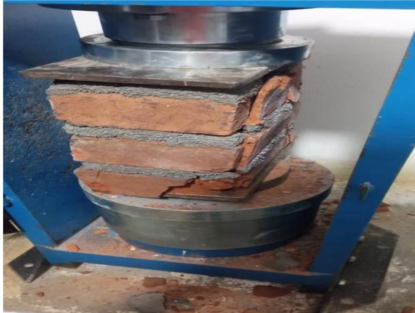
Figura 13. Ensayo de la resistencia a compresión axial en pilas.
