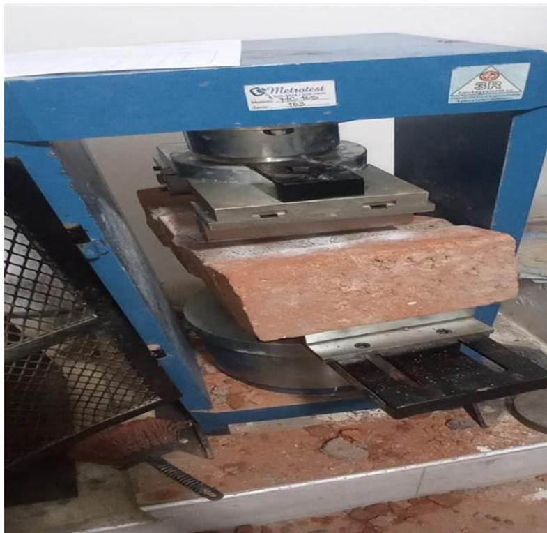
Figura 14. Ensayo de la resistencia a flexión en pilas.
