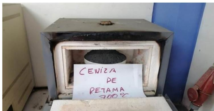
Figura 9. Calcinación de las cenizas de la retama
