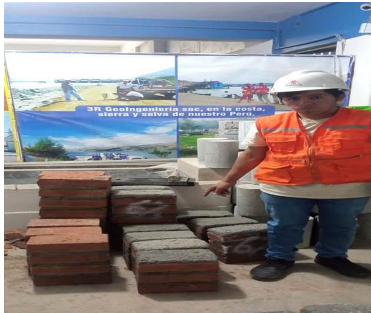
Figura 11. Elaboración de pilas con ladrillos artesanales
