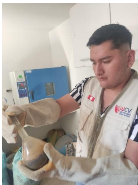
Foto 01. Tesista haciendo el ensayo de absorción del agregado fino.
