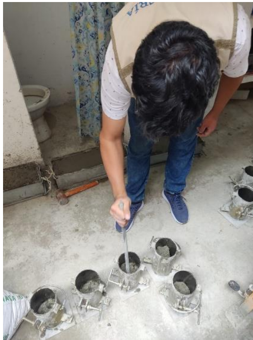
Foto 05. Tesista chuceando 25 veces a la mezcla que se encuentra en la probeta
