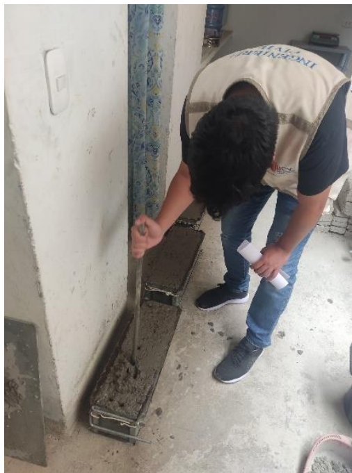
Foto 06. Tesista chuceando 25 veces a la mezcla que se encuentra en la viga
