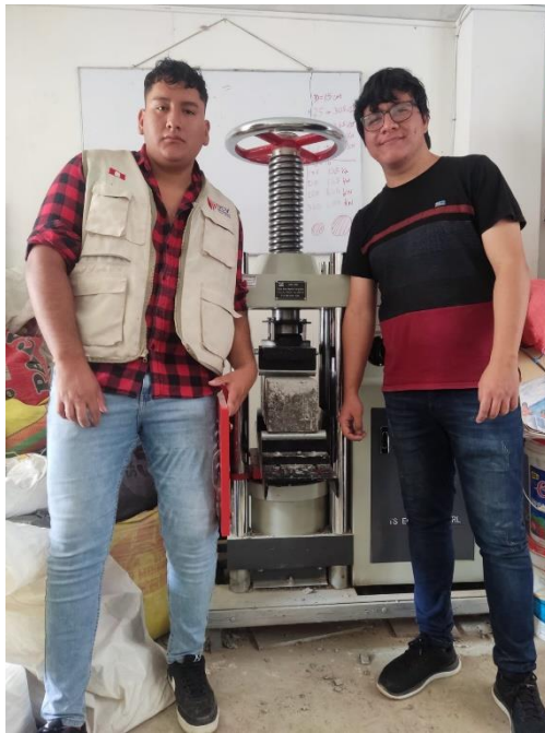
Foto 08. Tesistas en el ensayo a la flexión para vigas.
