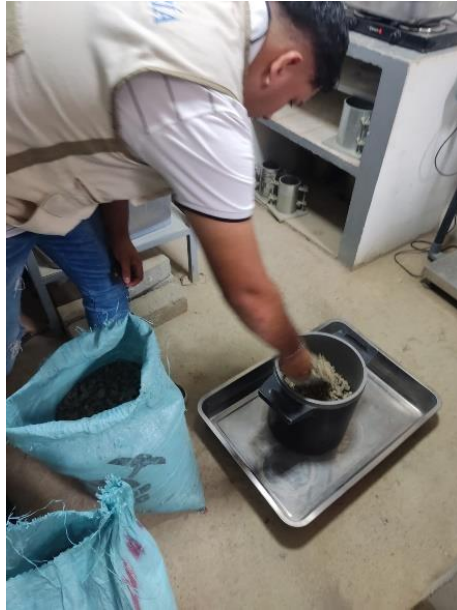
Foto 03. Tesista echando el agregado grueso para ensayo de peso unitario
