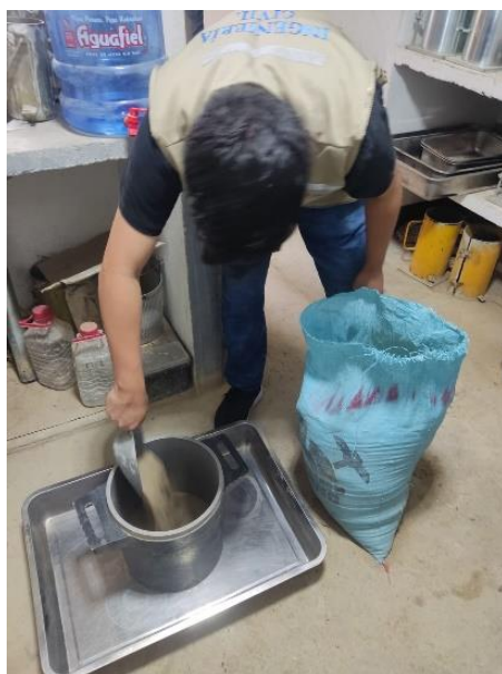
Foto 02. Echando el agregado fino al recipiente para el ensayo de peso unitario.
