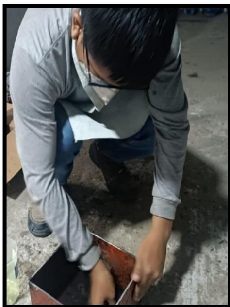
Figura N°10, N°11, N°12, N°13, N°14: La mezcla del plástico derretido fue batida constantemente y se llevó el control de la temperatura de fundición 140°C. Ya fundido en su totalidad, se vierte la mezcla al molde previamente engrasado con aceite.
