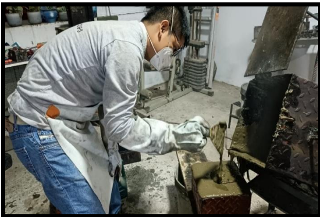
Figura N° 1: Fabricación de ladrillo decorativo pet
