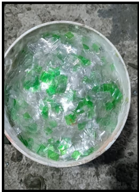
Figura N°06, N°07, N°08, N°09: La fabricación del ladrillo decorativo con tereftalato de polietileno inicia con la recolección de botellas de plástico pet, para luego proceder a la trituration manual del material de 1cm. Luego se funde el plástico en la olla de fundición a 140°C con un porcentaje de aceite.
