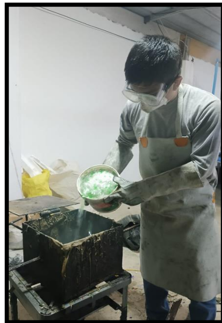
Figura N°06, N°07, N°08, N°09: La fabricación del ladrillo decorativo con tereftalato de polietileno inicia con la recolección de botellas de plástico pet, para luego proceder a la trituration manual del material de 1cm. Luego se funde el plástico en la olla de fundición a 140°C con un porcentaje de aceite.
