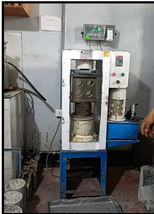
Figura N°5: Ensayo de resistencia a la compresión de los ladrillos
