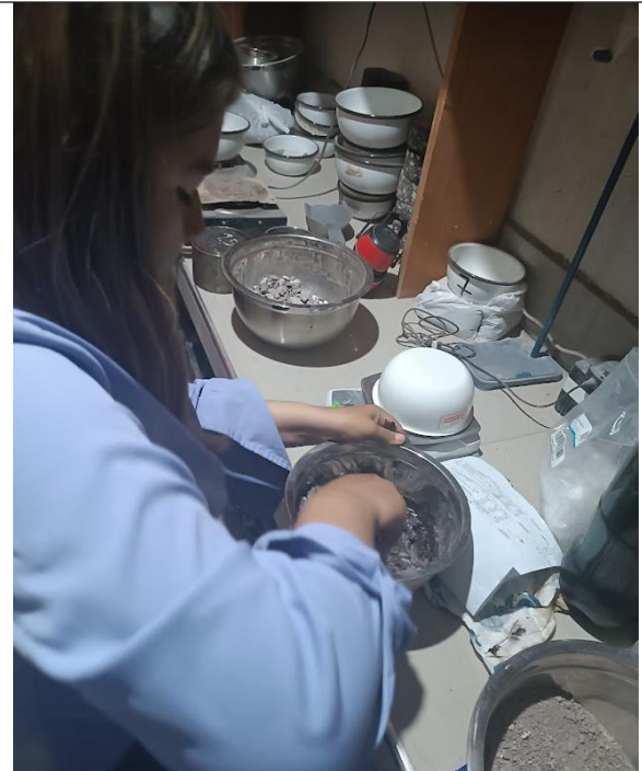
Mezcla de los agregados con el cemento asfaltico y porcentaje de plástico triturado y grafeno
