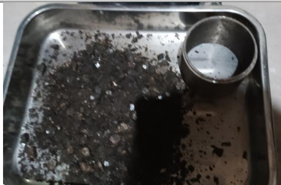
La mezcla con porcentaje de 3% no tubo buena compactacion y se deshiso.
