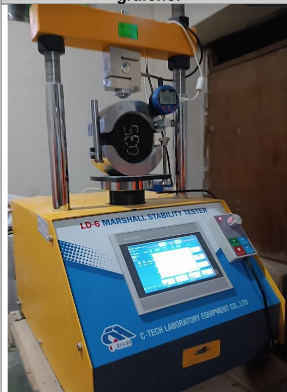
Las pastillas con llevadas a la compresora para su posterior análisis a los resultados obtenidos – 0.35% de grafeno
