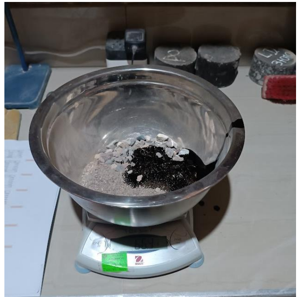
Incorporación de cemento asfáltico según dosificación
