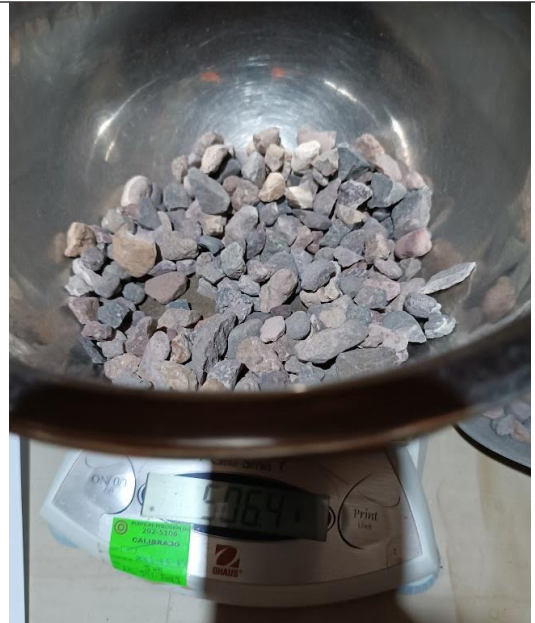
Pesado según dosificación de piedra chancada
