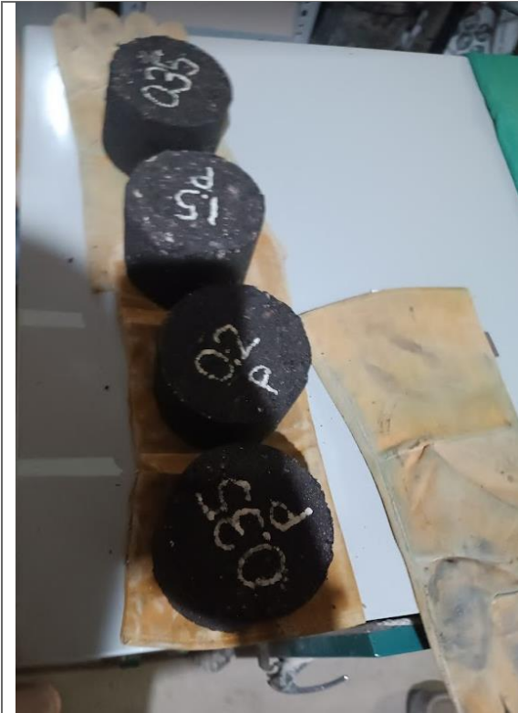
Marcacion de las pastillas según el porcentaje de incorporacion de grafeno.
