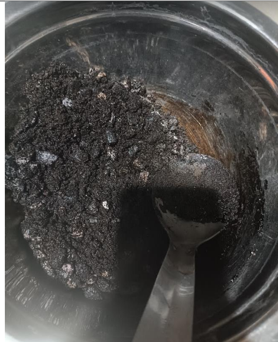
Elaboracion de la mecla asfaltica con incorporacion de pet y grafeno
