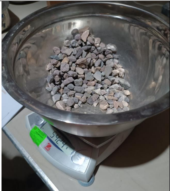
Incorporación de arena gruesa según dosificación
