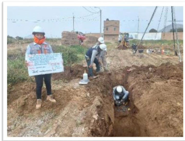
Figura 36: realizando la densidad de campo por el método de cono de arena.
