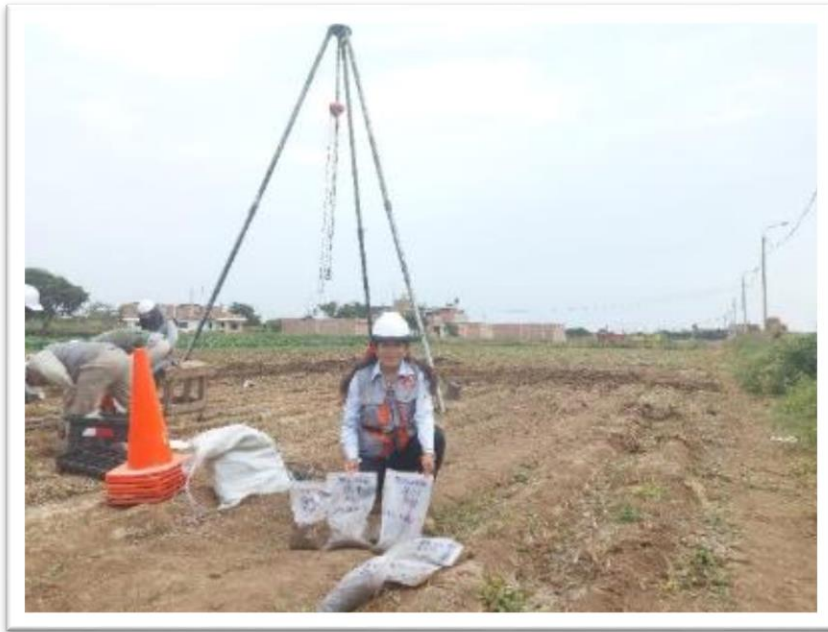
Figura 37: muestras extraídas de SPT.
