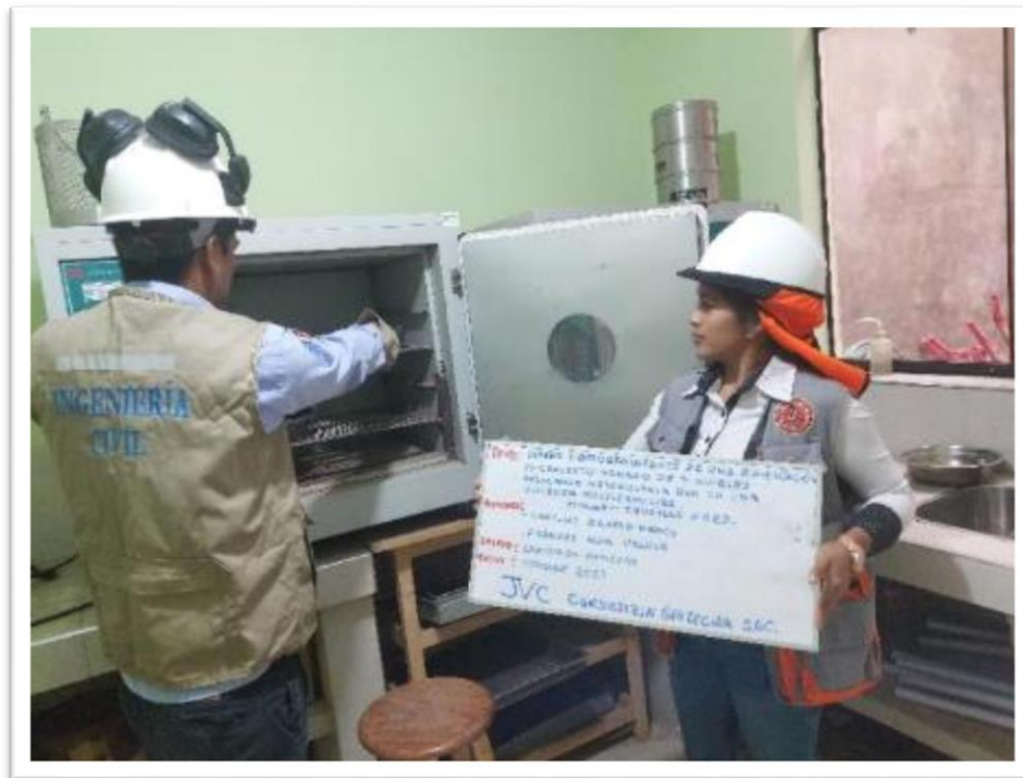
Figura 39: realizando el ensayo de contenido de humedad
