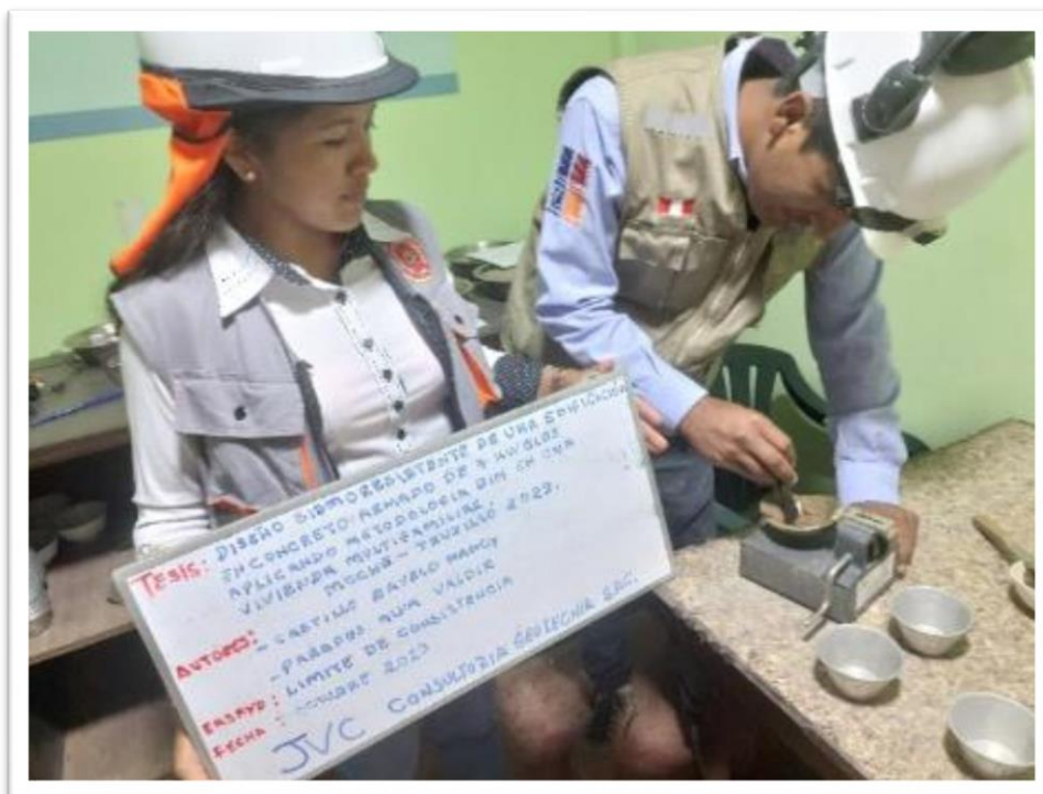
Figura 39: realizando el ensayo de contenido de humedad
