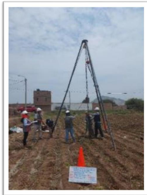
Figura 32: iniciando con el proceso y registrando la cantidad de golpes para una distancia de 45 cm, en 3 tiempos para obtener cada estrato.
