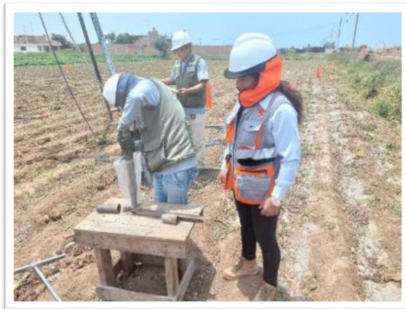
Figura 34: colocación de la muestra en una bolsa plástica para su posterior llevado al laboratorio.
