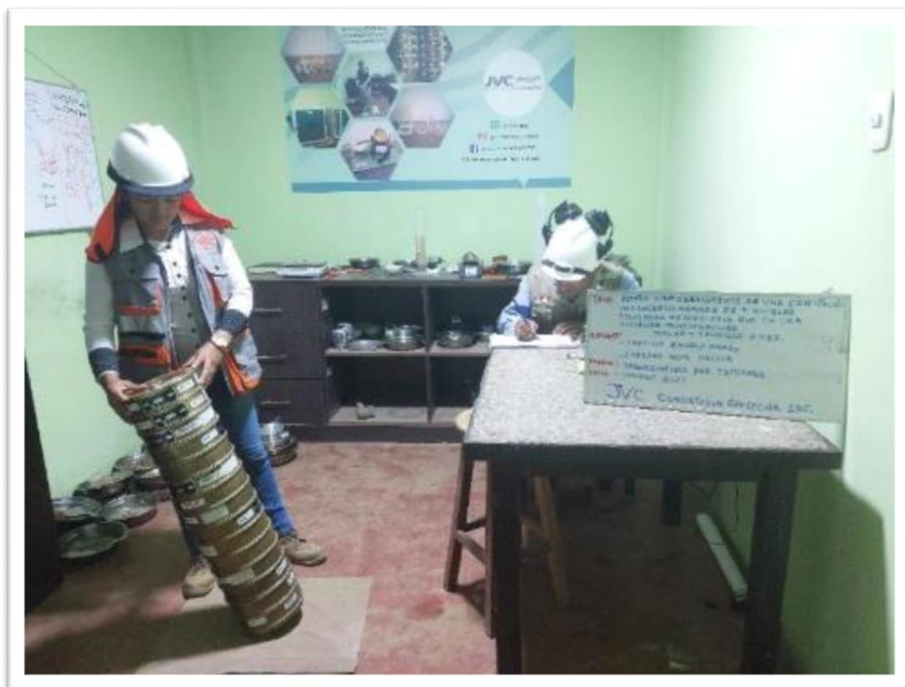
Figura 44: realizando el ensayo granulométrico por tamizado
