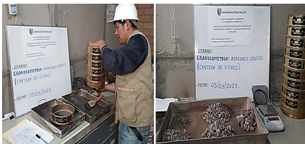
Figura 46. Test de Granulometría – Agregado Grueso
