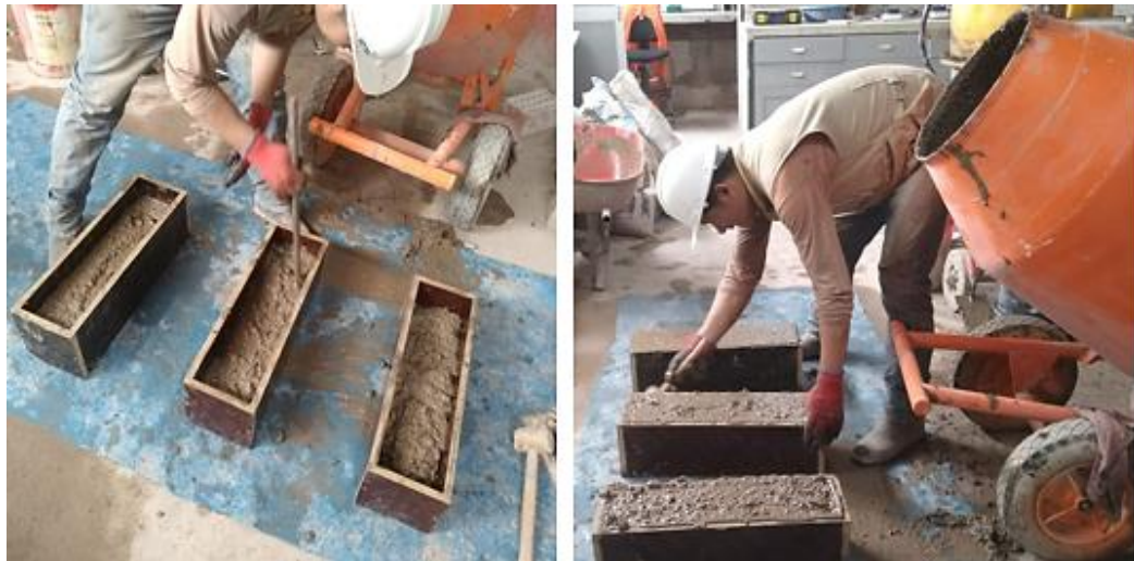
Figura 60. Elaboración de vigas prismáticas
