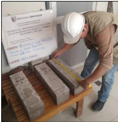
FIGURA 45: Medición y trazado de líneas en los tercios de las vigas prisma
