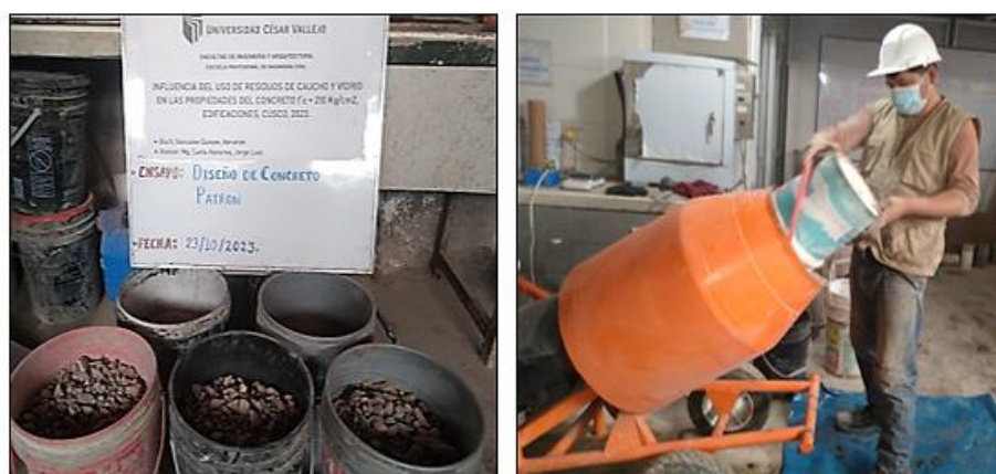
Figura 49. Diseño del concreto patrón (C - 1)
