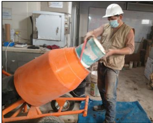
FIRURA 21: Preparado de concreto
