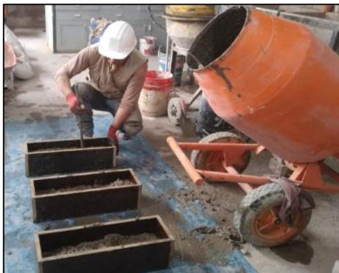
FIGURA 27: Llenado y varillado de vigas prisma
