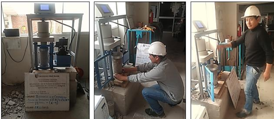
Figura 66. Ejecución del ensayo a la compresión del concreto
