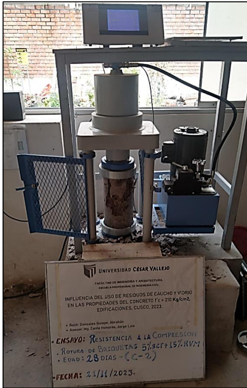
FIGURA 50: Ensayo a la compresión del concreto
