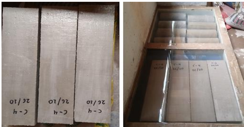
Figura 61. Desmoldado y curado de viga prisma
