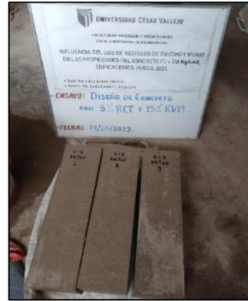
FIGURA 33: Desmoldado de vigas prisma
