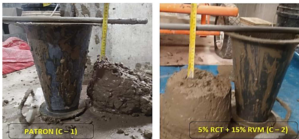
Figura 55. Grado de fluidez de los concretos C - 1 y C - 2
