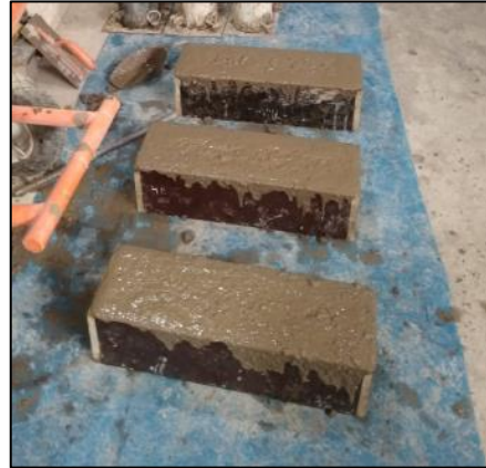
FIGURA 32: Vigas prisma en estado fresco
