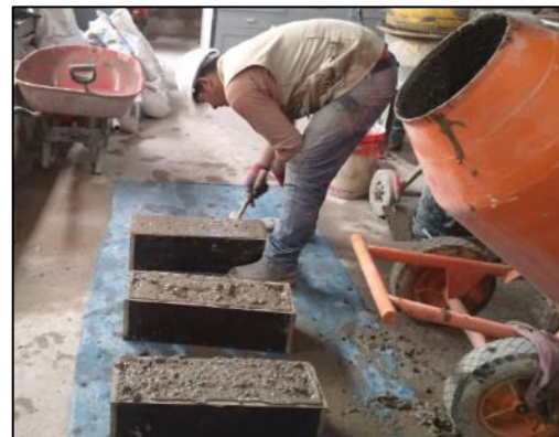
FIGURA 28: Llenado y golpeteo de vigas prisma
