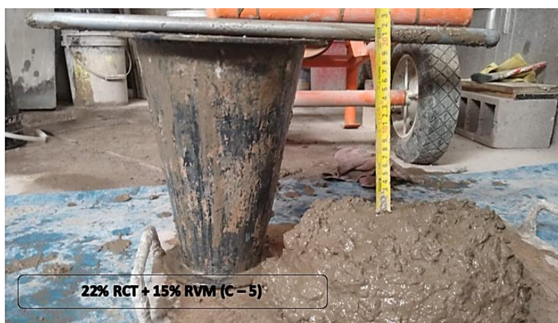
Figura 57. Grado de fluidez del concreto C - 5
