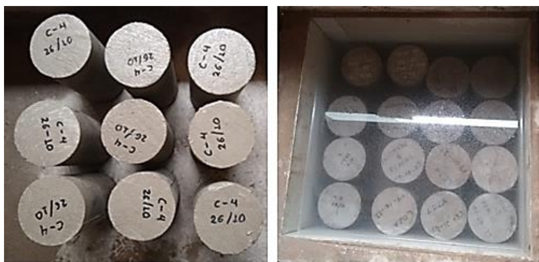
Figura 59. Desmoldado y curado de especímenes cilíndricos
