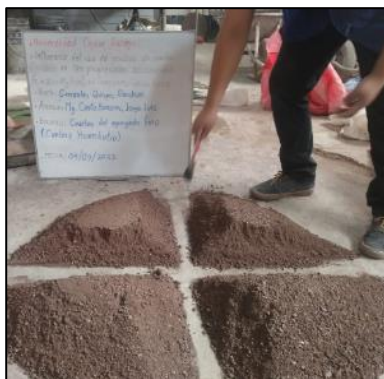
FIGURA 11: Proceso de cuarteo del agregado fino – cantera de Huambutio
