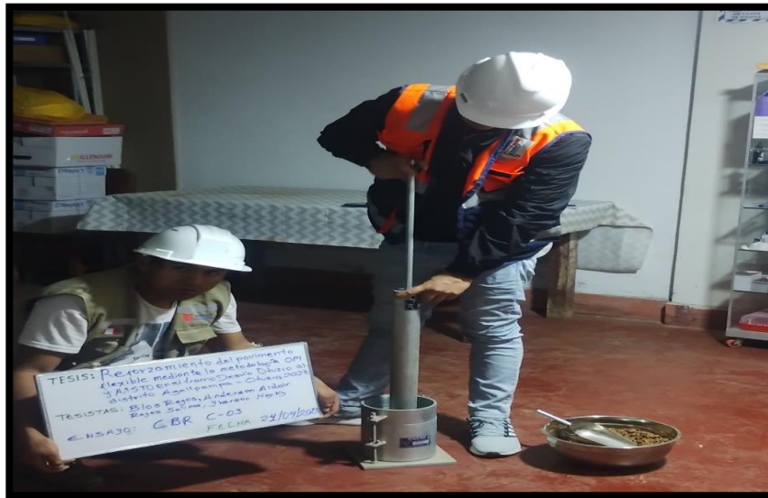
Fotografía 11: Se muestra la compactación de los especímenes pasantes para obtener los pesos unitarios deseados realizando en el primer molde 12 golpes por capa, segundo molde 26 por capa y finalmente 55 golpes por golpe para ver la relación de soporte de humedad y densidad.
