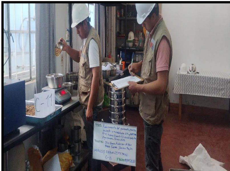
Fotografía 8: Se muestra la determinación cuantitativa de la distribución de tamaños de partículas del suelo.
