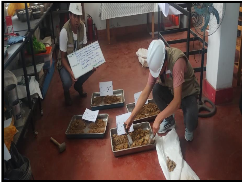
Fotografía 7: Se observa la realización del cuarteo con el propósito de obtener porciones representativas de tamaño proporcional para efectuar las pruebas pertinentes.
