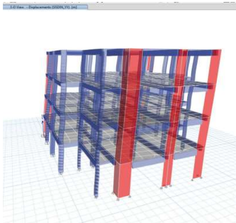
Figura 6. Desplazamiento Sísmico Dinámico en el Eje Y (m)
