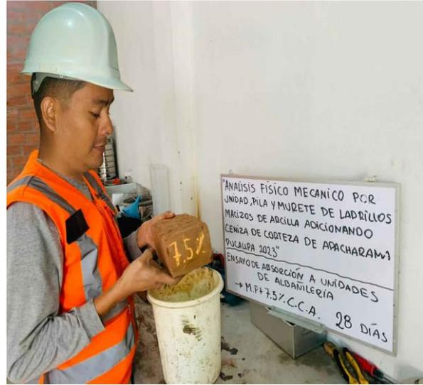
Figura 6: Foto de ensayo de Absorción
