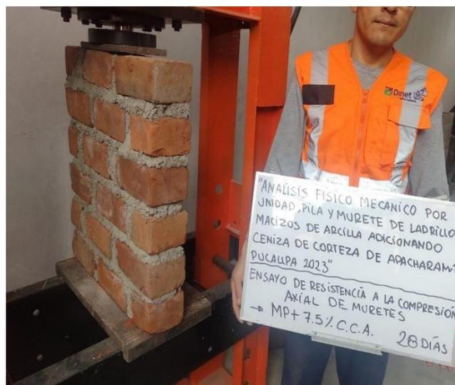
Figura 16: Foto de ensayo de resistencia a la compresión axial de muretes
