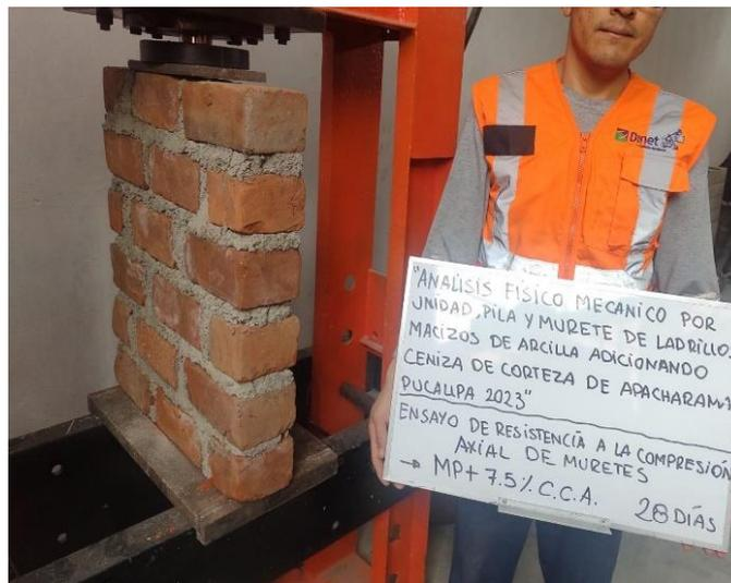
Figura 23: Foto de ensayo de resistencia a la compresión axial de muretes
