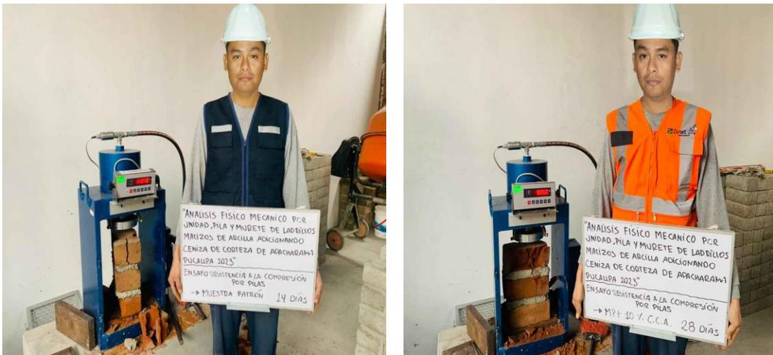
Figura 21: Foto de ensayo de resistencia a la compresión axial de pilas en ladrillos
