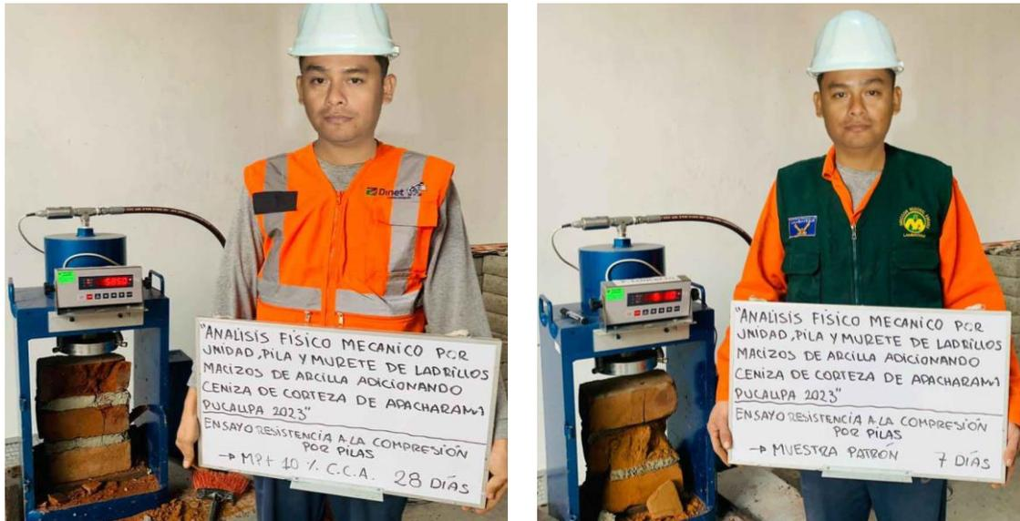
Figura 13: Foto de ensayo de resistencia a la compresión axial de pilas
