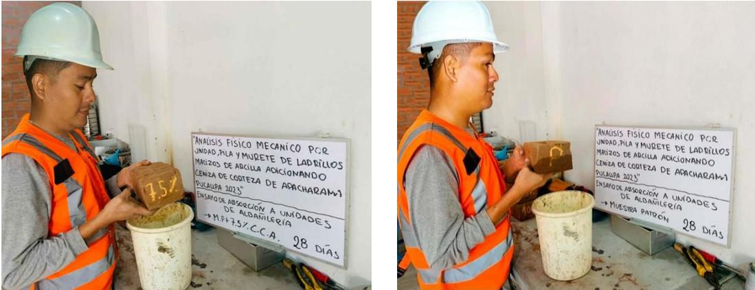
Figura 19: Foto de Ensayo de absorción
