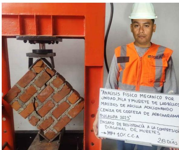
Figura 15: Foto de ensayos de resistencias a la compresión diagonal de muretes
