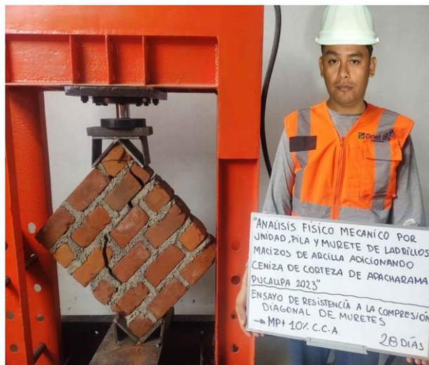
Figura 22: Foto de ensayo de resistencia a la compresión diagonal de muretes
