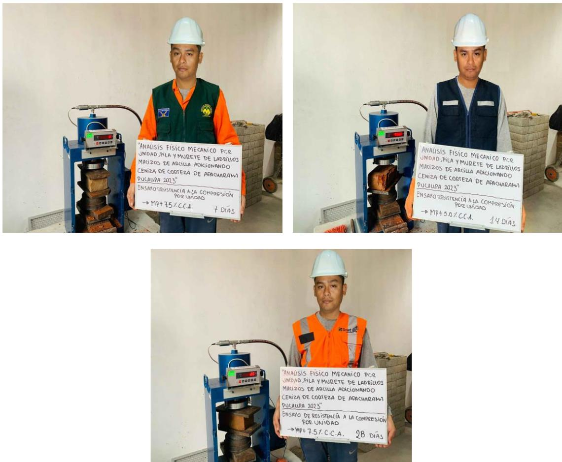
Figura 20: Foto de resistencia a la compresión axial de unidades de ladrillo
