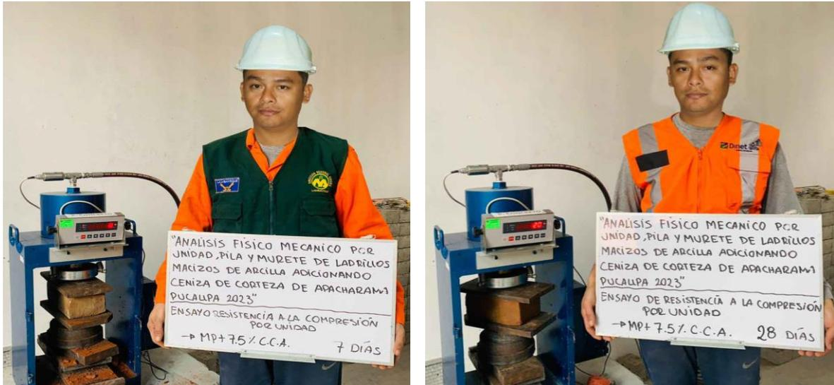
Figura 10: Foto de ensayo de resistencia a la compresión axial de unidades de ladrillos.
