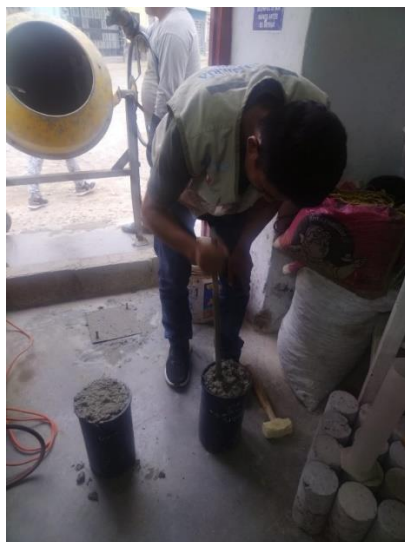
Figura 5. Muestra la preparación de la mezcla de diseño con caucho de neumático triturado
