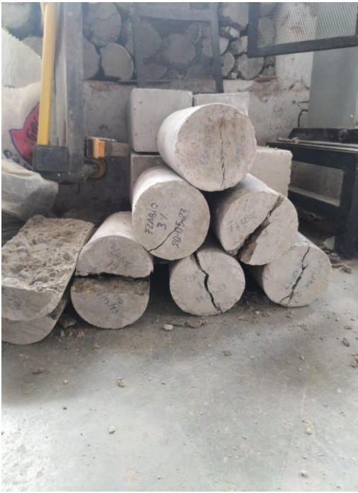
Figura 3. Ensayo a compresión
