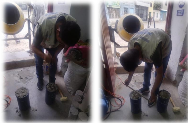
Figura 3. Muestra en vaciado a las probetas
