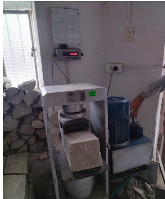
Figura 2. Ensayo a flexión a los 14 días
