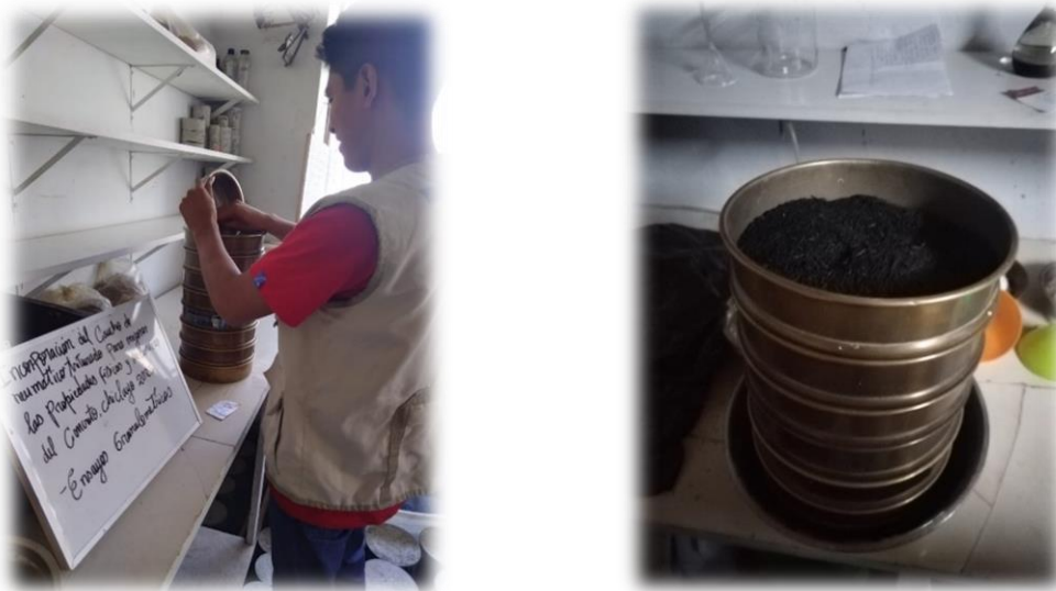
Figura 2. Se muestra el análisis granulométrico del caucho Fuente: elaboración propia
