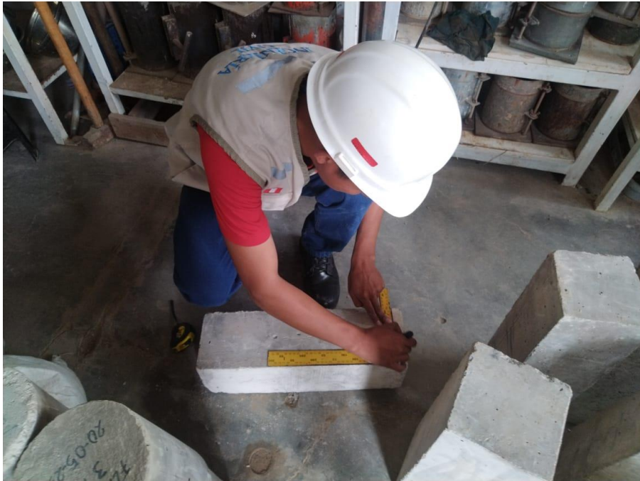
Figura 5. Medición de vigas para prueba de a flexión
