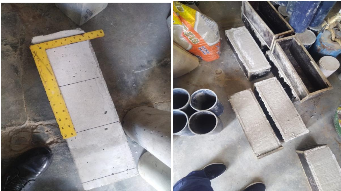
Figura 8. Vigas para ensayos a la flexión
