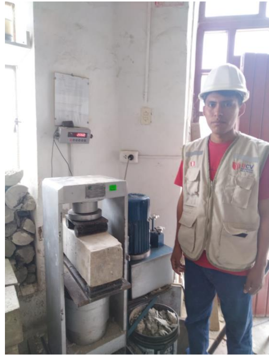
Figura 1. Ensayo a flexión a los 28 días
