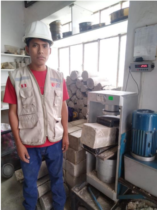
Figura 1. Ensayo a flexión a los 28 días
