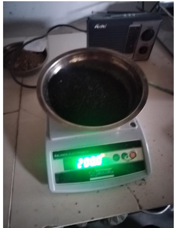
Figura 9. Ensayo granulométrico del caucho
