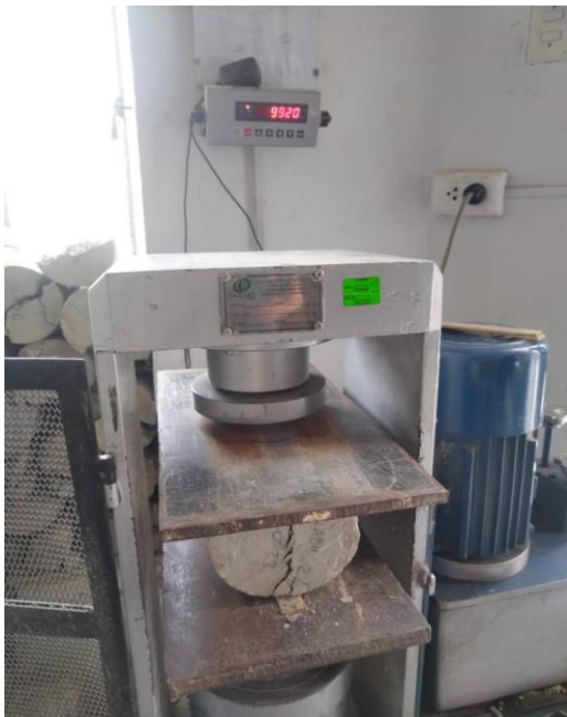
Figura4. Ensayo a tracción
