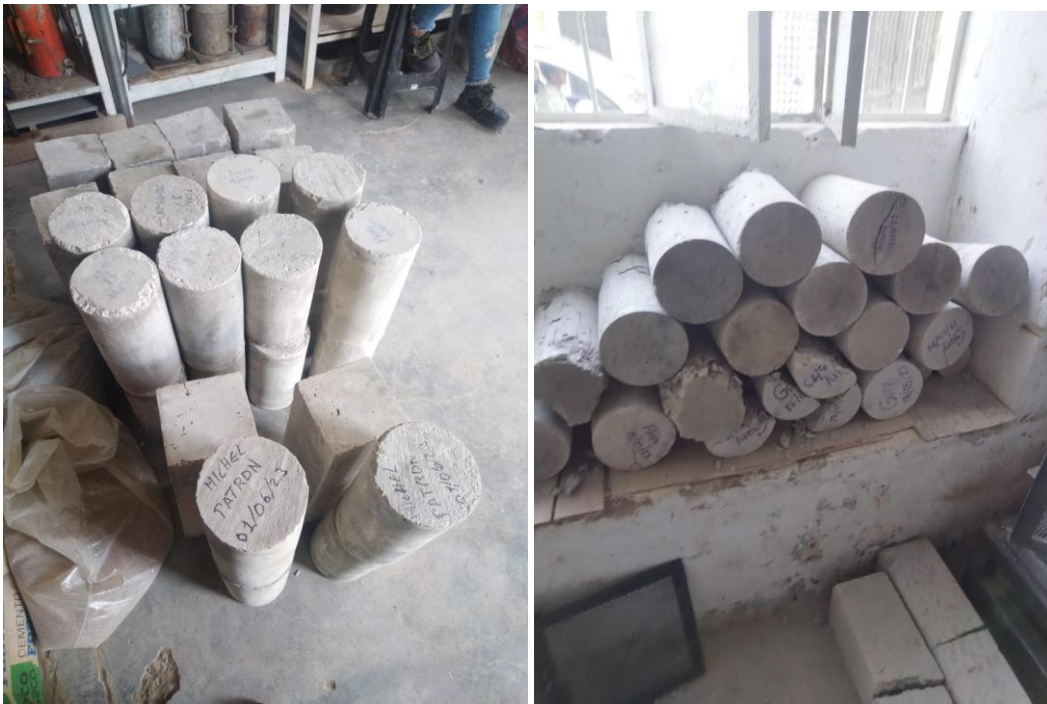
Figura 7. Probetas para ensayo a compresión y tracción
