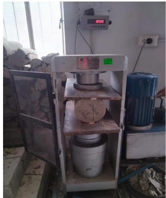
Figura4. Ensayo a tracción
