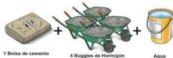
**Figura 6** Agua para el Concreto
