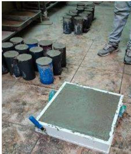
**Figura 29.** Briquetas y losa en molde.
