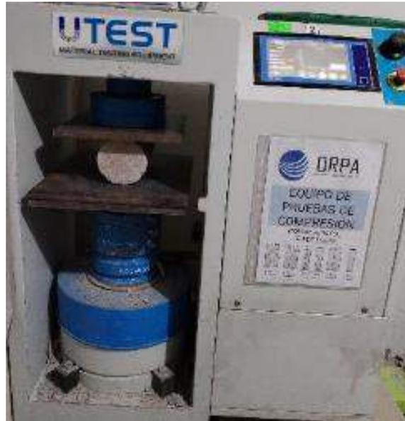
**Figura 34.** Briquetas en ensayo de tracción.
