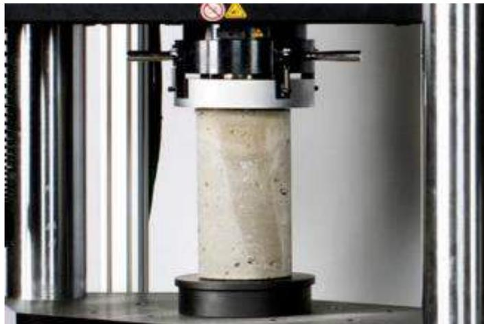
**Figura 10.** *Ensayo de resistencia a la compresión*
