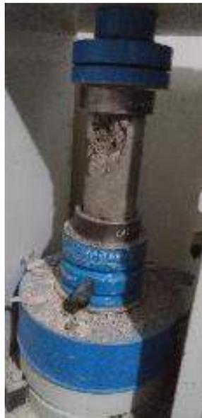
*Figura 38. Briquetas en ensayo de compresión.*
