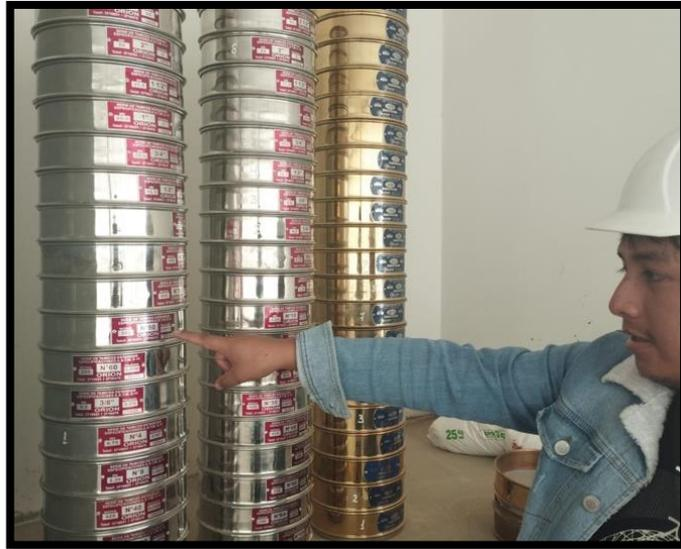
*Figura 13.* Tamizado de las cenizas en laboratorio.
