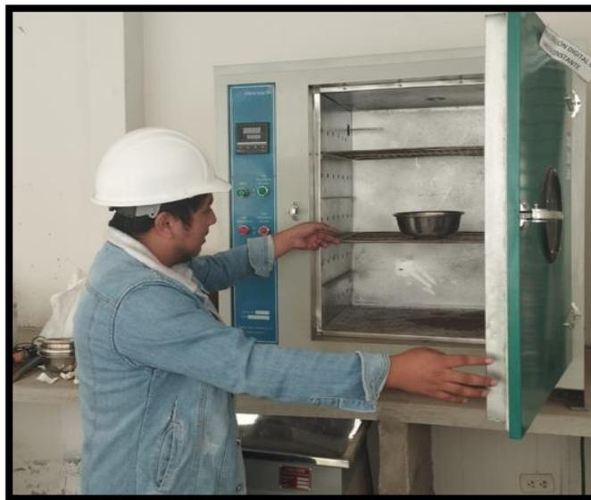
*Figura 14.* Muestra colocada en mufla para su activación.
