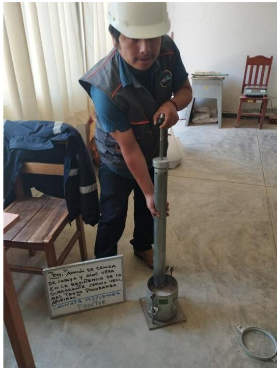
PROCTOR MODIFICADO CON LA ADICION DE CENIZAS EN C-02
