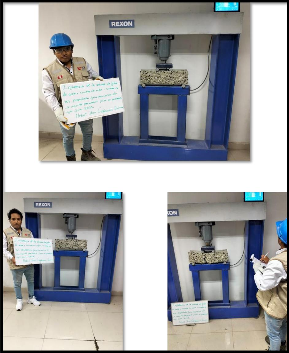
En las fotos se muestran el ensayo de resistencia a la flexión de las vigas prismáticas del concreto permeable con la incorporación de 3%-2%, 5%-2%, 7%-2%, 3%-4%, 5%-4%, 7%-4%, 3%-8%, 5%-8% y 7%-8% de fibras de acero y escoria de cobre respectivamente.
