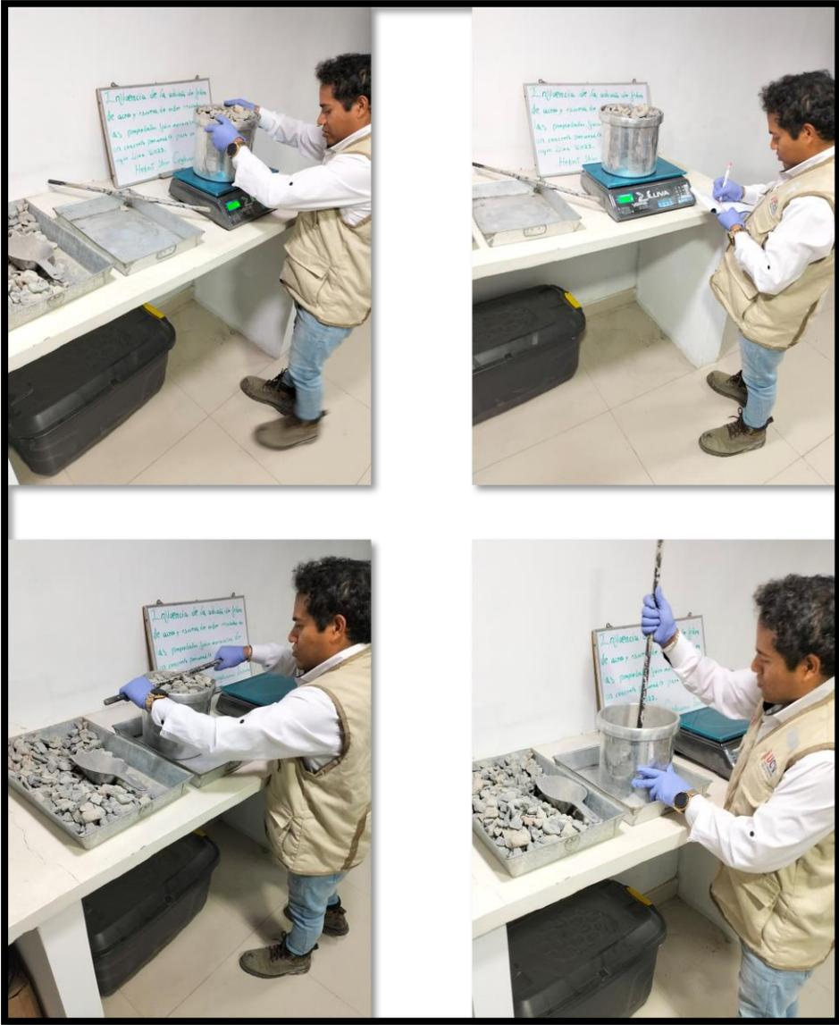
En las fotos se muestran el ensayo de los agregados, en el cual se muestra la densidad de masa suelta y compactada del agregado grueso respectivamente.
