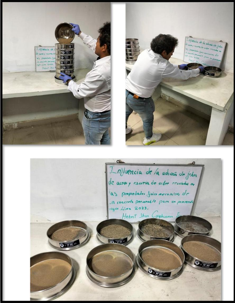
En las fotos se muestran el ensayo de los agregados, en el cual se muestra el tamizado de la arena gruesa respectivamente.
