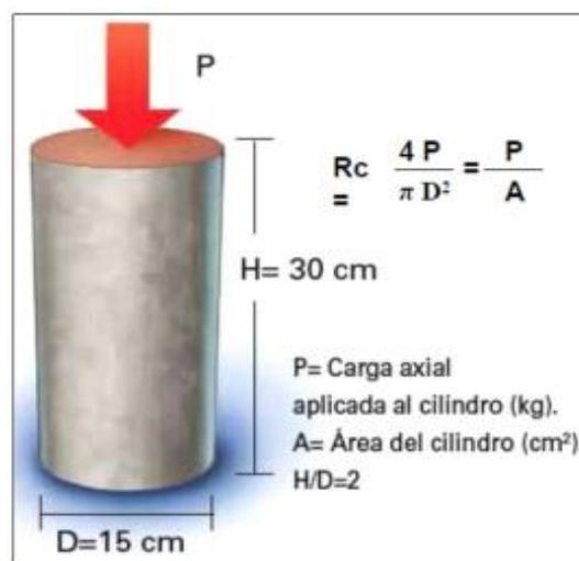
Figura 8. Ensayo de compresión a probetas cilíndricas
