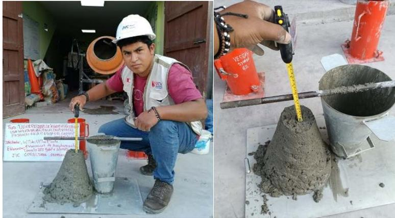
FOTO 13. Diseño de mezcla en estado de asentamiento (NTP 339.035)
