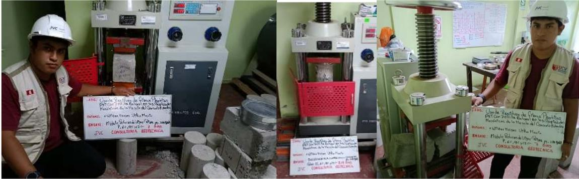
FOTO 17. Rotura de ensayos cilíndricos vigas de 7, 14, 28 Días
