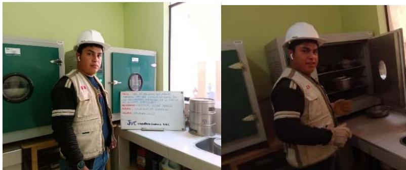
FOTO 06. Secado en horno el agregado grueso (contenido de humedad)
