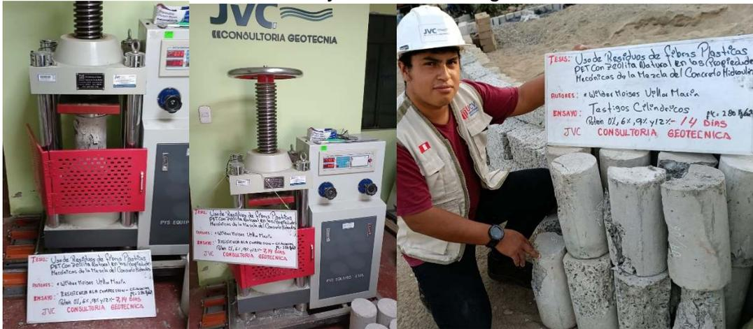
Figura N.18. fuerza de compresión con fibra y zeolita de 7, 14, 28 Días
