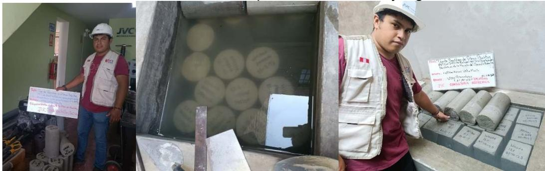
FOTO 15. curado de vigas y cilindros con fibras plásticas PET con zeolita natural
