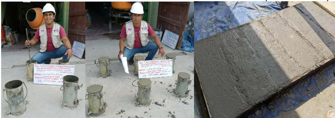
FOTO 14. Llenando de concreto patrón en cilindros y vigas encofradas.
