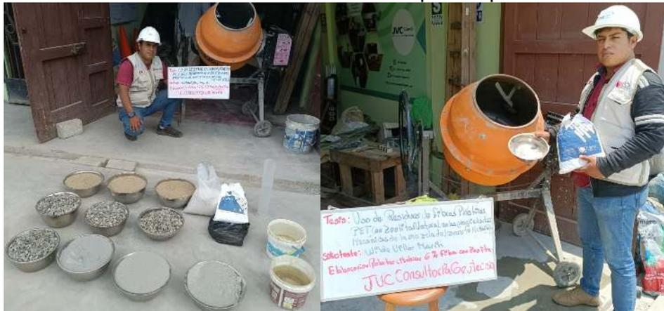
Figura 12. Mezcla de concreto con fibras plásticas PET con zeolita natural
