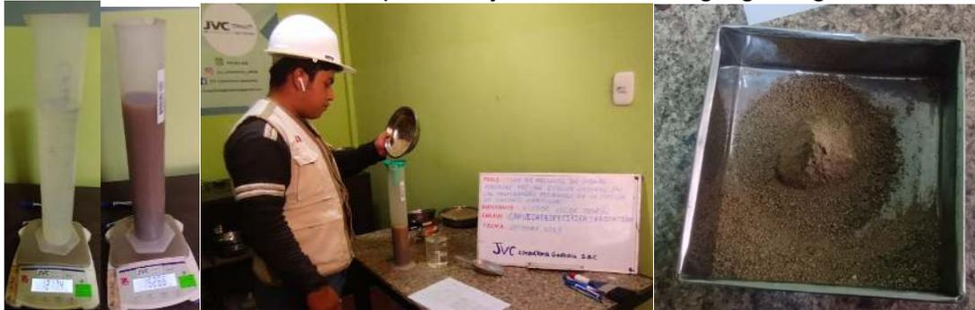
FOTO 10. gravedad específica y absorción de los agregados finos
