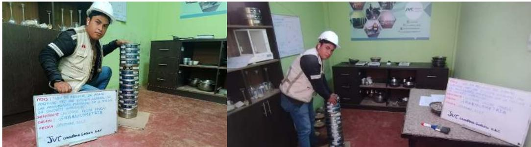
FOTO 03. Granulometría de agregados finos y gruesos NTP 400.012/MTC E204
