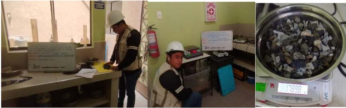
FOTO 09. Gravedad específica y absorción de agregado grueso
