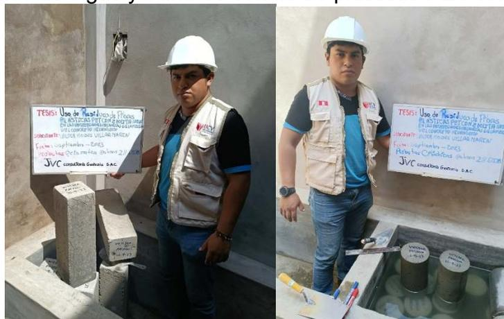
Figura 16. Curado de testigos cilíndricos y vigas prismáticas
