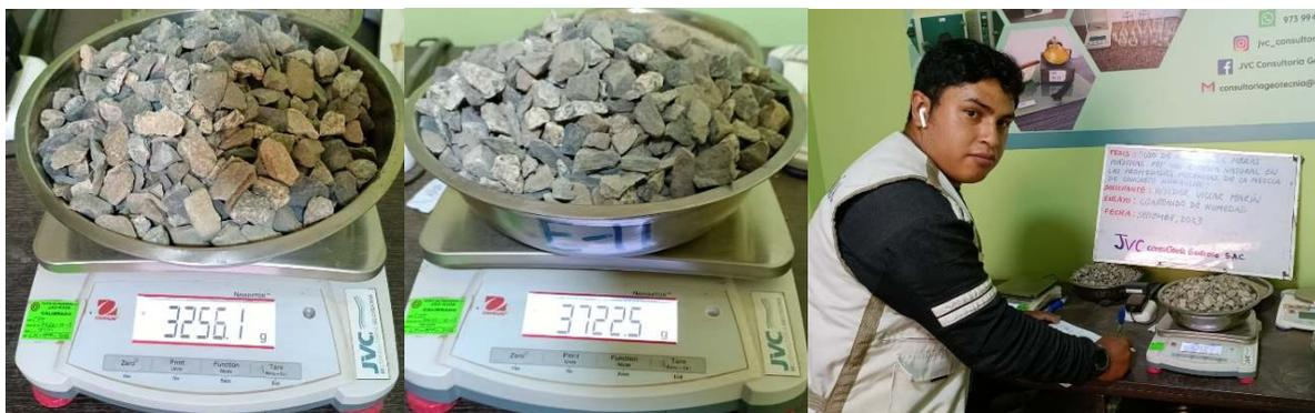
Figura 04. Contenido de humedad del agregado grueso al aire libre
