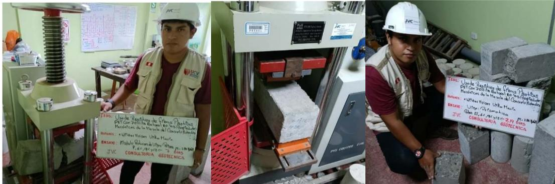
Figura 20. Módulo de rotura de vigas prismáticas de concreto patrón de 7, 14, 28 días.
