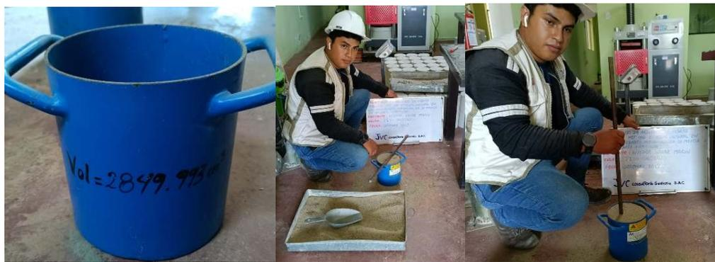
Figura 08. peso unitario suelto y compactado del agregado fino
