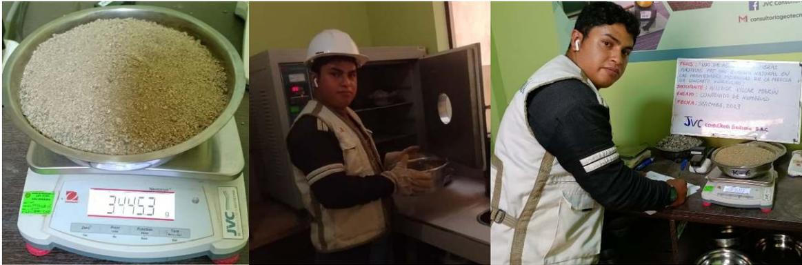
Figura 05. contenido de humedad del agregado fino al aire libre
